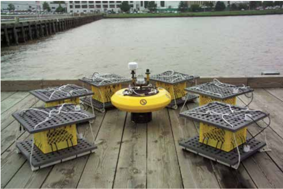
6. ábra: Tengeri meteorológiai bója energiaellátását biztosító üledék-MFC-k
