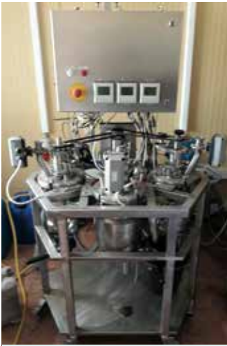
8. ábra: Az SZTE Biotechnológiai Tanszék kísérleti fermentora
