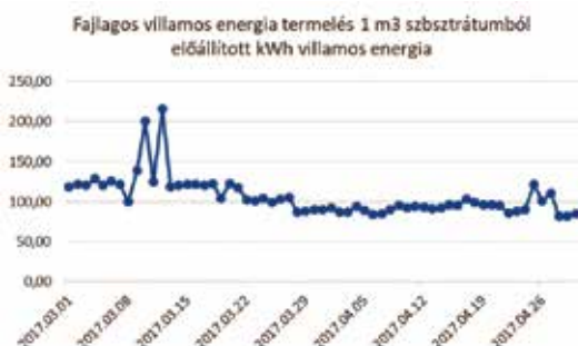
12. ábra: Szennyvíziszap feladást megelőző időszak energia termelés
