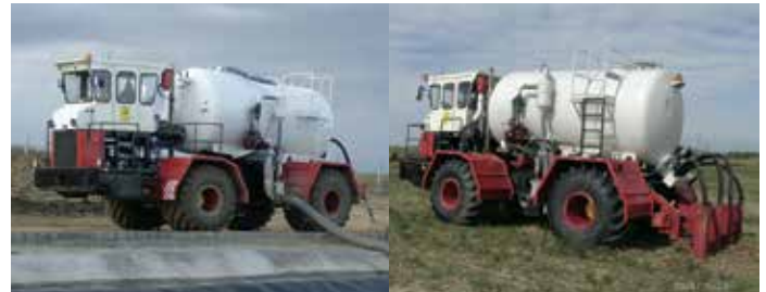
IGM-03 típusú, nagy teljesítményű önjáró injektálógép feltöltés és injektálás közben
