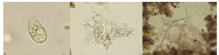
2. kép: (balról jobbra) Csillósok, amóbak és ízeltlábúak elszaporodása a homokszűrőn
