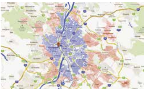
Egyesített rendszerű hálózat (kék színnel), elválasztott rendszerű szennyvízcsatorna (piros színnel)
