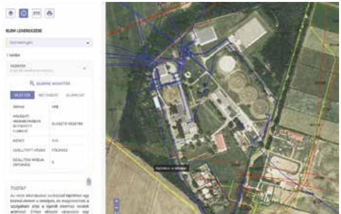
6. ábra: EOv-koordinátás, összközműves térkép a földhivatali alaptérképpel és ortofotóval – szinte túl szép ahhoz, hogy igaz legyen... de igaz!
