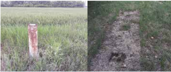
Külvilággal közvetlen kapcsolatban lévő, lezáratlan monitoringkutak (a szerző saját felvétele, 2019)
