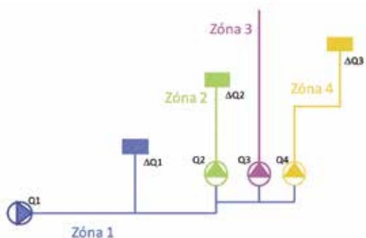
1a. ábra: SCADA zóna vízmérleg adatok értelmezése, kiszámítása
