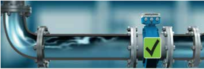
5. ábra: Jelenlegi állapot, megfelelő csőhossz és áramlási kép
