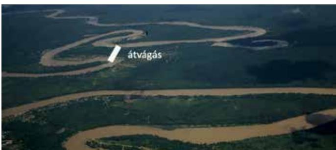
2. ábra: Folyószabályozás a hurkok átvágásával
