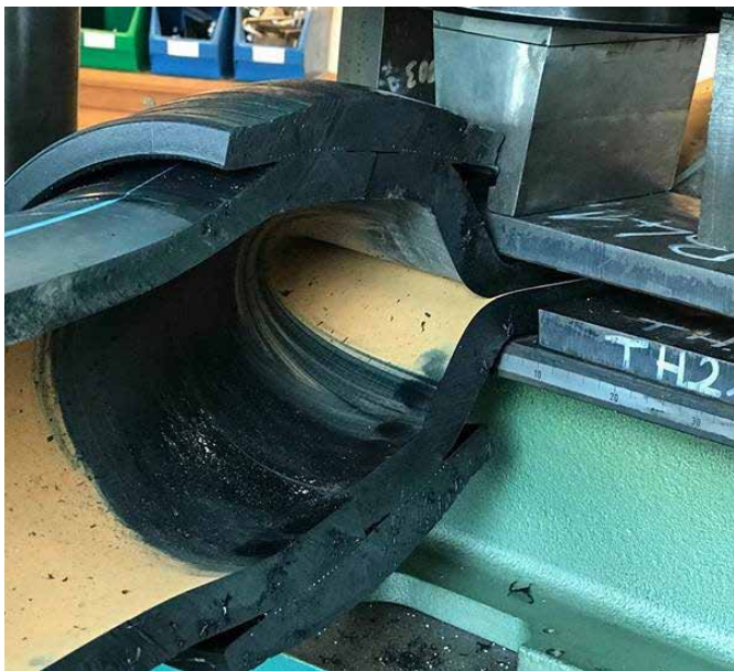
1. ábra: egy jól elkészített kötés szilárdsági vizsgálata
