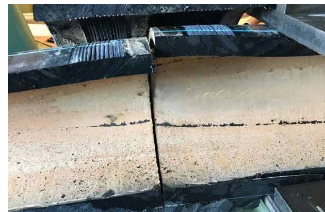
2. ábra: hibásan elkészített hegesztés szilárdsági vizsgálata
