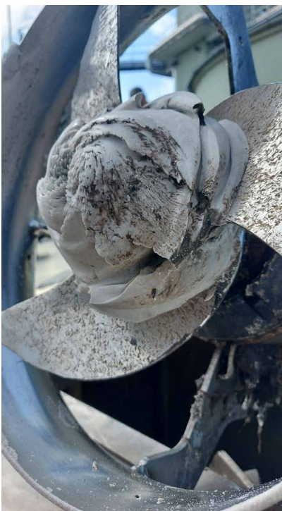
2. ábra: Struvit kiválás járókeréken
