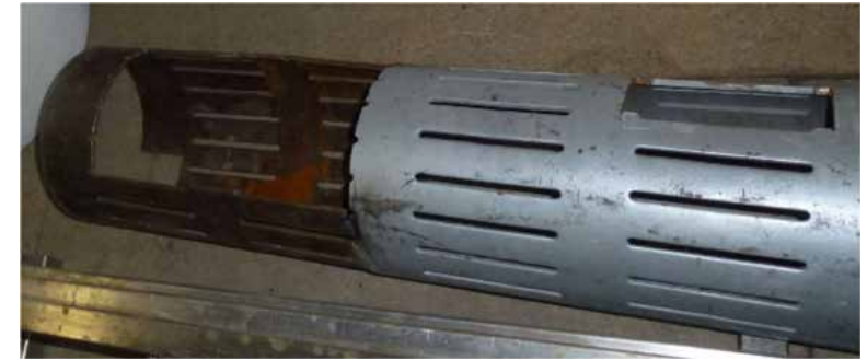
1. fotó: Szénacél csápelem 219 mm átmérővel, 1 méter hosszúsággal
