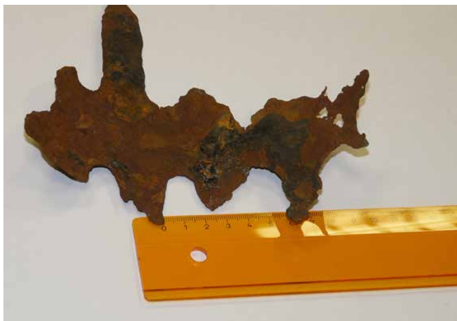
7. fotó: Csápmaradvány harminc év üzemeltetés után
