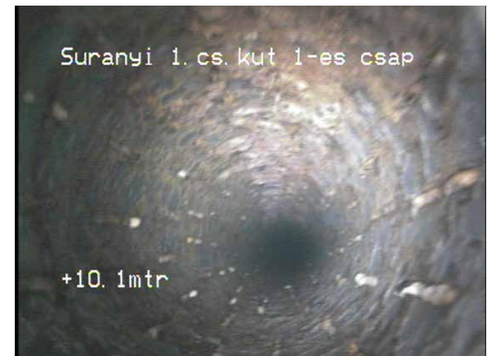
6. fotó: Kamerás csápállapot-vizsgálat
