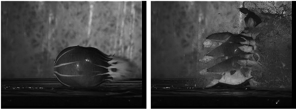
4–5. számú fényképek A lökeshullám keltette nyomás hatása
