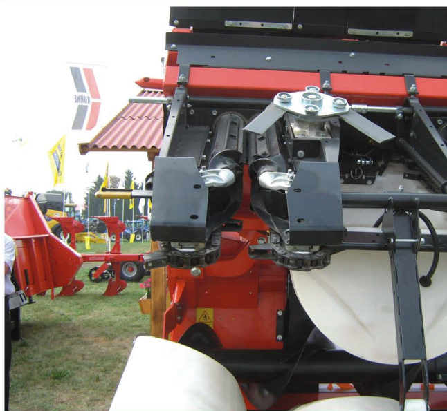
7. ábra: Törőegység a szárzúzóval
