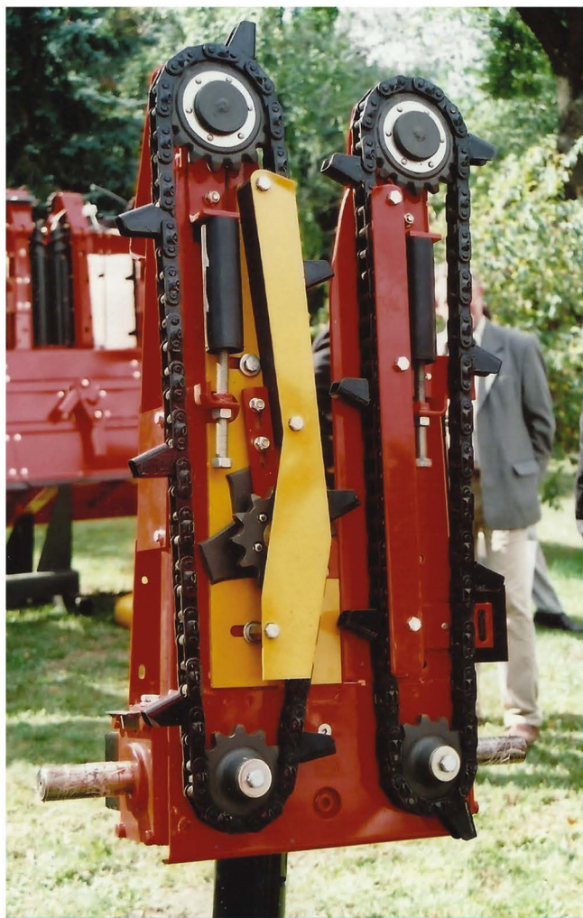
8. ábra: Átalakító készlettel szerelt törőegység
