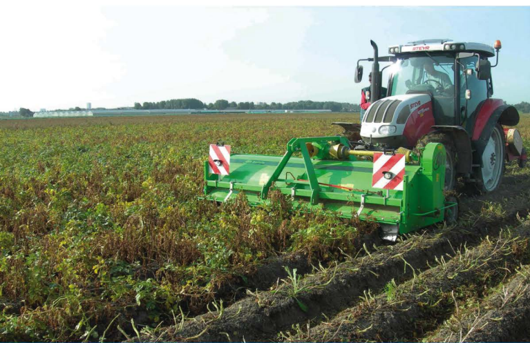
5.kép: AVR Rafale 4x90 burgonyaszár-zúzó munkában
