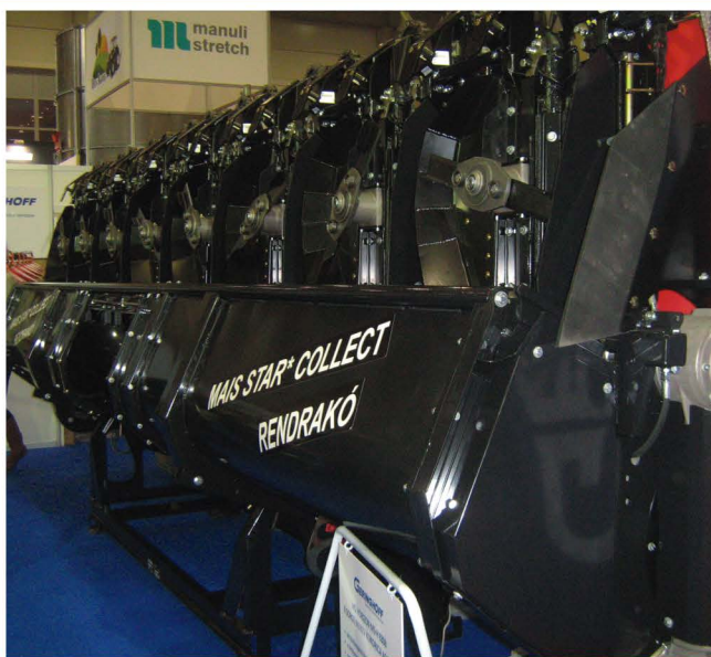
9. ábra: 8 soros rendrakós csőtörő adapter
