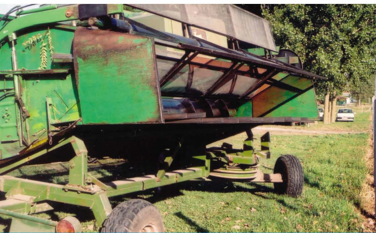
1. ábra: A hagyományos vágóasztalok felszerelhetők napraforgó betakarító kiegészítővel
