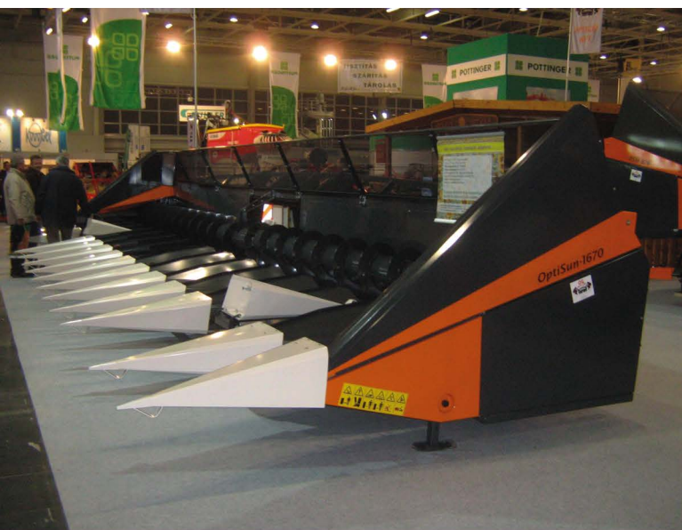
5. ábra: Nagy munkaszélességű 16 soros napraforgó-adapter
