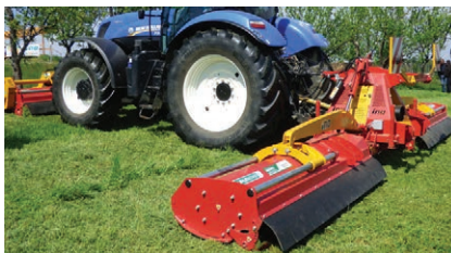
5. kép DUPLEX 800-sal és front-függesztésű EURO szárzúzóval ellátott gépkombináció
