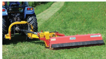
6. kép MKS PLUS típusú szárzúzó, a hajtásház külső oldalán elhelyezkedő hajtóművel
