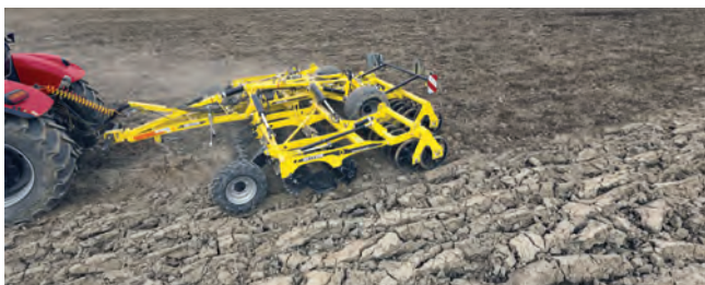
Az integrált futóműnek köszönhetően a gép nagy munkatempó mellett is megőrzi stabilitását.
