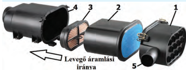
5. ábra. Donaldson PSD jelzésű kombinált levegőszűrő berendezés 1. mikrociklonos előszűrő rendszer; 2. főszűrő PowerCore® betéttel; 3. biztonsági szűrő; 4. szűrőház; 5. részecske eltávolító csőcsomok Forrás: www.donaldson.com
