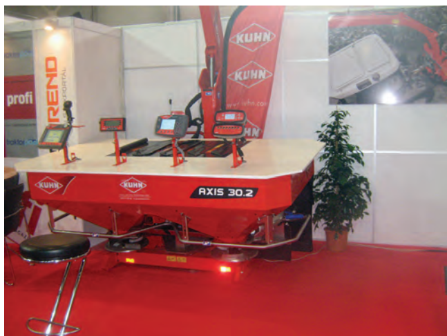
9. ábra: A műtrágyaszórók tömegmérés alapján GPS vezérléssel változtathatják a kiszórt adagmennyiséget
