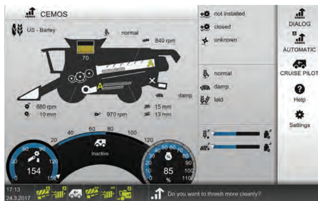
5. ábra: A CAN BUS kétirányú kommunikációs rendszer, pl. a CLAAS CEMOS is tömegmérési adatok alapján működteti, pl. az automatikus terhelésszabályozást
