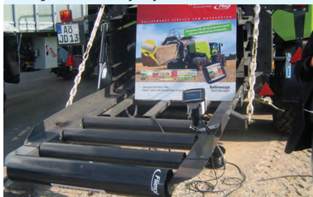
8. ábra: Szögletes nagybálázók elektromos mérlegrendszerének kijelzője
