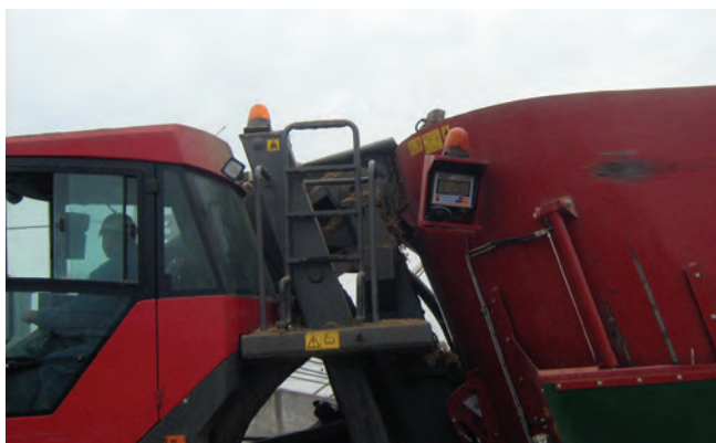
11. ábra: Magajáró keverő-kiosztó kocsi elektronikus mérlegének kijelzője
