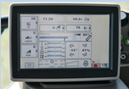
A pozíció-visszáállással vagy az elektromos párhuzamos-vezetéssel kapcsolatos összes információ a GreenStar 3 terminálban jelenik meg. A beállítás gombok segítségével vagy az érintőképernyővel történik. Ez egyszerűen és gyorsan működik
