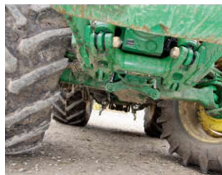
A rugós, szintezett első tengely nagy kormányzási szöggel rendelkezik
