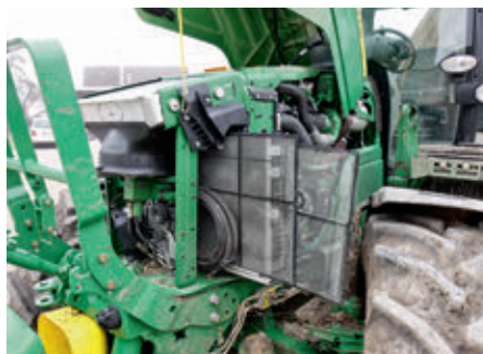
A kis pórusméretű szűrő megbízhatóan védi a hűtőt a szennyeződésektől, a tisztítás gyorsan elvégezhető
