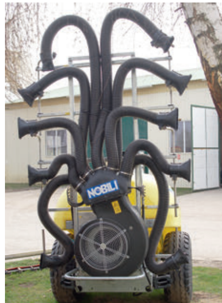
Az oldalankénti öt állítható csáp is hozzájárul az Oktopus takarékoságához
