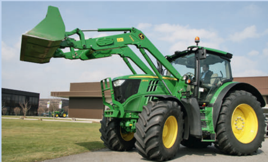
A H360-as homlokrakodó elektromos párhuzamos-vezetéssel egy 6170R traktorra szerelve: kizárólag szenzorok határozzák meg a hajlásszöveget, ami elektrohidraulikus vezérlésű
