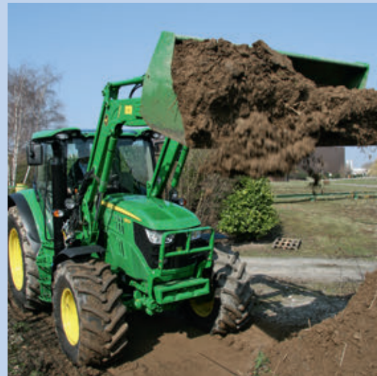
A mechanikus párhuzamos-vezetéssel ellátott rakodó most pozíció-visszáállással is kapható
