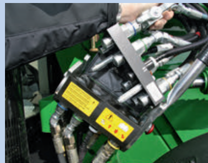
Az elektronika és a hidraulika a multicsatlakozó segítségével kapcsolható össze
