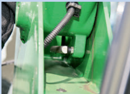
Szenzorok ellenőrzik a munkaeszköz és a lengőkar szögét, így vezérik a hidraulikát
