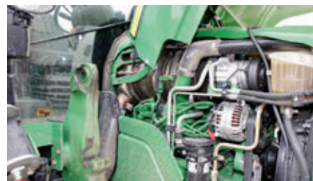
A dízel oxidációs katalizátor és részecske-szűrő biztosítja a tiszta kipufogógázt. A motorházban helyezkedik el, így nem zavarja a kiltást. A karbantartás nem okoz problémát, automatikusan történik
