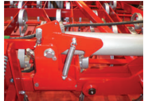
A mechanikus vagy hidraulikus szállítási reteszelés a traktorfülkéből irányítható
