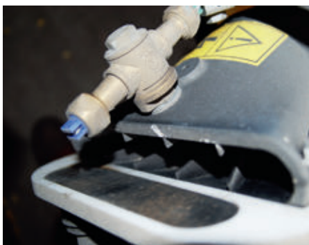
A tartókon kétállású, csepegésgátlóval ellátott, rendkívül takarékos fúvókák helyezkednek el
