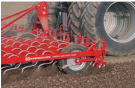
4 db nagy átmérőjű kerék gondoskodik a Vibro Masternél a pontos mélységtartásról
