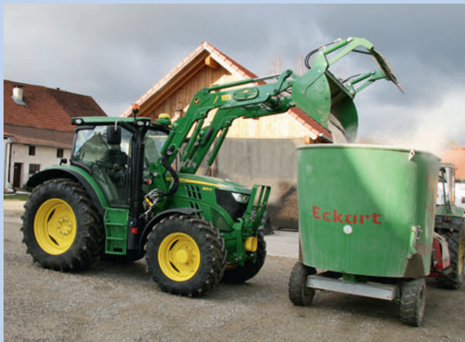
A hidraulikus párhuzamos-vezetéssel rendelkező változatnál használható a memória funkció. Ennek ismétlődő munkák esetén lehet jelentősége
