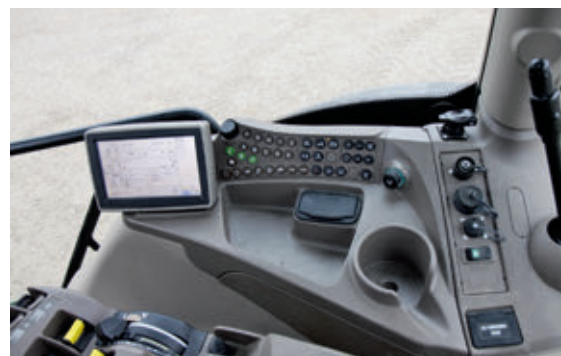
Itt van az igazi vezérlőközpont, érintőképernyős monitorral és a gombokkal, illetve görgővel történő vezérlés, valamint a leggyakoribb funkciókhoz tartozó közvetlen irányítógombok
