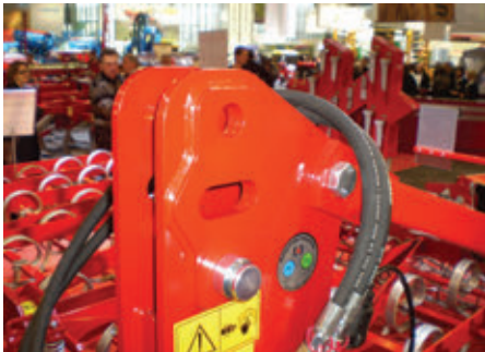
A felső támasztó karnál a hosszanti furat a megfelelő talajkövetést segíti elő, és védi a vázát a túlterheléstől
