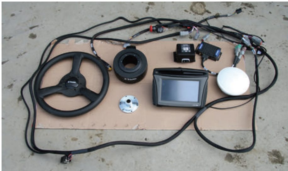
A kép a komplett szerelési készletet mutatja, beleértve a kormányt adapterlemezzel és motorral, a CXF-terminált, a navigációs számítógépet, az antennát és a vezetékeket
