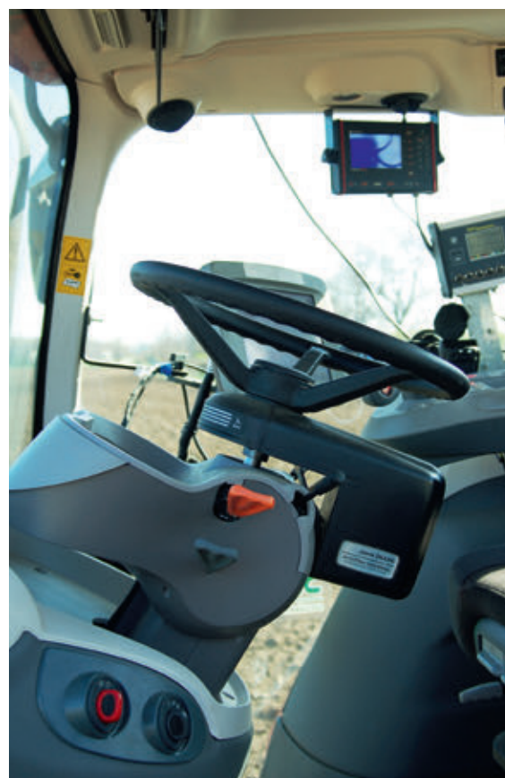
A műszerfal a teleszkópos kormányoszloppal együtt dől, ezáltal mindig jól látható
