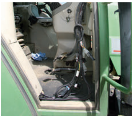
A kábelköteg teljesen el van látva a megfelelő csatlakozókkal. Ez megkönnyíti a beszerelést
