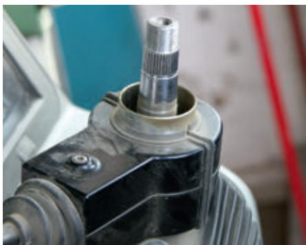
A kormányoszlop csomkjára egy adapterlemez kerül, amit a motorral kell összecsavarozni
