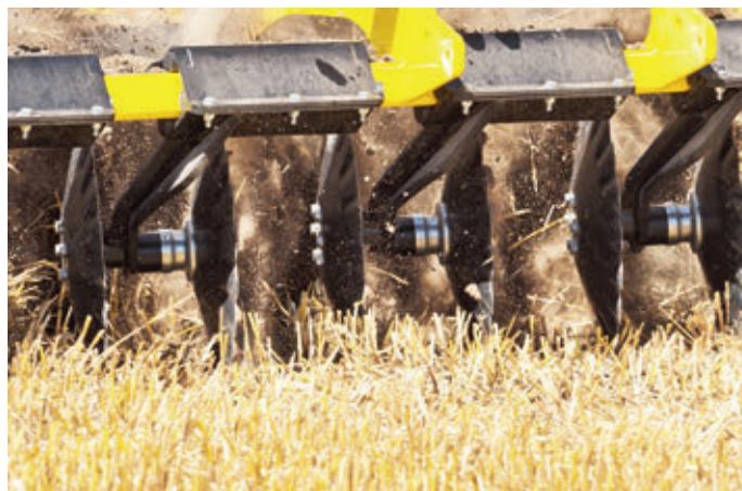
Az 520 mm átmérőjű A-tárcsák tökéletesen bedolgozzák a szármaradványokat
