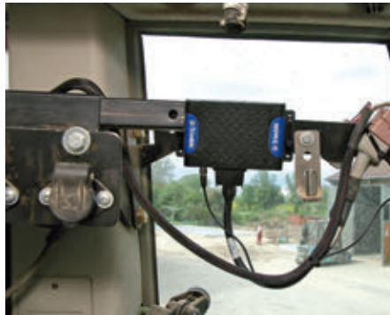
Ezen a dobozon keresztül foghatók az RTK-korrekciós adatok mobiltelefonnal
