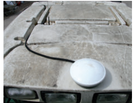
A GPS-antenna mágneses talppal rögzíthető elől középen, a vezetőfülke tetején
