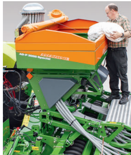
A különösen széles fellépő megkönnyíti az új AD-P Special feltöltését
