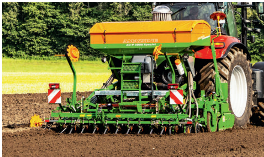
Az új AD-P Special pneumatikus vetőgép alapfelszereltsége az elektronikus adagolás
