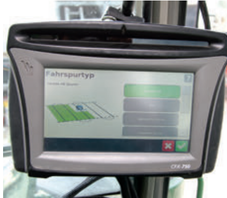
A CFX-750 terminállal történik a teljes párhuzamos nyomkövető rendszer irányítása és kezelése. A felső részen található LED-ek kiegészítő tájékozódásul szolgálnak
