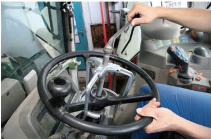
Először a régi kormányt kell levenni: ez csak a megfelelő kormánylehúzóval sikerül
