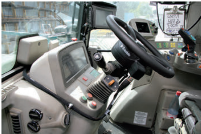
A motorra kerül a kormánykerék. A kormányzáshoz szükséges jelek vezetéken keresztül érkeznek a motor részhez
