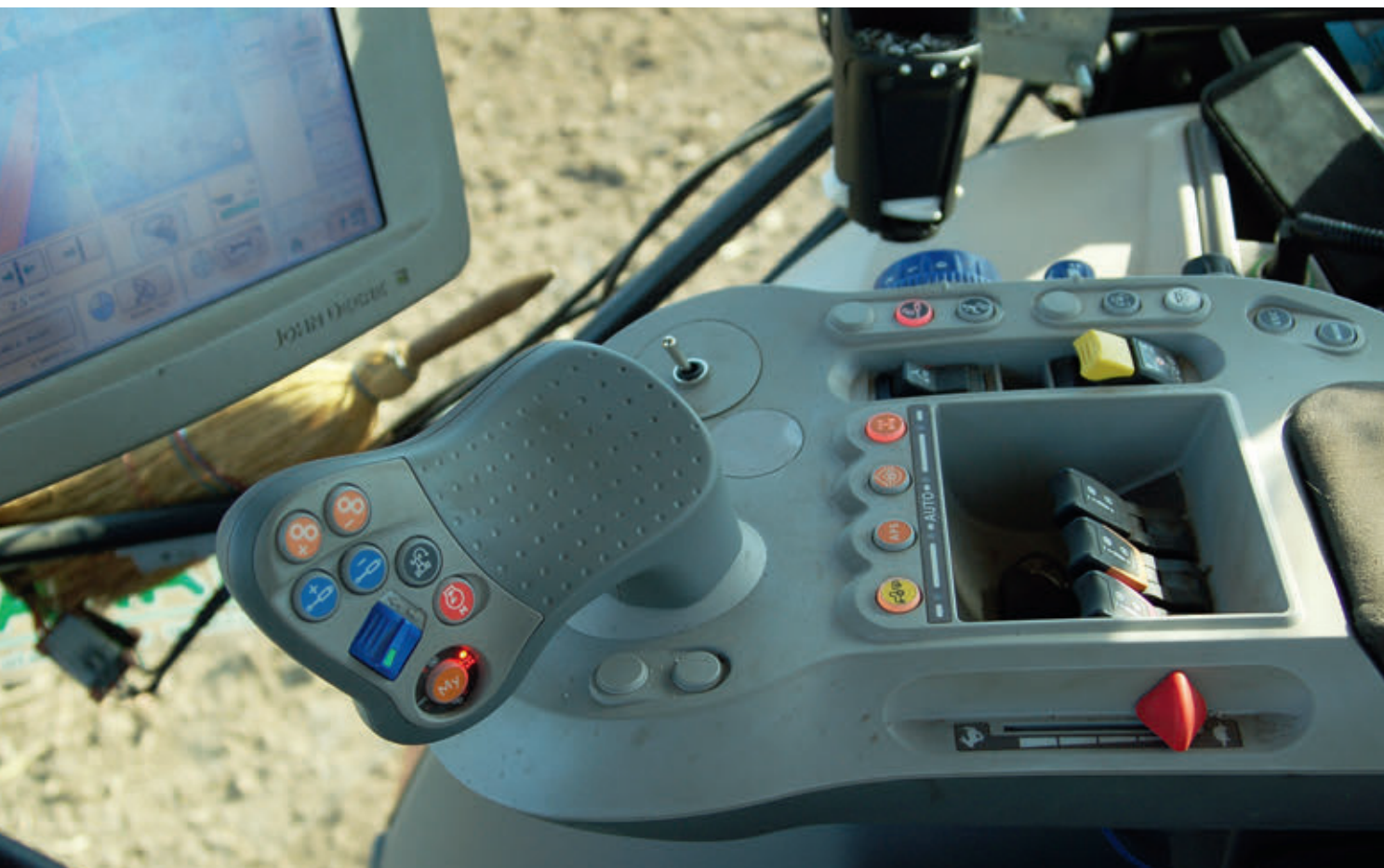
A multifunkciós kartámasszal a gyártó teljesen az ülésbe integrálta a logikusan elrendezett kezelőszerveket
