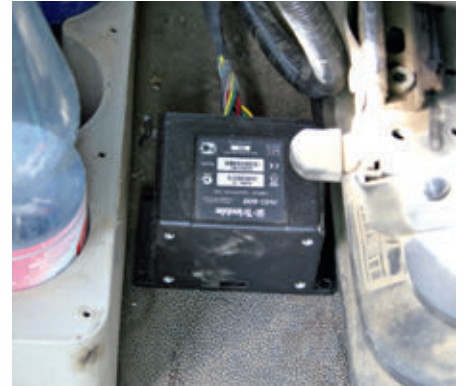
A navigációs számítógép határozza meg a traktor mozgását, és adja ki a kormányzási utasításokat a terminálnak
