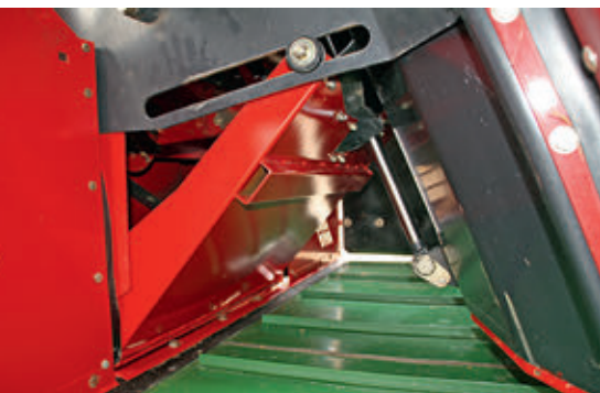
A szalmarotor hidraulikusan billenthető a kihordószalag felett, és szabad az út a turbinához
