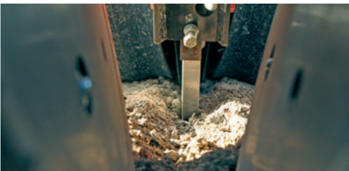
A vetőegységek stabil műanyagból készültek. Szabadalmaztatott a megfeleztett vetőtárcsa, ami széles magmérettartományban teszi lehetővé a vetést, átalakítás nélkül. Számos opció kínálja a vetőgép megfelelő módosítását a termőterület igényei szerint. A mi tesztgépünkön két V-alakú tömörítőkerék volt. Az ugyancsak opcionális köztes tömörítőkerék nedves teszterületeken hajlamos volt a bergadásra.
