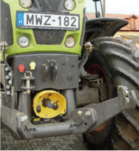
A fronthidraulika a moduláris felépítésének köszönhetően utólag is könnyedén felszerelhető
