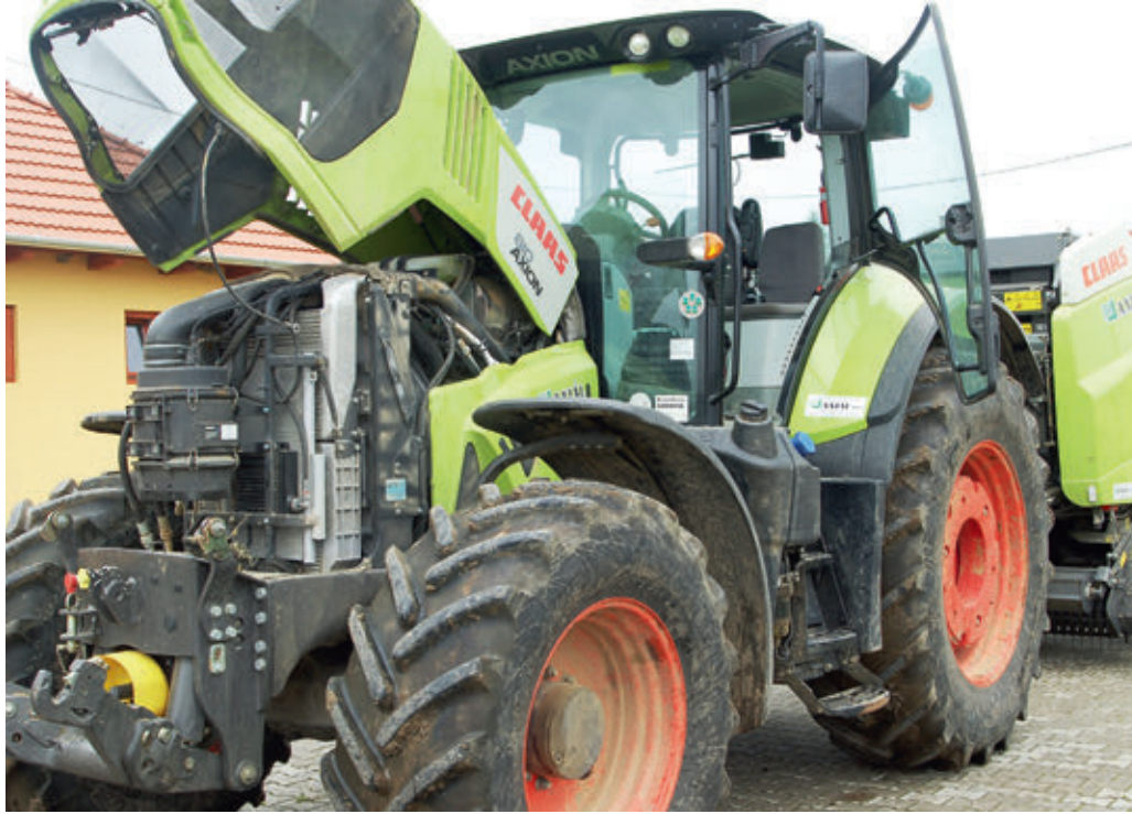
Az egyben nyíló motorháztető a motorban lévő karbantartási pontokhoz szabad hozzáférést biztosít
