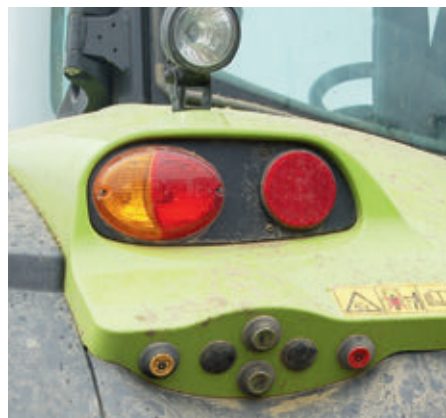
A hátsó TLT a traktor mindkét oldalán működtethető kívülről
