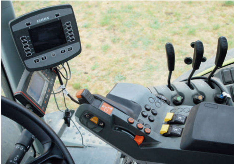
A kartámasz a gépkezelő igényének megfelelően állítható magasságban és hosszirányban
