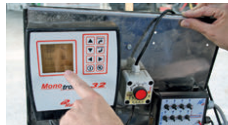
A Monotronic-32-vel a legnagyobb vezérlőegység állt rendelkezésünkre a tesztgépünkön. Számos területre vonatkozó elemzési lehetőség mellett minden vetőelemnél egy szenzor számolja – érintés nélkül – a kivetett magokat. A piros gomb kiegészítő védelmet jelent eltolódás esetén. A jobb szélén látható kicsi kapcsolódobozzal lehet a sorokat egyesével lekapcsolni.
