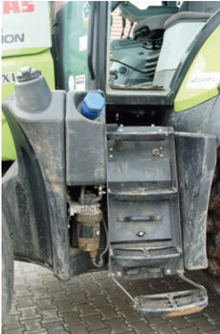
Az üzemanyagszűrő a fülke bal oldali feljórójánál, jól látható helyen található
