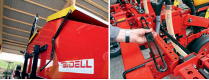
Balra: a tartályok fedelei letről egy kar segítségével nyithatóak. Jobbra: távtartókkal le lehet határolni a kívánt sortávolságokat. A mi 8-soros kivitelünk esetén 37,5-75 cm közötti távolságok állíthatók be.
