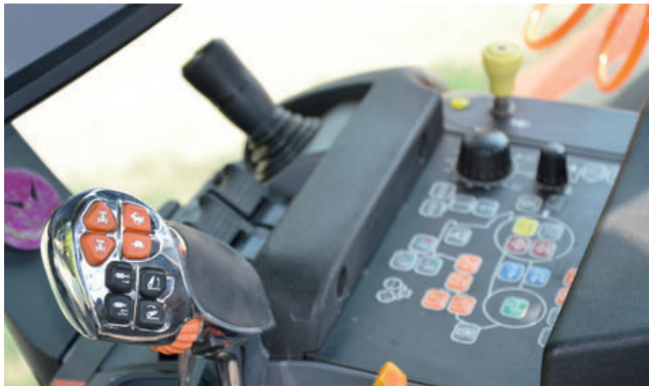
Minden ellenőrzés alatt. A multicontrollerrel 6 fő funkció szabályozható
