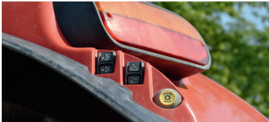
A hátsó sárvédőre kihelyezett vezérlógombok a hátsó TLT-hez. Ez a külső irányítás lehetővé teszi, hogy a munkaeszközök csatlakoztatását a kezelő egyedül is elvégezhesse
