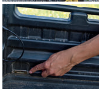
A korábbi Gator HPX modellhez képest az XUV 855-nek nagy előnye az egyedi kerékfelfüggesztés és az erős műanyagból kialakított kopásálló – könnyen tisztítható rakfelület, amelyen elegendő hely van egy EURO-raklap számára. A rakomány biztonsága érdekében a Gator erős rögzítési pontokkal is rendelkezik a rakfelületén
