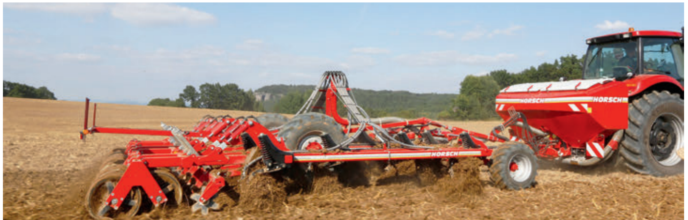
Terrano FM+Partner HT műtrágya és zöldtrágya vetőmag egyszerre történő kijuttatásánál
