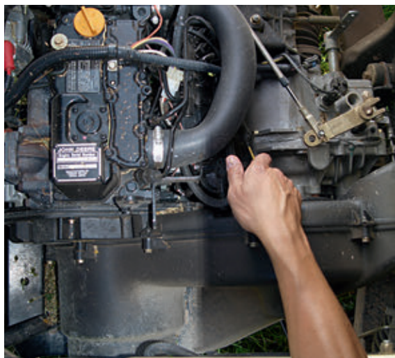
A 16,1 kW-os/21,9 LE-s dízelmotor a rakfelület alatt található (kis kép), Yanmar gyártmányú
