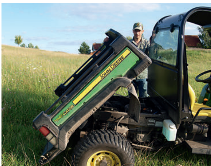
A korábbi Gator HPX modellhez képest az XUV 855-nek nagy előnye az egyedi kerékfelfüggesztés és az erős műanyagból kialakított kopásálló – könnyen tisztítható rakfelület, amelyen elegendő hely van egy EURO-raklap számára. A rakomány biztonsága érdekében a Gator erős rögzítési pontokkal is rendelkezik a rakfelületén
