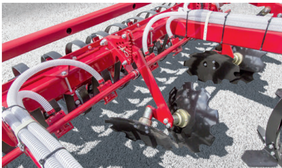
Terrano FM+Partner HT műtrágya és zöldtrágya vetőmag egyszerre történő kijuttatásánál
