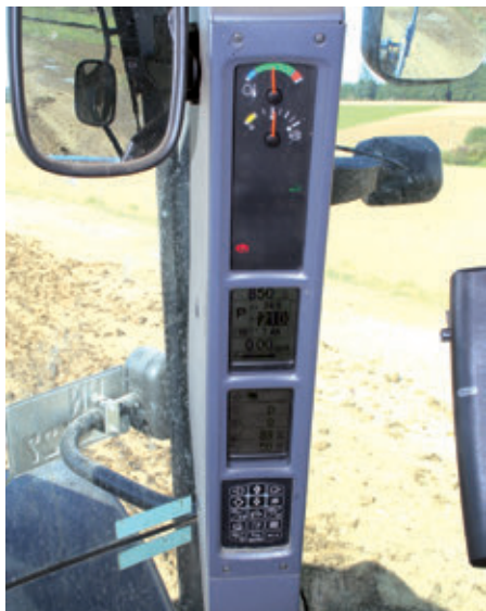
Az „A”-oszlopba integrált kijelzők a vezető természetes látóterébe esnek, akár egy pillantással leolvashatók az adatok
