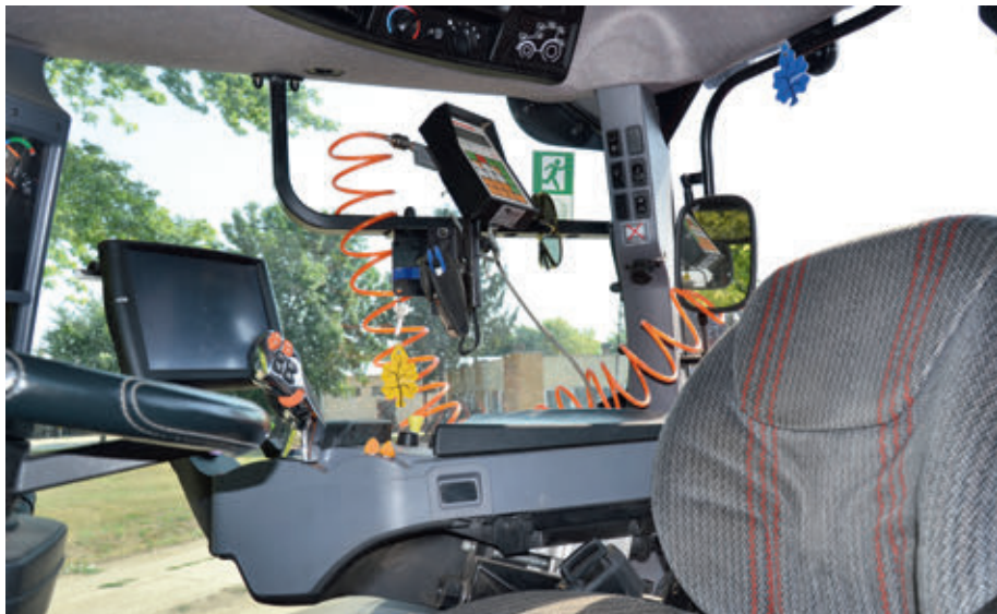
A dönthető kormány, a légrugós ülés, az akadálymentes kilátás, a jobb kartámaszba épített ergonomikus műszeregyüttes, az érintőképernyős monitor, a kényelmi funkciók mind a fáradtságmentes munkavégzést kívánják kiszolgálni
