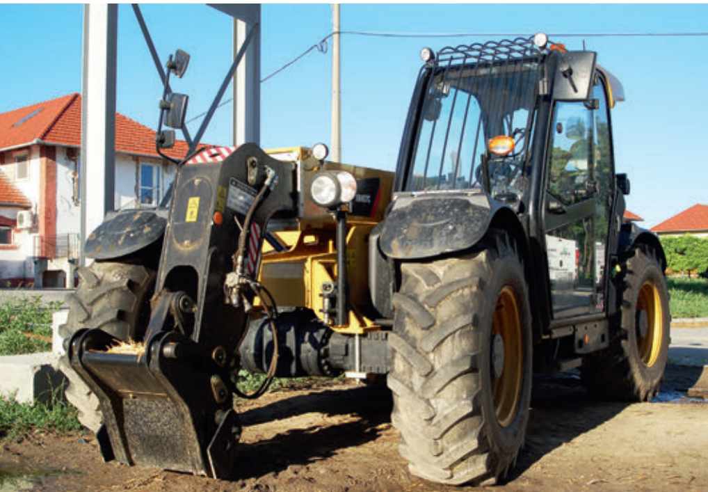
A Telehandler gyorscsatlakozójának köszönhetően egyszerű a különféle munkaeszközök cseréje
