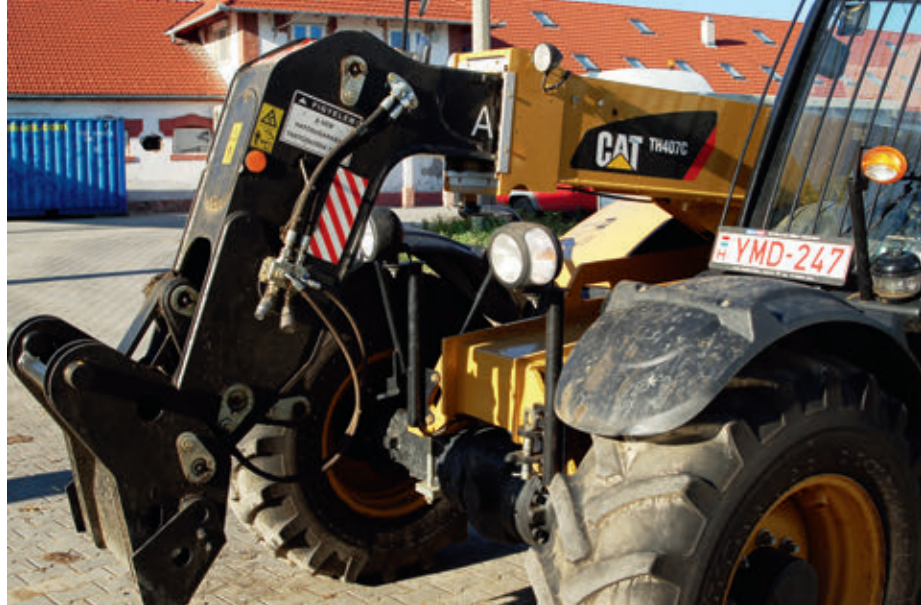
A Cat teleszkópos rakodó Z-karos rudazata a nehéz munkálatokhoz is nagy felszakítóerőt biztosít, ezenkívül a gép kanala is gyorsan billenthető
