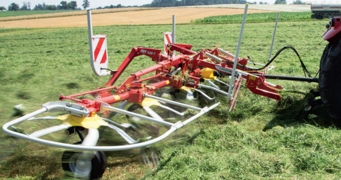
A HIT 6.80 T-n a rotorátmérő 1,67 m
