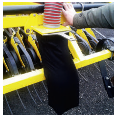
A vetésmennyiség kalibrációja és a tartály ki- ürítése a gép hátuljánál végezhető el
