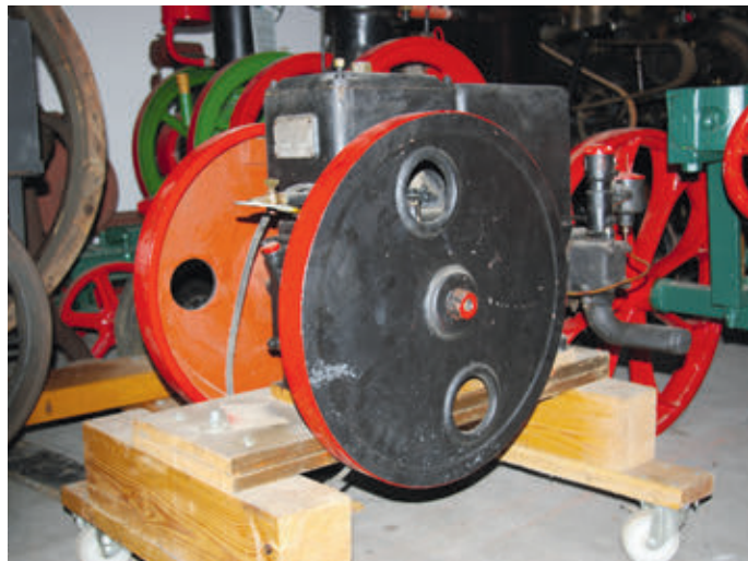
MIA-motor 4 LE-s benzin/petróleum üzemű változata
