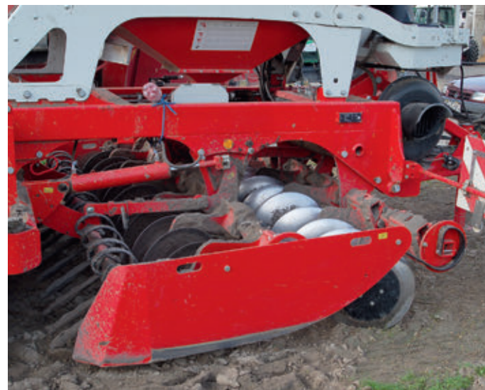
A tárcsasorok két oldalán elhelyezett terelőlemez megakadályozza nagy munkasebesség mellett is a föld kidobódását
