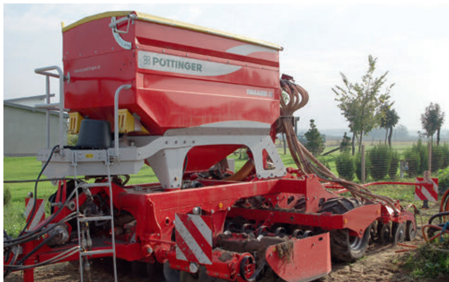
A TERRASEM mulcsvetőgépet a teljes értékű rövidtárcsás ekével, az egyedülálló tömörítővel és a tökéletes vetősínnel jól egyesíti a talajművelést, a visszatömörítést és a vetés lépéseit
