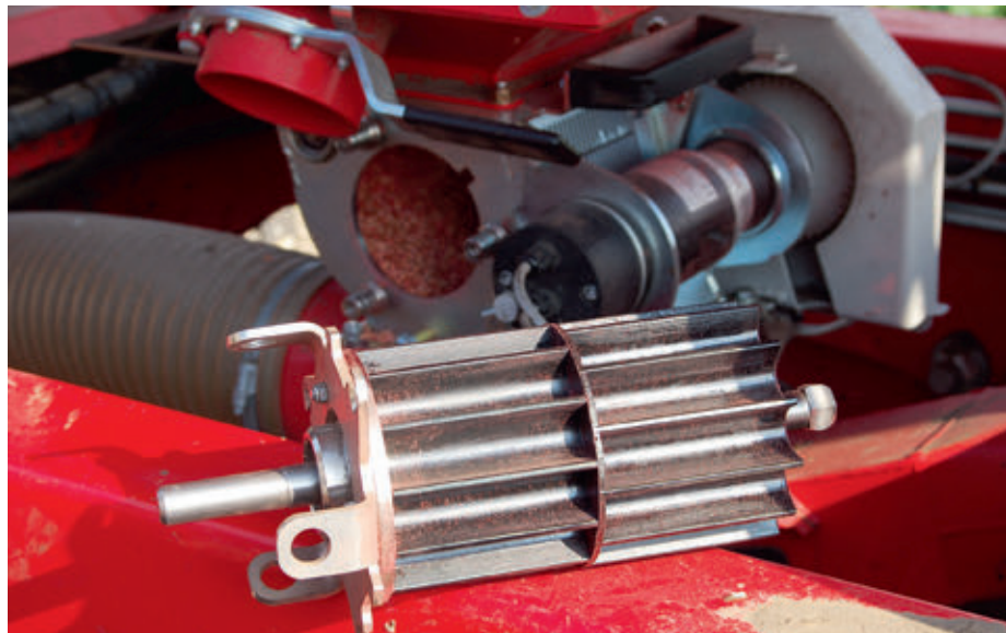
A vetőmagtartály alatt található vetőhenger egyszerűen és gyorsan cserélhető
