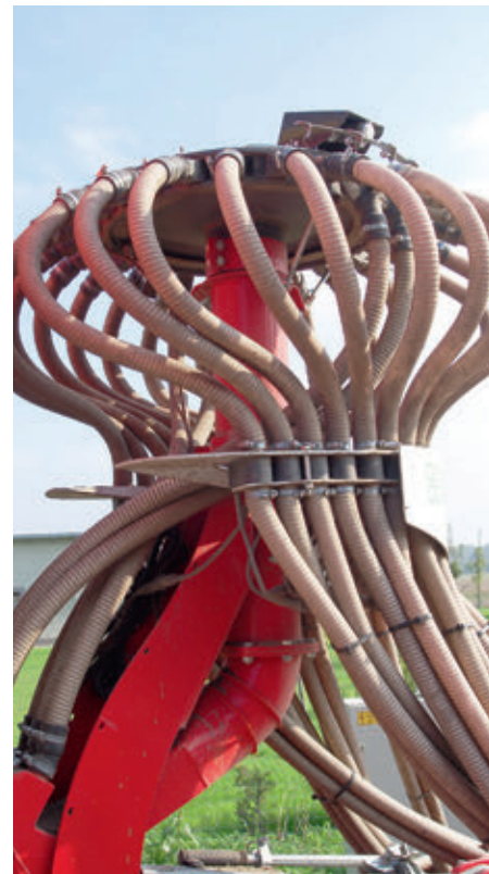
A TERRASEM vetőgép osztógyűjtője mindig egyenletesen osztja el a vetőmagot a 24 csoroszlyához
