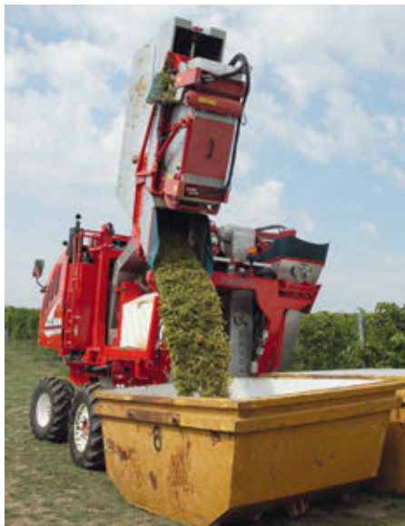
A TRE 35 E szőlőkombájn tartályai gyorsan üríthetők
