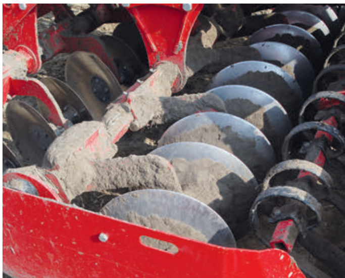
A kétsoros rövidtárca V-alakban elhelyezett tárcsalapjai könnyebben nyitják meg a talajt
