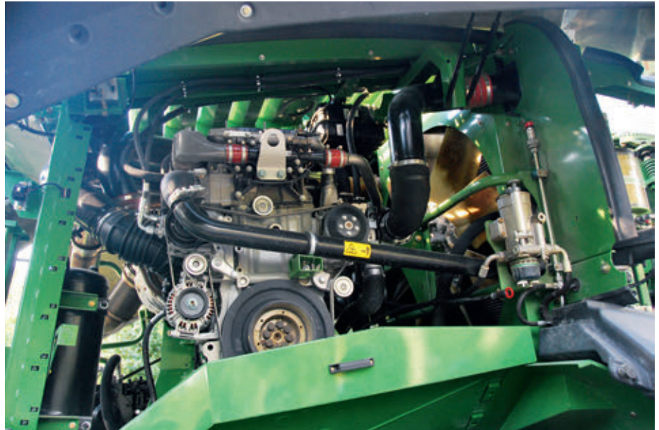
A Krone ragaszkodott a jól bevált MTU-technológiához (R6 motor)
