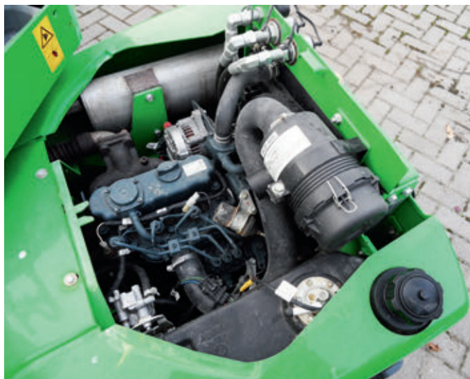
Az AVANT 20 lóerős Kubota dízelmotorja rendkívül gazdaságos
