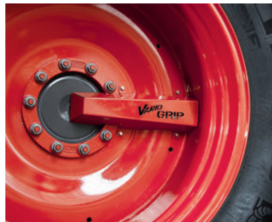
A Vario Grip egy teljesen a járműkonceptióba integrált abroncsnyomás-szabályozó rendszer
