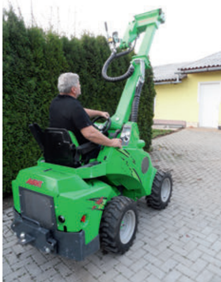
Az oldalra helyezett gémszerkezet jó rálátást biztosít a munkaterületre és a munkaeszközre
