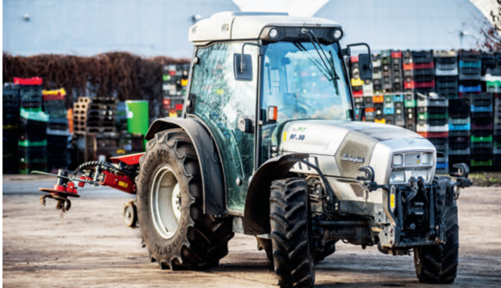
A kabin légkondicionált és szénzsűrős, ennek köszönhetően a növényvédelmi munkákhoz is rendkívül alkalmas
