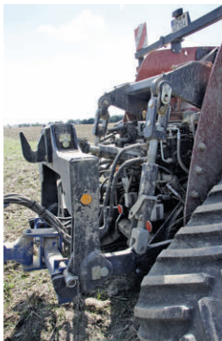
A hátsó részre akár nyolc kiegészítő hidraulika-csatlakozás is felszerelhető, amelyeket 428 l/min maximális teljesítménnyel lehet ellátni
