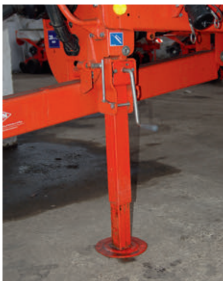
A gép felhajtható kitémasztó lába permetezés közben felhajtván nem károsítja a kezelt növényt
