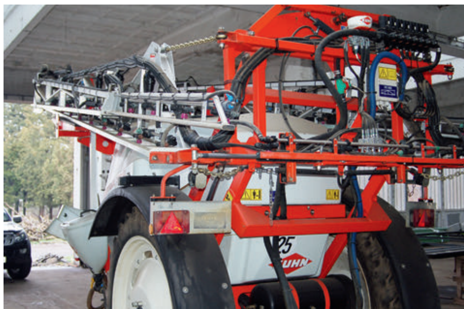
Alumínium standard szórókeret – könnyű, korrózióálló és robusztus
