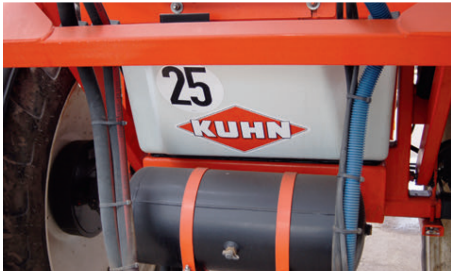
A permetezőgép hátsó részén, középen elhelyezett 300 literes tisztavizes tartály biztosítja a gép egyensúlyát
