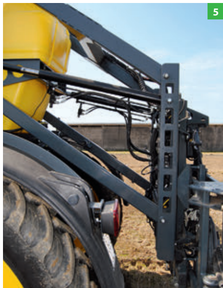
A víz a tartályban ellentétes irányba mozog a vegyszerrel, hogy az feloldódjon, majd visszatér a központi tartályba, így a vegyszer progresszív hígításban vesz részt. A zárás/nyitás manuálisan állítható egy csavarral, hogy a keret szépen síkba nyíljon, a munkahengerek mozgási sebessége fojtószeleppel finoman állítható
