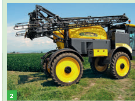
Tekintélyes méretei ellenére a gép korlátozott mozgástérben is megfelelően, kiszámíthatóan viselkedett (1-3. kép). Könnyen megfordult a táblaszéleken, köszönhetően a négykerék-kormányzási rendszer 3 lehetséges módjának (2-4. kép)
