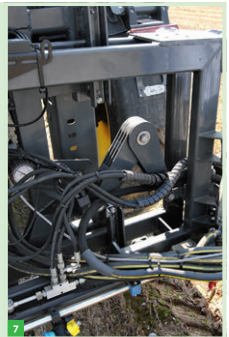
A paralelogramma felfüggesztés ingaszerű önbeálló rendszert is tartalmaz, hogy mindig szintbe álljon a keret. A keret hidraulikusan billenthető (6), a beépített lamellasor pedig csökkenti a keret oldalirányú rázkódását, mikrorezgését (7). A keret függőleges irányú lengését nitrogénakkumulátor biztosítja, a keretmagasság automatikus tartását pedig szonárrendszer segíti
