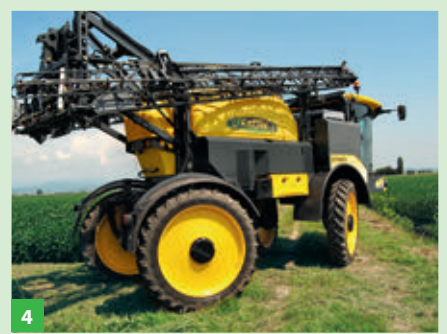
Tekintélyes méretei ellenére a gép korlátozott mozgástérben is megfelelően, kiszámíthatóan viselkedett (1-3. kép). Könnyen megfordult a táblaszéleken, köszönhetően a négykerék-kormányzási rendszer 3 lehetséges módjának (2-4. kép)
