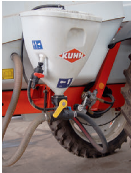
A flakonmosós vegyszerbekeverő tartály a por halmozállapotú növényvédő szert is gyorsan bekeveri
