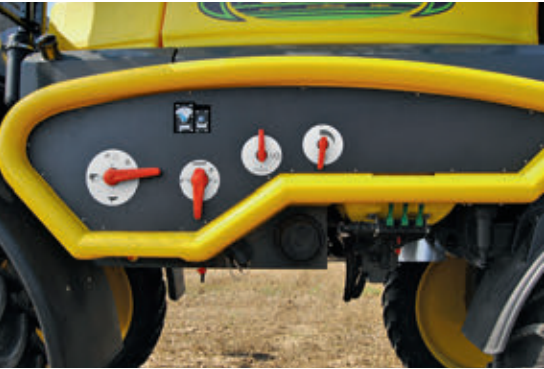
A gép bal oldalán a kezelő különböző szervizbeállításokat végezhet, csatlakoztathatja a felszívó tömlőt, és ellenőrizheti a szívó oldali szűrőt
