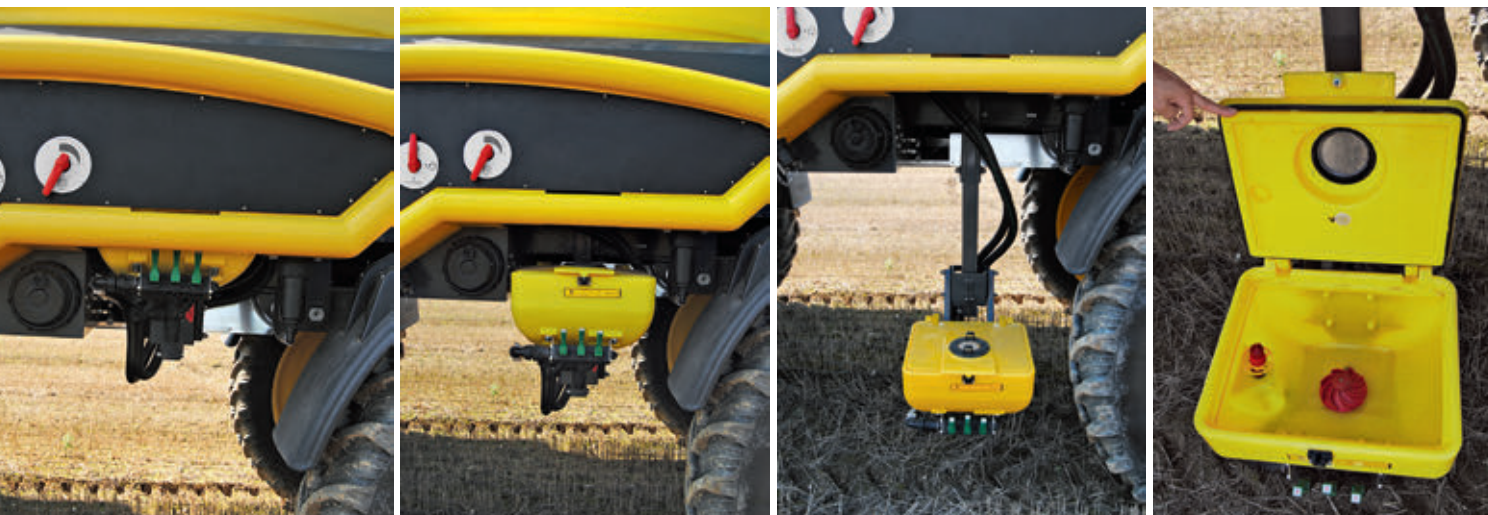
A premixer tartály űrtartalma legalább 40 liter, mozgatása elektrohidraulikusan történik. A tartály alján a keverő bemossa a vegyszert, a működtetés manuális karokkal történik, miközben a tartály zárva van, így a kezelő teljes biztonságban végezheti munkáját
