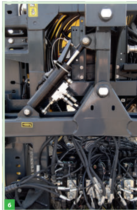
A paralelogramma felfüggesztés ingaszerű önbeálló rendszert is tartalmaz, hogy mindig szintbe álljon a keret. A keret hidraulikusan billenthető (6), a beépített lamellasor pedig csökkenti a keret oldalirányú rázkódását, mikrorezgését (7). A keret függőleges irányú lengését nitrogénakkumulátor biztosítja, a keretmagasság automatikus tartását pedig szonárrendszer segíti
