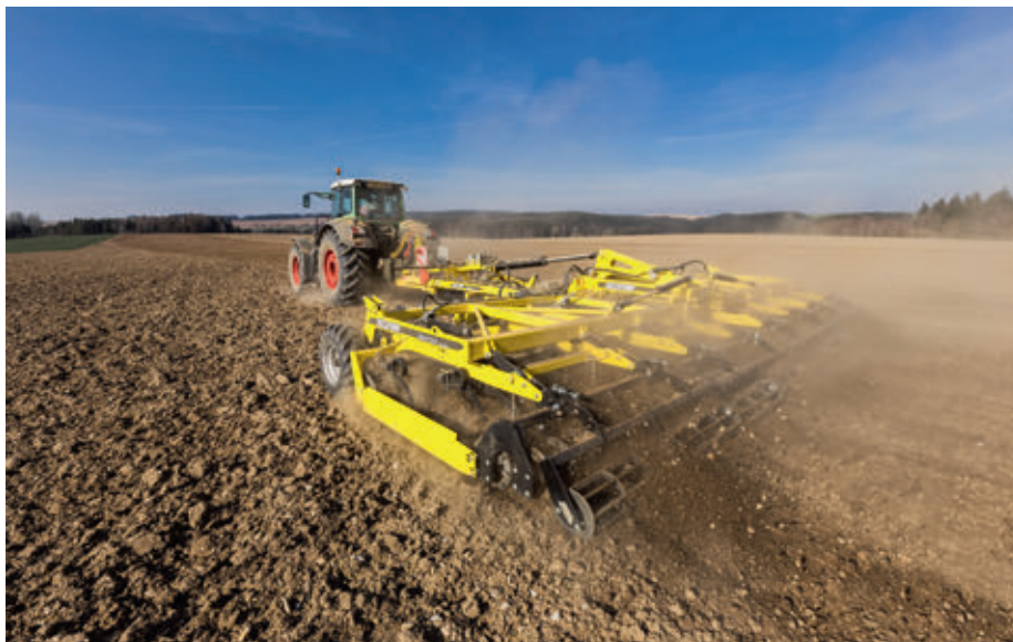
A BEDNAR magágykészítők fogásszélessége 3 méternél kezdődik, és a figyelemreméltó 18 méternél végződik
