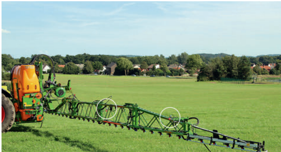
A DistanceControl plus a szórókeret bal és jobb oldali felén már két-két érzékelővel rendelkezik, ami különösen egyenetlen területen, vagy nem homogén növényállomány esetén jobb szórókeret-megvezetést eredményez
