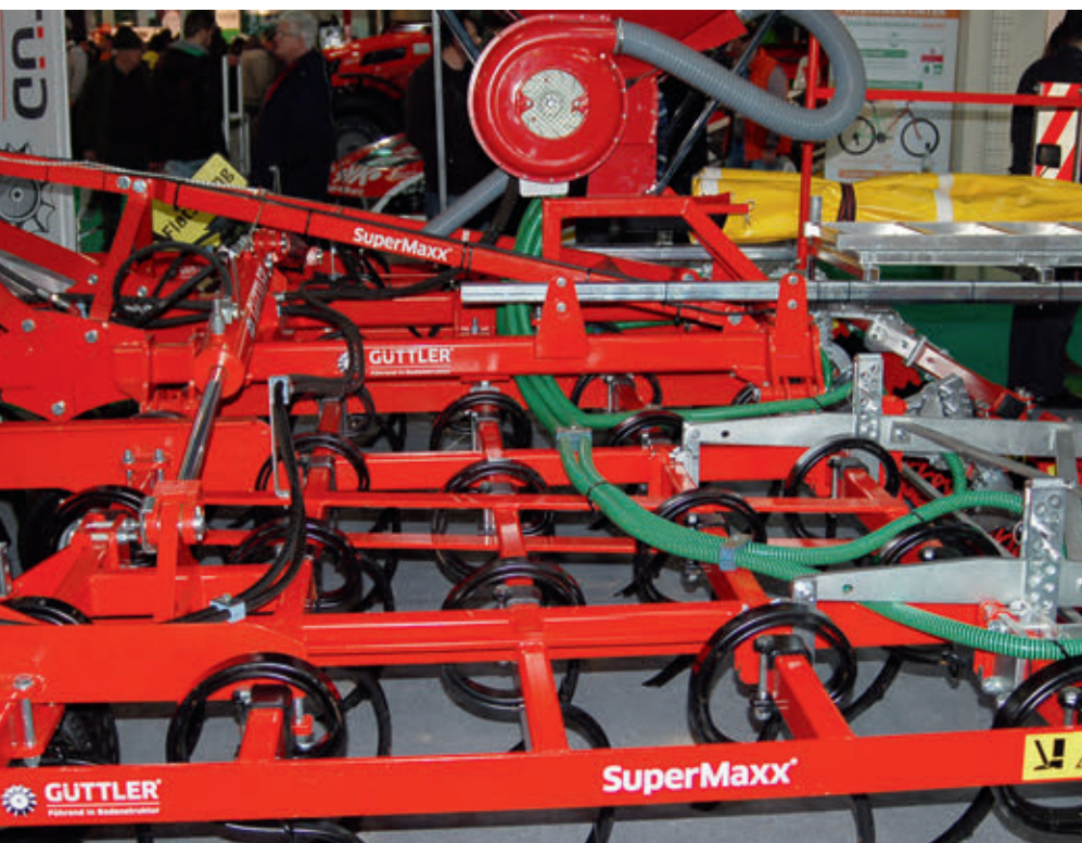
A SuperMaxx sokoldalú kultivátor tulajdonképpen három – tavaszi, nyári és őszi-téli – technológiára megtervezett munkaeszköz
