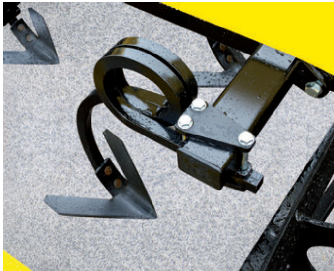
A 270 mm-es lúdtalpkapák flexi szárakra vannak szerelve, amelyek „3D-efektust” biztosítanak a művelés során
