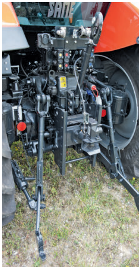
A II. kategóriájú hátsó hidraulikus emelőberendezéssel a Virtus akár 4 650 kg felemelésére is képes; kiegészítő hengerrel ez opcionálisan 2 tonnával növelhető
