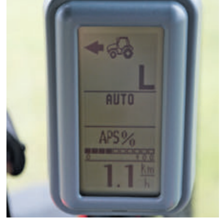
Az A-oszlopon lévő hajtómű kijelzőn folyamatosan láthatja a járművezető a menetirányt, a terhelés alatt kapcsolt fokozatot, a sebességet és az APS-értéket
