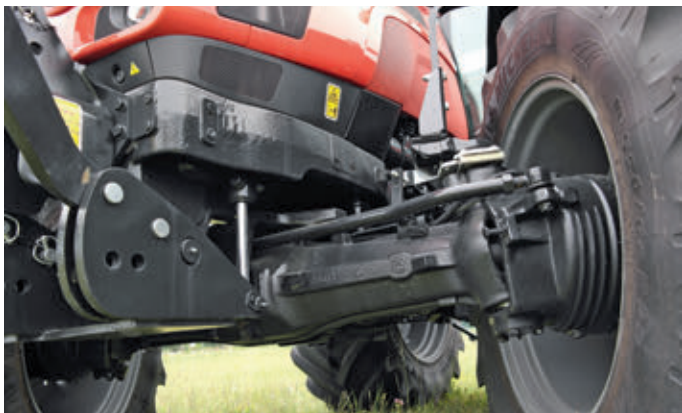
Az elöl lévő hidraulikus emelőberendezés munkahengere a forgáspont mögött van; így az emelőmű nagyon kompakt. A saját gyártmányú Same-Deutz-Fahr első tengelyekhez igény szerint rendelhető kikapcsolható rugózás. Kiegészítő funkcióként az első kerekeket nedves tárcsafék késlelteti – figyelemre méltó hatással
