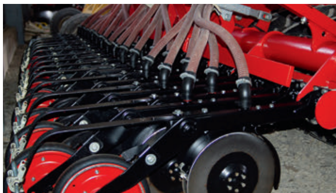
TurboDisc vetőcsoroszlya – pontos vetőmag-lehelyezés nagy vetési sebességnél is
