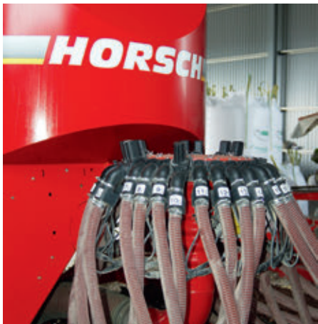
A pneumatikus Pronto 4 DC vetőmag elosztója
