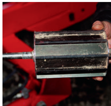
Gyors és egyszerű a Pronto DC adagolóhengerének cseréje
