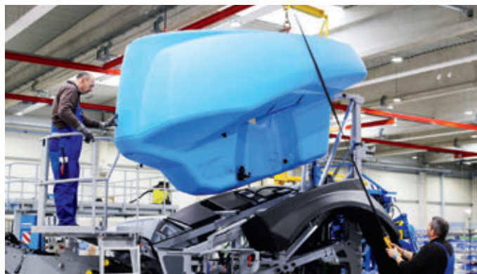
A tartály felszerelése a vontatott Vega permetezőre az új gyárban (Haren)
