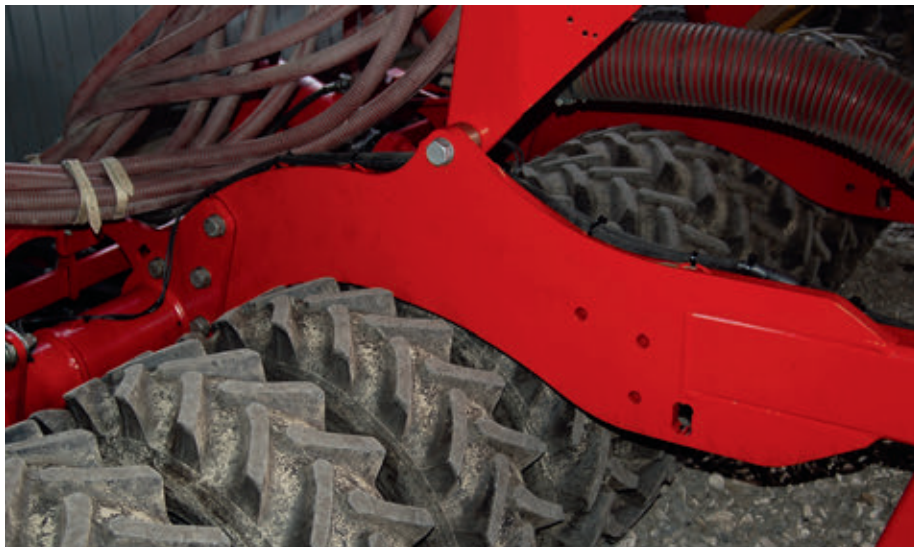
Gumikerekes talajtömörítő – hatékony visszatömörítés minden vetőcsoroszlya előtt
