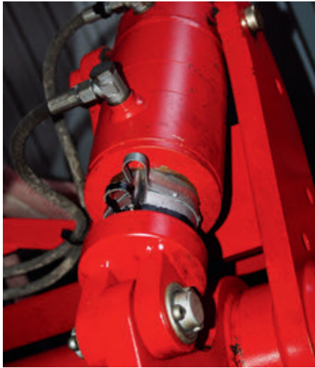
A vetésmélységet a munkahengeren található klipszekkel gyorsan beállíthatjuk
