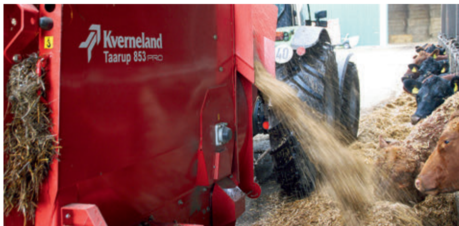
A csúszdára takarmány kijuttatásakor lehet szükség. Nemcsak a takarmányáram sebességét csökkenti, hanem a takarmányasztalon is szélesebben teríti el a takarmányt. A tartórészben két szögletes bála fér el egymásra helyezve, vagy két közepes méretű körbála egymás mögött
