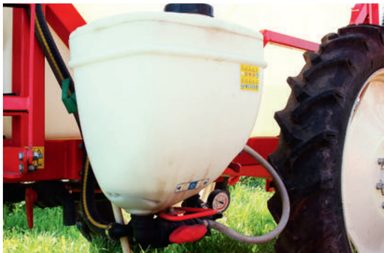
A paralelogramma felfüggesztésű vegyszerbekeverő tartálynak köszönhetően rendkívül jól elkeveredik a növényvédő szer a vízzel
