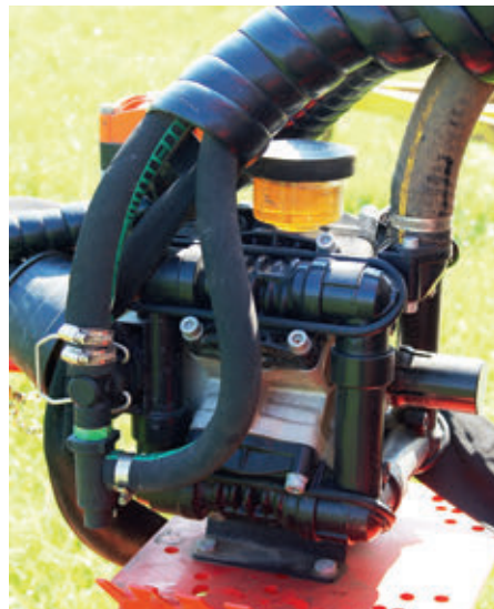
Könnyen kezelhető permetléshivattyú csekély karbantartási igénnyel
