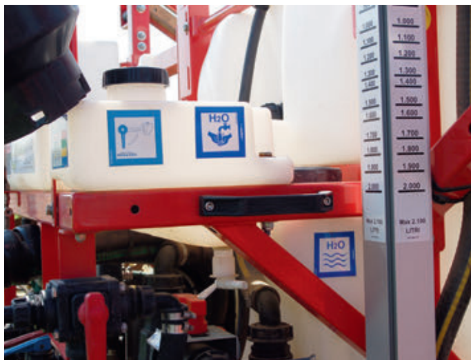
A Campo permetezőgép 215 literes tisztavizes tartállyal szerelt
