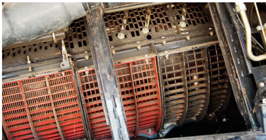
A Case IH 230-as sorozatú kombájnok legújabb fejlesztésű, kis átmérőjű Small Tube rotorjában a termény önmagát csépli ki, a magtartályba kerülő szemek gyakorlatilag sérülésmentesek maradnak. A rotorban lévő kosarak rövid idő alatt kicserélhetők
