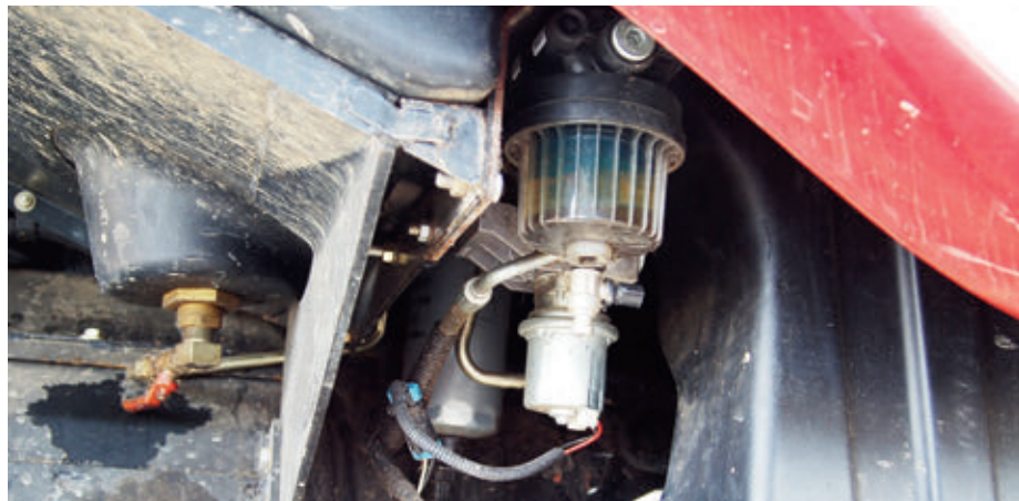
A karbantartás rövid idő alatt egyszerűen elvégezhető. A zsírozási pontok és a szűrők jól hozzáférhető helyen találhatók
