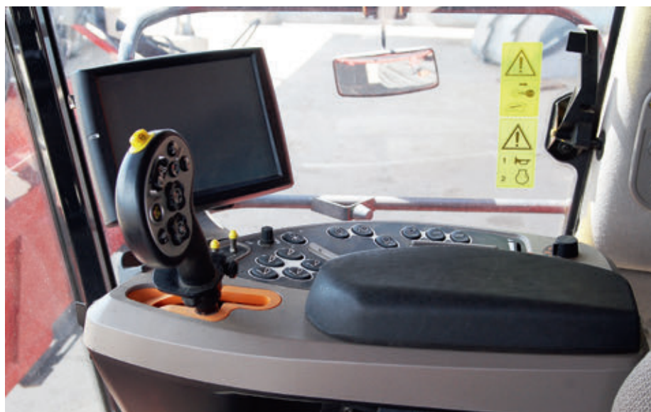
A multifunkciós menetzérlő kar az Axial-Flow kombájn összes létfontosságú funkcióját magában foglalja, így ezek egyetlen kézzel működtethetők
