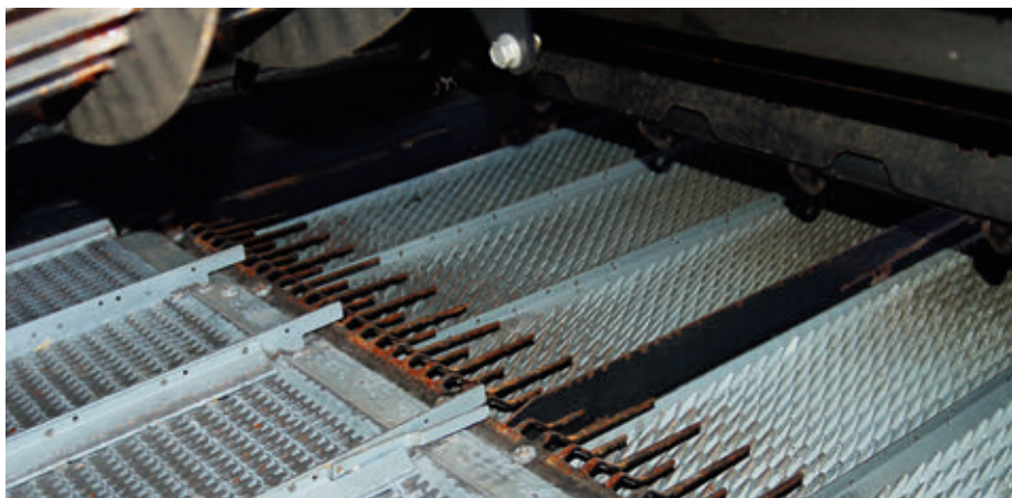
A kombájn önszintező tisztítófelülete akár 12%-os dombon is síkban tartja a rostaszerkezetet
