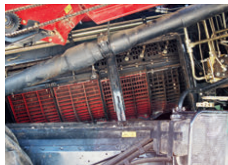
A Case IH 230-as sorozatú kombájnok legújabb fejlesztésű, kis átmérőjű Small Tube rotorjában a termény önmagát csépli ki, a magtartályba kerülő szemek gyakorlatilag sérülésmentesek maradnak. A rotorban lévő kosarak rövid idő alatt kicserélhetők
