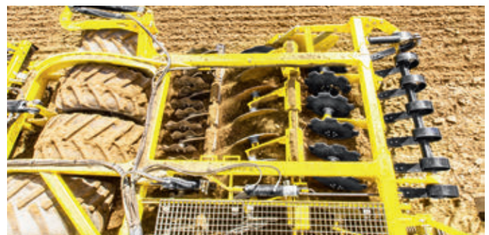
A hagyományos tárcsás művelőegység mögé szerelhető a hullámos tárcsasor
