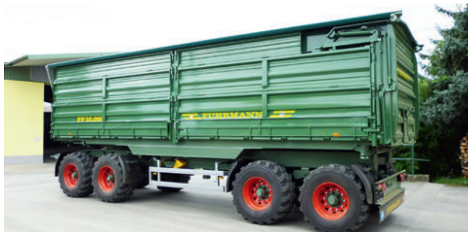
Négytengelyes, billenőplatós, forgószármolyos pótkocsik maximum 23 tonna hasznos terhelhetőséggel
