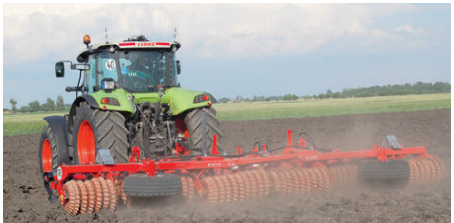
Az új Offset hengercsalád jellegzetességét az egymáshoz képest eltolva elhelyezett hengerelemek jelentik
