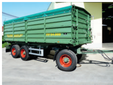
Háromtengelyes, 3 oldalra billenthető forgószármolyos pótkocsik maximum 18 tonna hasznos terhelhetőséggel
