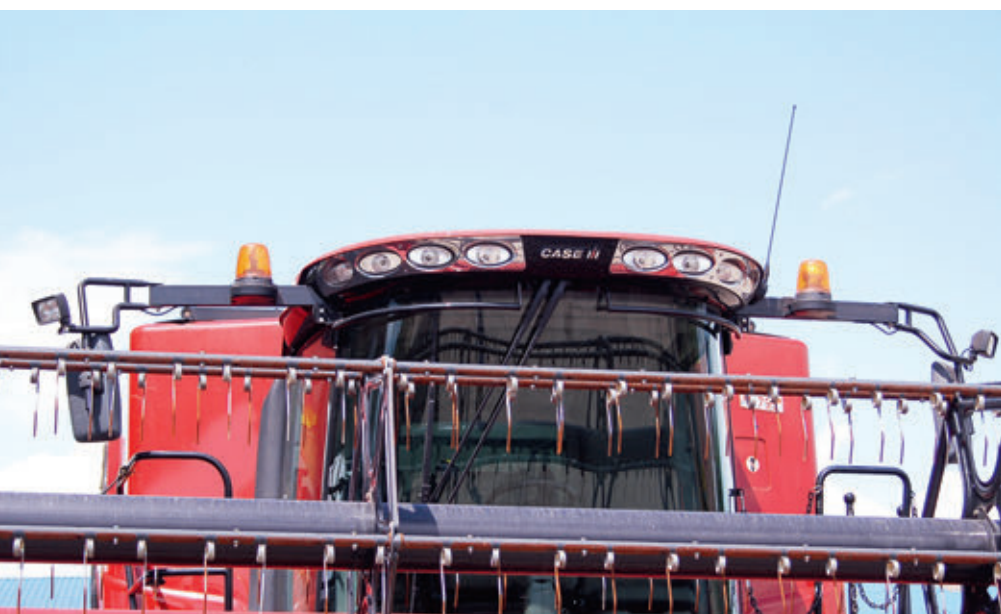
A fülketetőre szerelt fényszórók tökéletesen bevilágítják a munkaterületet, így az éjszakai munka is biztonságos és hatékony
