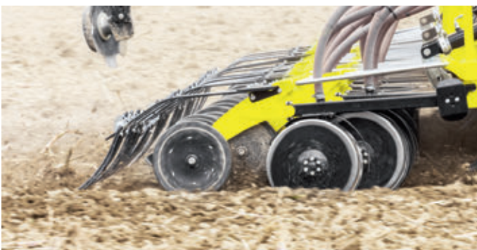
Paralelogramma vezetésű duplatárcsás vetőcsoroszlya-rendszer
