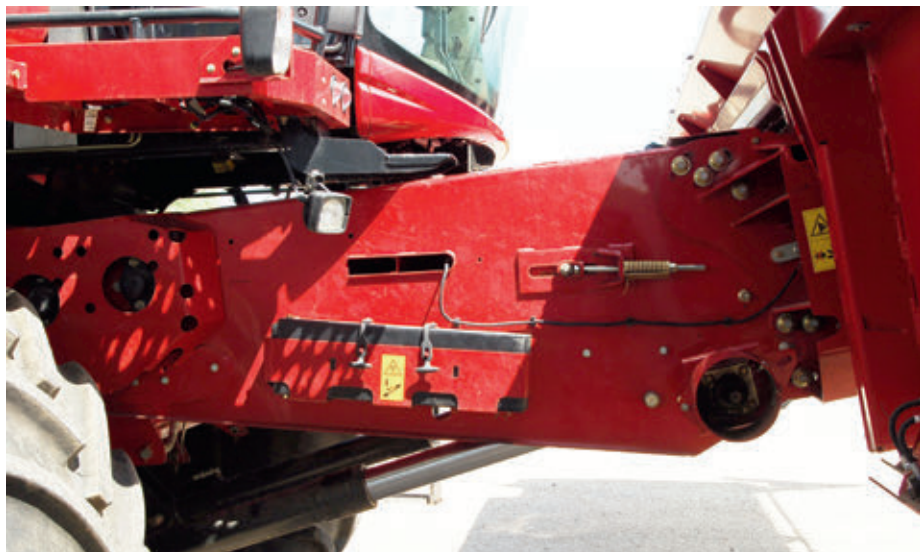
A Case IH kombájnt ferdefelhorója egyszerű kialakítású és alacsony karbantartási igényű, kevés kopóalkatrészt tartalmaz
