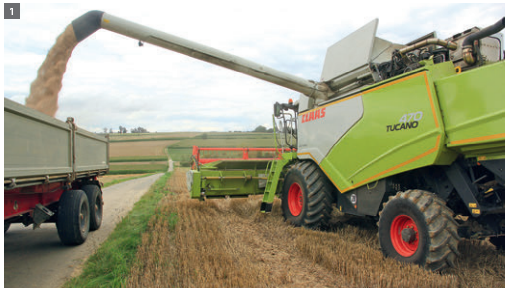
1 A felső ürítésnek köszönhetően csőhossztól függően 4,1-4,6 m ürítési magasság állítható be.
