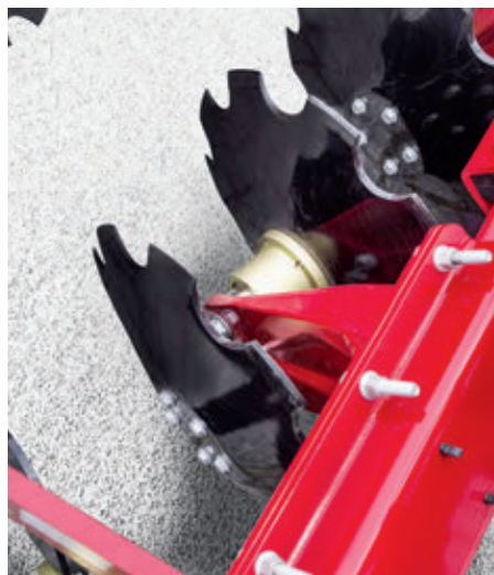
Tárcsák páros felfogatása – nagy átömlő keresztmetszetet biztosít
