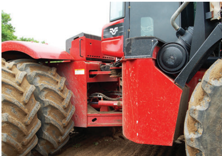
A VERSATILE napi karbantartása egyszerű és gyorsan elvégezhető. A szűrőkhöz, zsírozópontokhoz, hűtőhöz és a csuklóponthoz is könnyű hozzáférni
