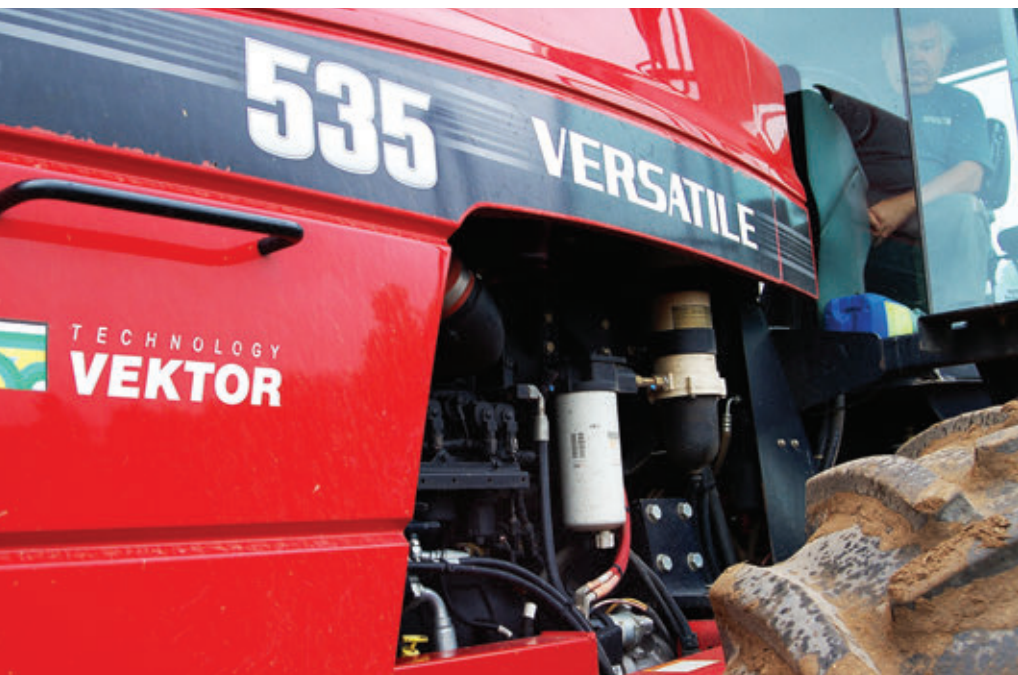
A VERSATILE napi karbantartása egyszerű és gyorsan elvégezhető. A szűrőkhöz, zsírozópontokhoz, hűtőhöz és a csuklóponthoz is könnyű hozzáférni
