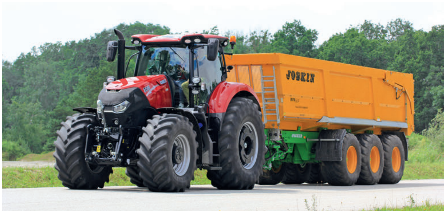
Megrakodva: a több hasznos teher és a nagyobb vonóerő elérése érdekében új első tengelyt fejlesztettek ki
