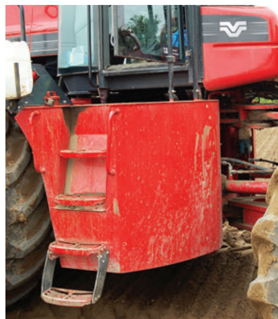
Az osztott üzemanyagtartályon kialakított lépcsőn kényelmes a felszállás a kabinba
