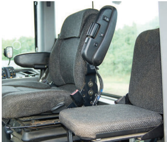
A Deluxe kabinban lévő rendkívül kényelmes félaktív felfüggesztésű ülés mellett pótülés is helyet kapott
