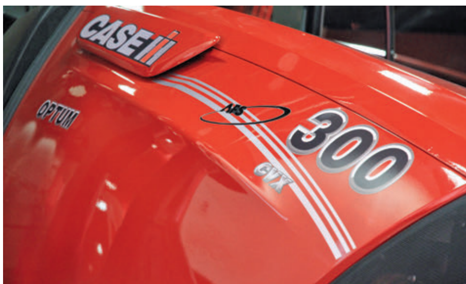
Szellőzés: a szellőzőnyílásokat a tervezők ügyesen beépítették a motorháztetőbe, és egy CASE IH feliratú takarólemezzel látták el. Ez jól illik a traktor dizájnájához
