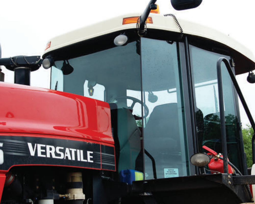
A fülkéből a munkaterületre való rálátás a teljes 360°-ban tökéletes, amit a keskeny oszlopok is segítenek
