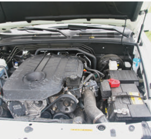
Saját fejlesztésű, 2,2 literes motor: 178 LE, 400 Nm nyomatékkal
