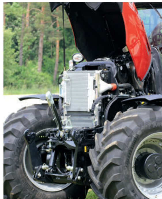
A 6,8 literes, hathengeres motor alapja a Puma-motor, de ez nagyobb turbófeltöltőt és stabilabb olajteknőt kapott
