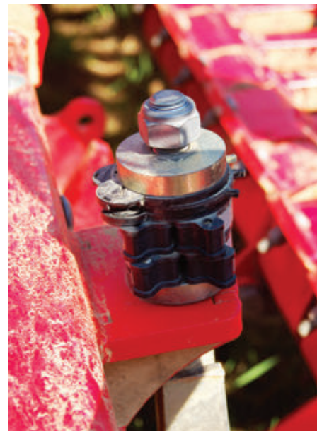
A vetési mélység a klipszek segítségével gyorsan és egyszerűen beállítható
