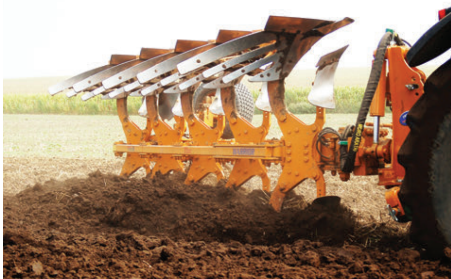
Az abai rendezvényen bemutatott 4+1 fejes eke 1,8 tonna tömegű, fogásszélessége 20 és 70 cm között hidraulikusan, fokozatmentesen állítható
