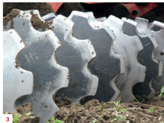
5 A szélső tárcsák és a csillagtárcsák gondoskodnak a két nyomvonal átfedés nélküli csatlakozásáról.
