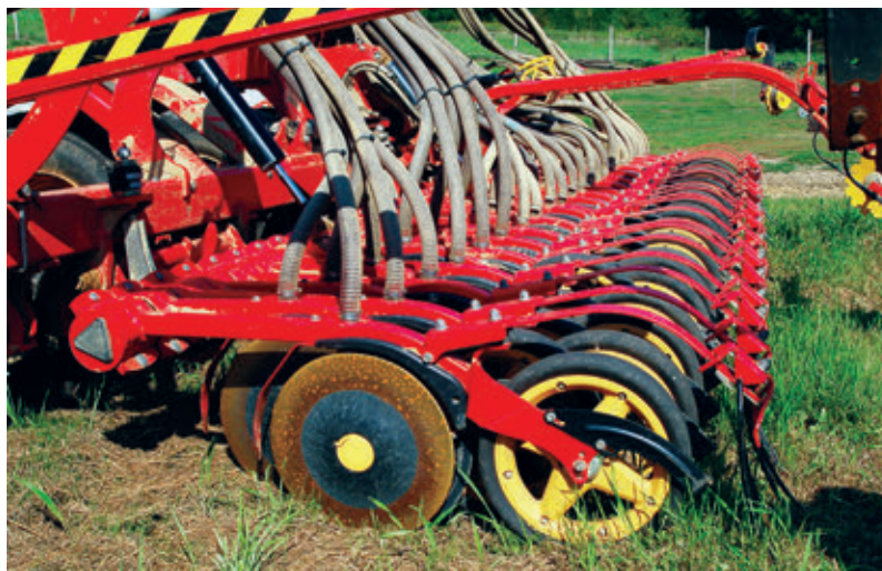
A nagy sebességű vetés pontosságának érdekében a Spirit vetőgépet nagy átmérőjű vetőtárcsákkal szerelte a Väderstad
