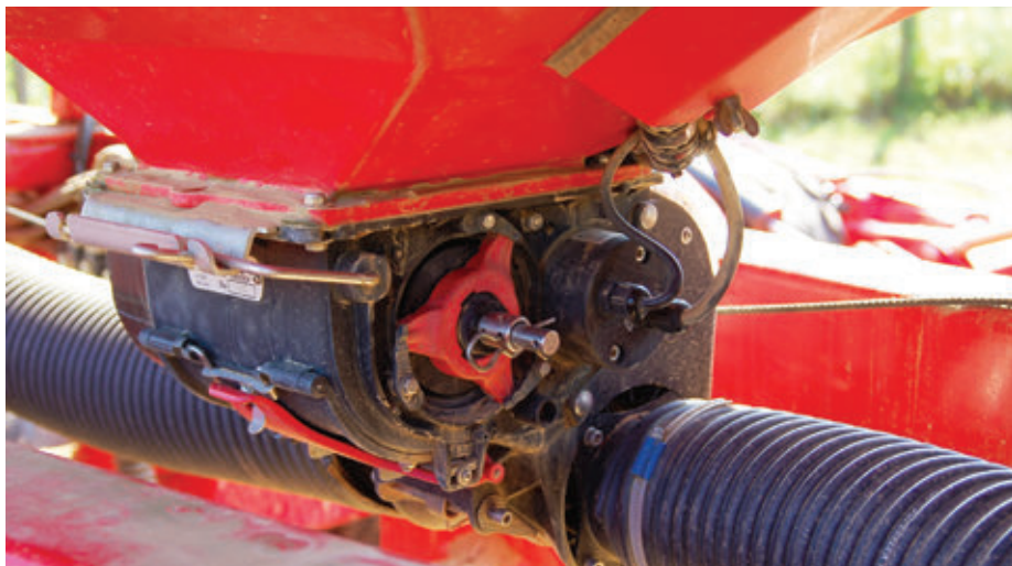
A magtartály alján lévő rács megakadályozza a nagyobb méretű szennyeződés rendszerbe jutását, míg az apróbb kavicsokat a Fenix rendszer sérülés nélkül továbbítja
