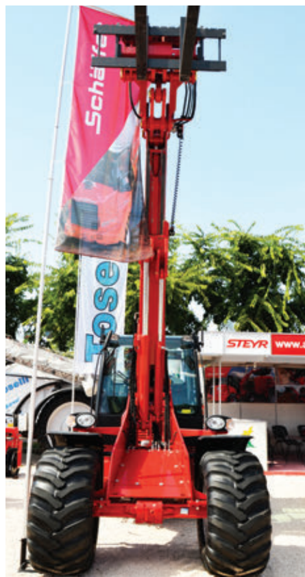
A hidrosztatikus rendszer egy időben teszi lehetővé az emelést és kitolást
