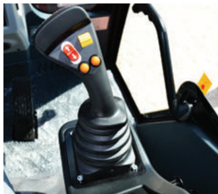
A joystick a karfába integrált, a légrugós üléssel együtt mozog
