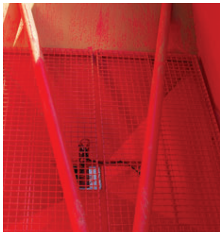
A magtartály alján lévő rács megakadályozza a nagyobb méretű szennyeződés rendszerbe jutását, míg az apróbb kavicsokat a Fenix rendszer sérülés nélkül továbbítja
