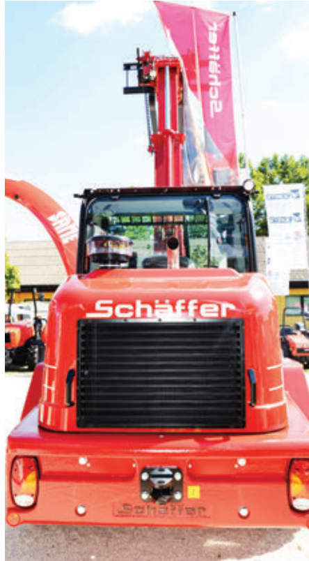
A gép hátulján elhelyezett ciklonszűrő előszűri a szennyezett levegőt
