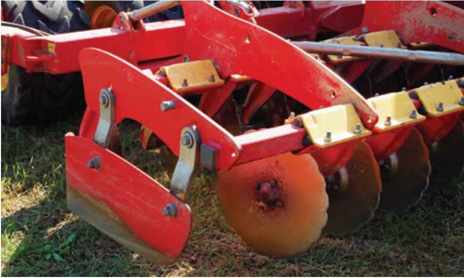
A Spirit 600S elején lévő két tárcsasorból álló művelőegységnek köszönhetően a magágykészítés a vetéssel egy menetben elvégezhető. A tárcsasorok két oldalán lévő terelőlemez nagy munkasebességnél is megakadályozza, hogy a tárcsalapok oldal irányba kidobják a földet
