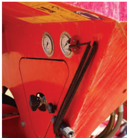
A magtartály fedőponyvájának rendkívül egyszerű, de ötletes a mozgatása zsinór és rugó segítségével
