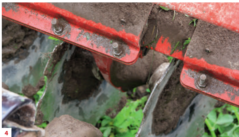
5 A szélső tárcsák és a csillagtárcsák gondoskodnak a két nyomvonal átfedés nélküli csatlakozásáról.
