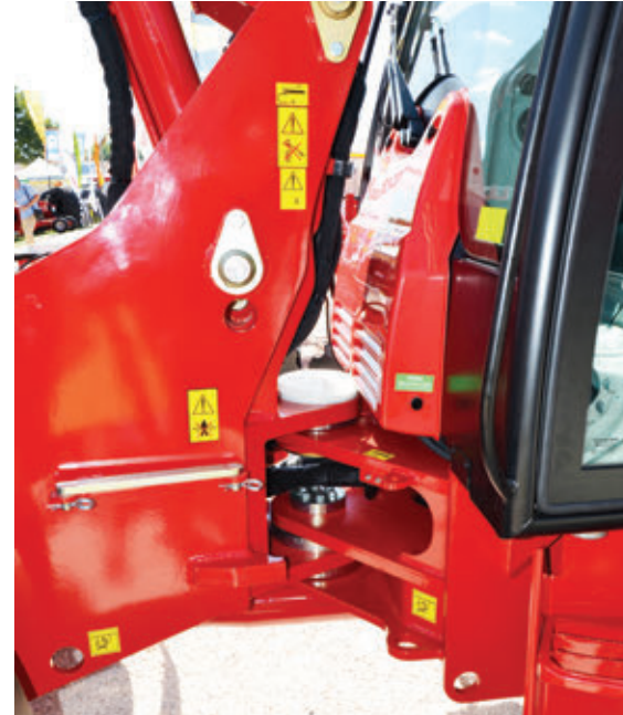
A Schaffer minden modellje törzscsuklós megoldással készül
