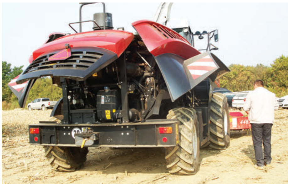
A Panther 500 silózó nyitható burkolatainaknak köszönhetően a karbantartás kényelmesen elvégezhető
