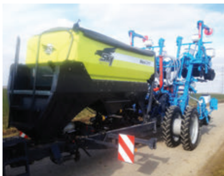
A 9 méteres vetőszerkezet hárompontfüggesztésen ül, így könnyen leszerelhető. A magtartály aztán műtrágyaadagolásra használható szemenkénti vetőgéphez
