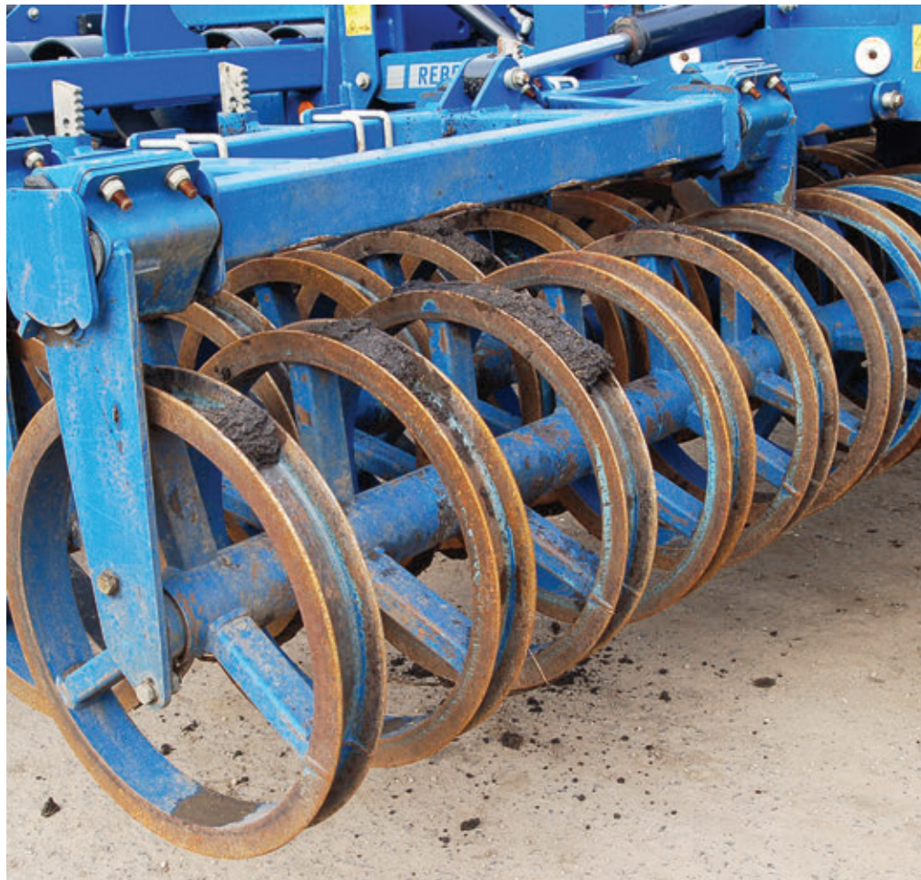
Az egymástól kissé eltolt, két sorban elhelyezett Dupla-STS-Henger U-profilja talajjal telik meg, ezáltal talaj tapos talajt, ami mindig elvállalja a hengertől
