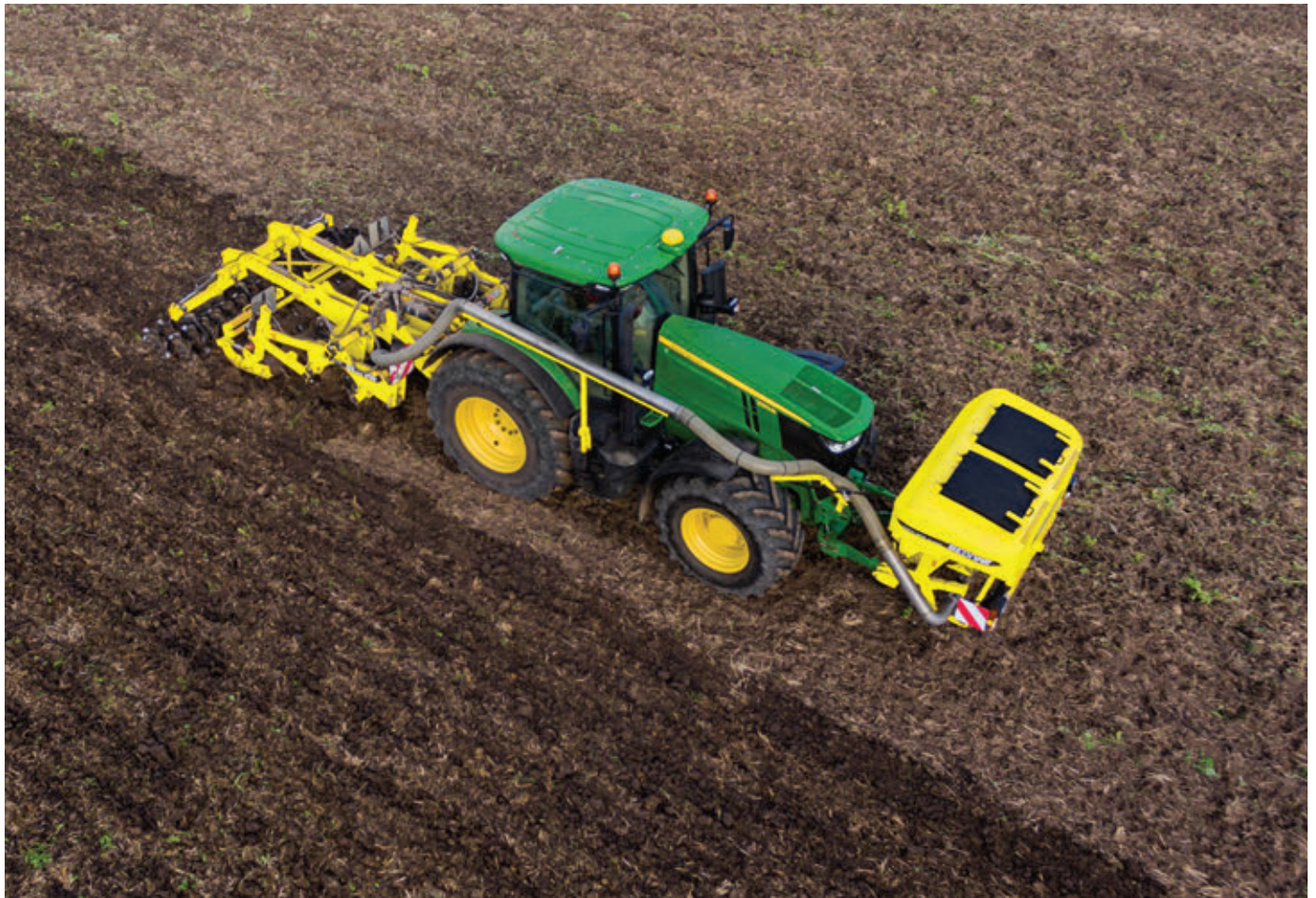
BEDNAR TERRALAND talajlazító és BEDNAR FERTI-BOX tartály kombinációja – a talajlazítással egybekötött lokális műtrágya-kijuttatás technológiája
