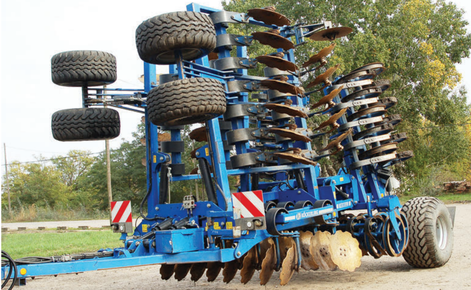
A KÖCKERLING REBELL profiline tárcsás borona szállítási szélessége 2,99, magassága pedig 3,7 méter
