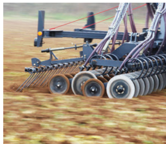
Minden körülmény között szavatolt a nagy sebesség és a 120 kg csoroszlyanyomás
