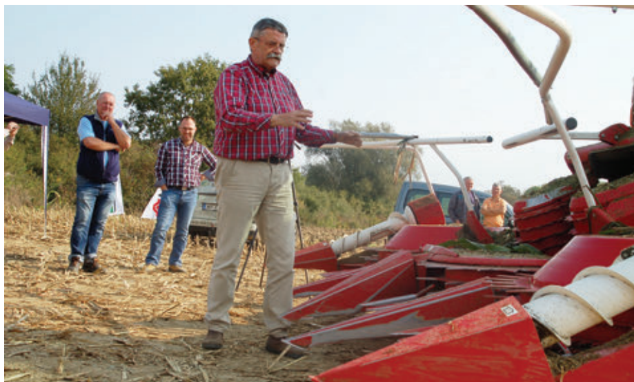
Az 5 méter munkaszélességű, sorfüggetlen, kiváló minőségű KEMPER adapter jól alkalmazható silókukorica, cirok, szudánifű vagy viaszérett gabona betakarítására is
