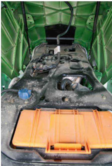
A narancssárga fedél alatt rejtőzik a levegőszűrő. Nem különösen jól hozzáférhető, de csak 1 500 óra elteltével kell cserélni
