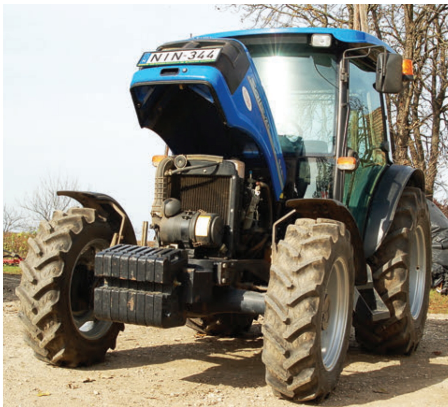
A négyhengeres, 3700 cm 3 -es turbófeltöltéses dízelmotor hagyományos adagolóval rendelkezik
