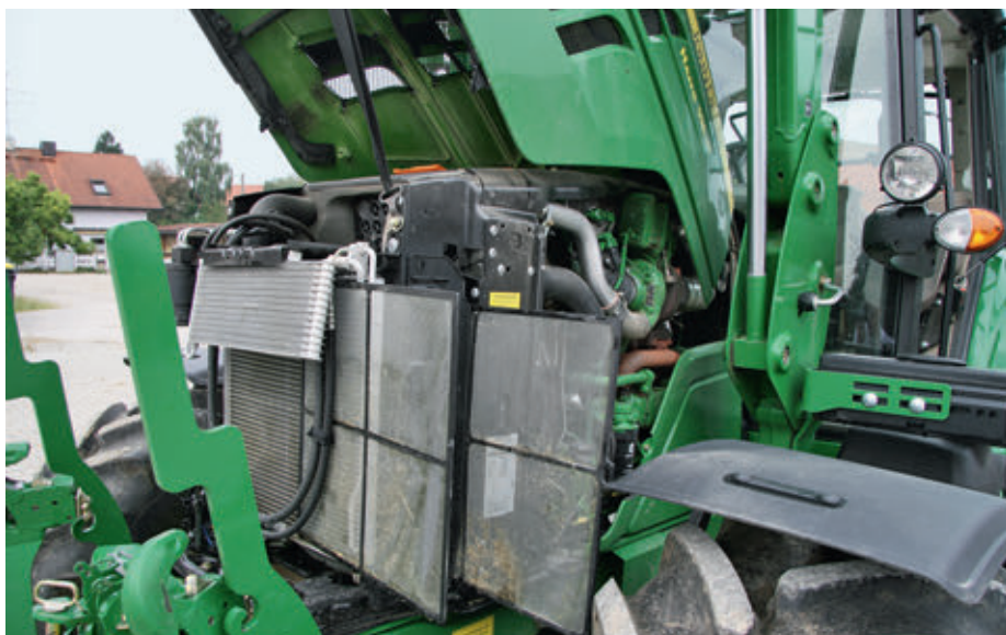
A jobb tisztítás érdekében a hűtő finomszövésű szűrővel van ellátva, így a szántóföldön is gyorsan el lehet távolítani a nagyobb szennyeződések
