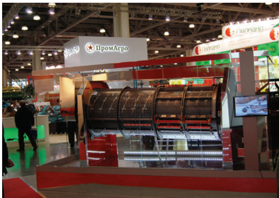
Több szerkezeti elem, köztük az axiálorotor működését is kiválóan szemléltette a Rostelmash az érdeklődők számára
