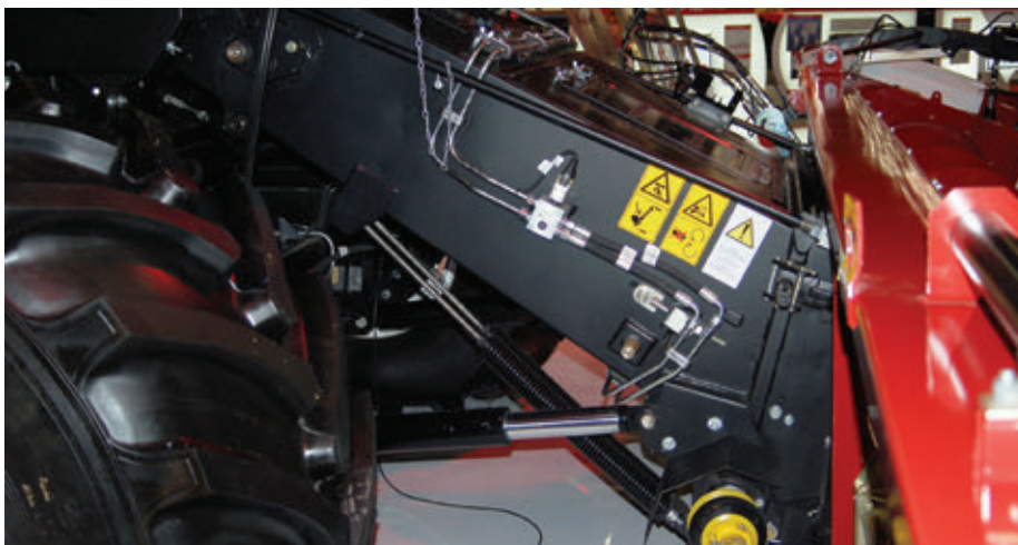
A NOVA hosszú, hagyományos láncos ferdefelhordója egyenletes terményáramot, emellett a gépkezelő számára jobb rálátást biztosít a munkaterületre
