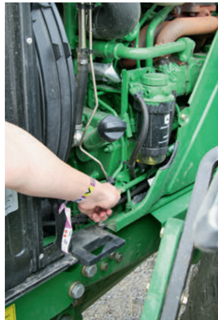
A napi karbantartást igénylő összes pont, itt pl. az olajszintjelző pálca, jól megközelíthető. Elég kinyitni a motorháztetőt
