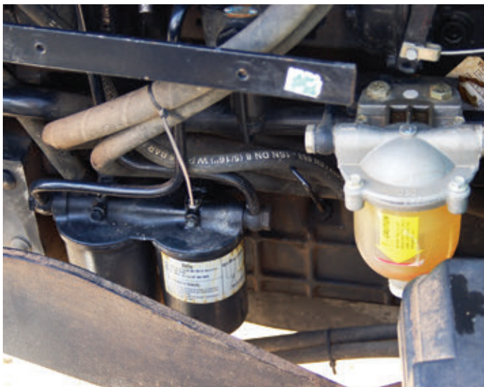
A szűrők és a karbantartási pontok jól hozzáférhető helyen találhatók
