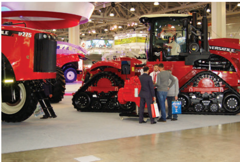
A Delta Track kiegyenlített felfekvésű, talajkövető kettős BOGIE hevederes futóművének köszönhetően nem lép fel görgő- és hevederkerék túlterhelés
