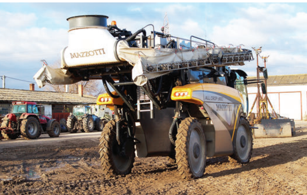
A légszák segítségével szabályozhatjuk a permetlé irányát
