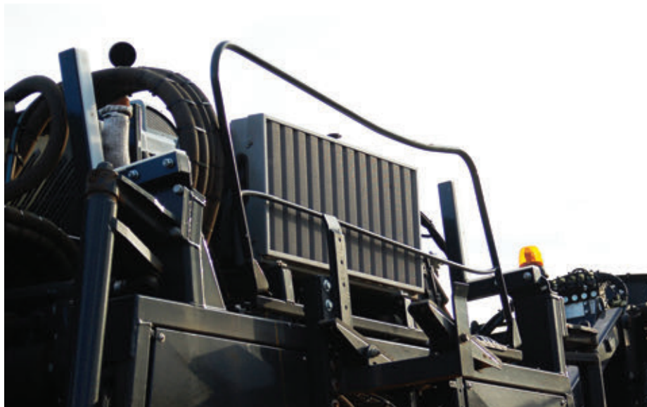
A motor kifordítható vízűtője egyszerűen tisztítható
