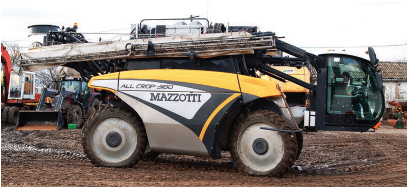
Mazzotti ALL CROP 3180 önjáró permetezőgép
