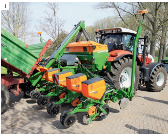
1 A műtrágyabetöltő csigával a szemenkénti vetőgép gyorsan megtölthető. A vetőmagtartályba két zsák tartalma fér bele
