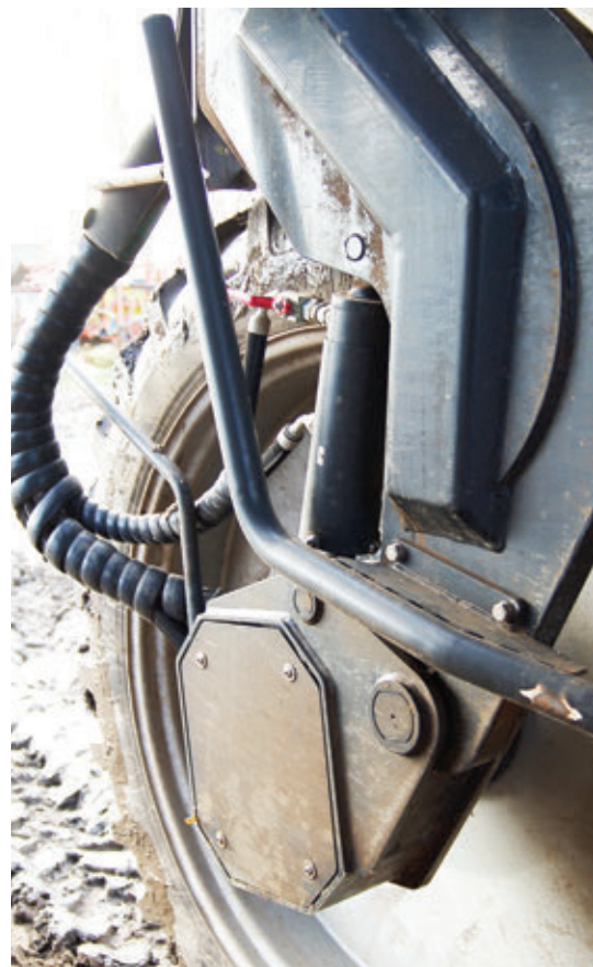
A 3180-as kerekei és meghajtóházai keskenyek, ezért nem döntik befelé sem a napraforgót, sem a kukoricát
