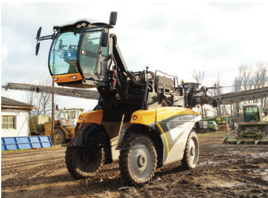
Az ALL CROP kabinjának magassága hidraulikusan állítható, egészen 3,35 méter magasságig
