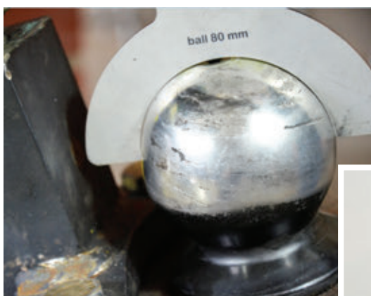
Egy megfelelő állapotú kalottával az ellenőrzőszerszám csak a két sarkán érintkezik, szemben a kopott elemmel, ahol a szerszám élének felületén zsírmaradványokat találunk
