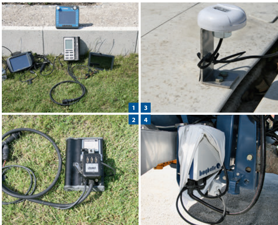
1 Sokféleség, ami tetszik: aki a Section Controltal kíván dolgozni, annak a Calibrator Zurf terminál mellett szüksége lesz egy ISOBUS számítógépre (fent), egy tablet PC-re (jobbra), vagy egy GPS sorvezetőre (pl. Teejet Matrix Pro 840 GS, balra) 2 A GPS antenna segítségével a számítógép meghatározza a pozíciót, és eldönti, hogy a műtrágyaszóró végezzen-e szórást 3 Az iZurf modulon keresztül a tablet és a Bogballe vezérlőterminál kapcsolatba kerül egymással, és adatokat cserél. 4 Az ISOBUS Controller segítségével a Bogballe minden ISOBUS-terminállal vezérelhető. Nálunk ez Plug and Play megoldással, probléma nélkül működött
