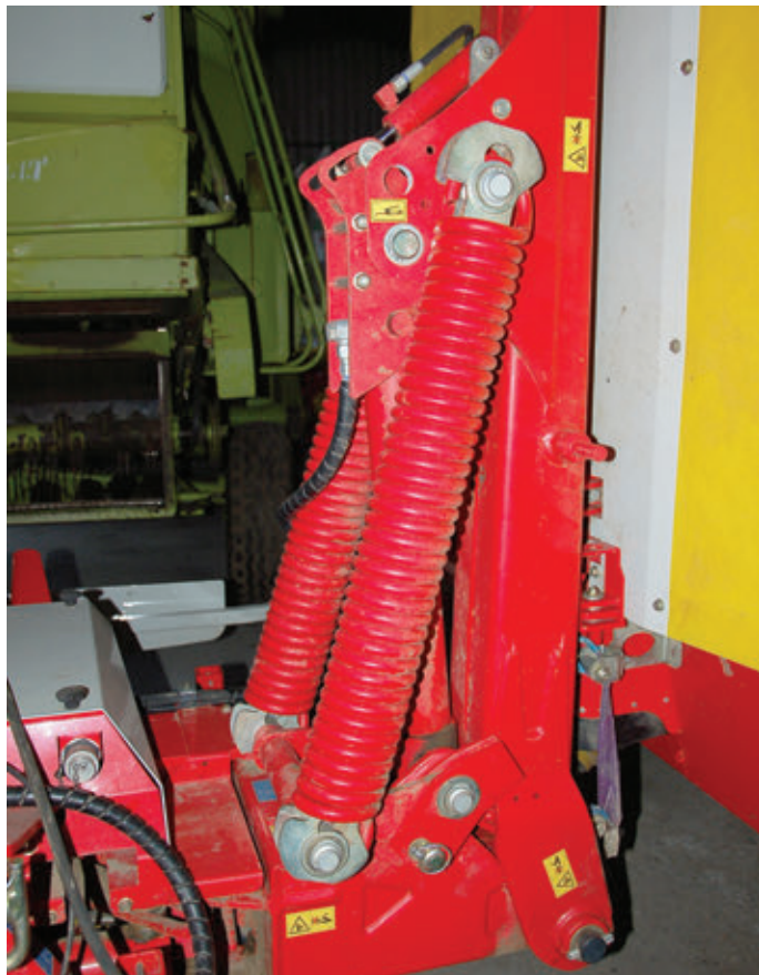
A két hátsó fűkasza talajterhelése két-két nagy rugóval állítható. A feszesség csapok áthelyezésével számos fokozatban a terepviszonyhoz igazítható
