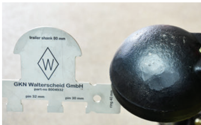
Egy megfelelő állapotú kalottával az ellenőrzőszerszám csak a két sarkán érintkezik, szemben a kopott elemmel, ahol a szerszám élének felületén zsírmaradványokat találunk
