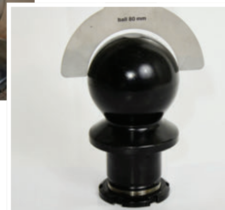
A golyót és a kalottát is mindig a haladási irányban kell ellenőrizni! Amennyiben a szerszám éle felfekszik a golyó felületére (bal oldali kép), úgy a golyó kopott és cserélni kell. A jobb oldali képen egy megfelelő állapotú golyó látható
