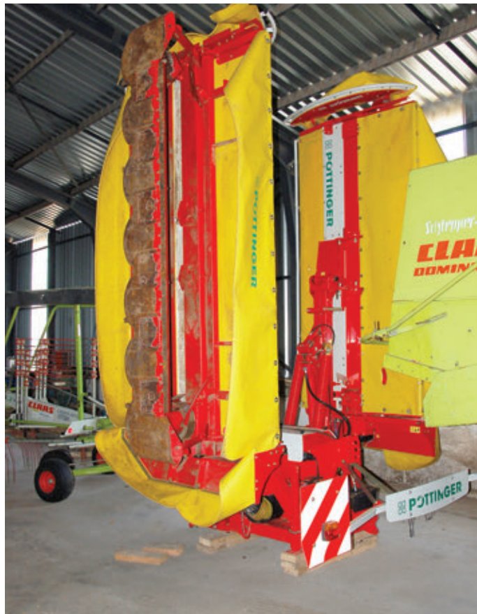
A hátsó kasza magassága szállítási helyzetben mintegy 4,2 méter, emiatt vonuláskor ügyelni kell az esetenként szabványosnál alacsonyabban elhelyezett telefonvezetésekre
