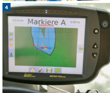
1 A műtrágyaszóró vezérlése a Calibrator Zurf terminállal egyszerű. A kijelzőn minden fontos információ megtalálható
