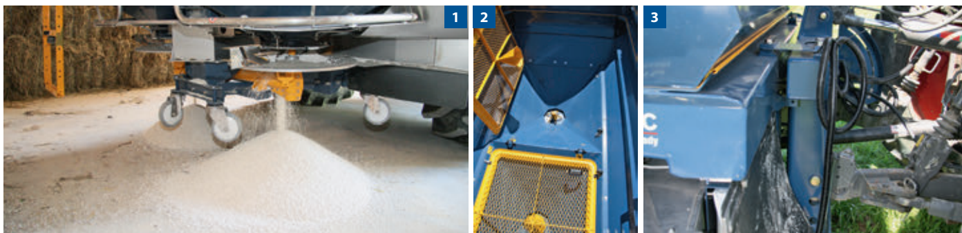
1 A maradék mennyiség kiürítéséhez a röpitőtárcsából két kis rész kiszerezhető. Ezután már csak a nyílásokat kell a kifolyó alá fordítani 2 A védőrácsokon lehet közlekedni, és az esetleges eltömődések eltávolítása érdekében ezek felhajthatók 3 Dupla váz, melyek között két mérőcella van a súlymérős szóróknál
