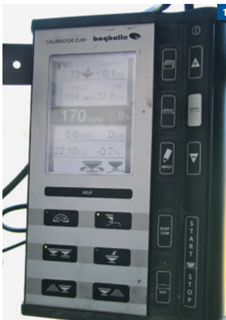
1 A műtrágyaszóró vezérlése a Calibrator Zurf terminállal egyszerű. A kijelzőn minden fontos információ megtalálható
