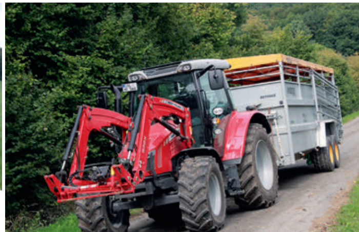
A mi tesztgépünkön a lehetséges hat hidraulikacsatlakozásból négy volt felszerelve. Kettő a homlokrakodóhoz és két mechanikus hátul. Az 540, 540E és az opcionális 1 000 TLT fordulatszámmal sokoldalúan kipróbáltuk a traktort
