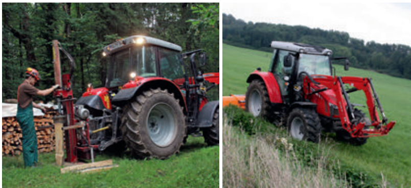
A mi tesztgépünkön a lehetséges hat hidraulikacsatlakozásból négy volt felszerelve. Kettő a homlokrakodóhoz és két mechanikus hátul. Az 540, 540E és az opcionális 1 000 TLT fordulatszámmal sokoldalúan kipróbáltuk a traktort
