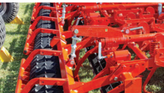
A hátsó hengerek helyzete egymáshoz képest állítható
