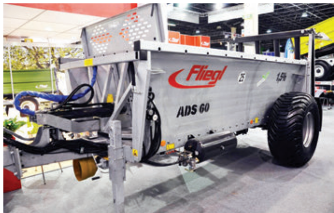
Az év magyar mezőgépe 2017 díjat a Fliegl Abda Gépgyártó Kft. által gyártott ADS-60 típusjelű, egytengelyes, letolólapos (push-off) rendszerű kisüzemi szerves trágyaszóró érdemelte ki
