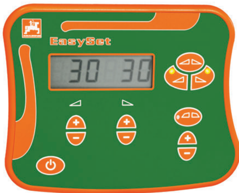
Az EasySet fedélzeti számítógép segítségével az adagolónyílásokat a bal és jobb oldalon egymástól függetlenül lehet beállítani, és haladás közben utánállítani
