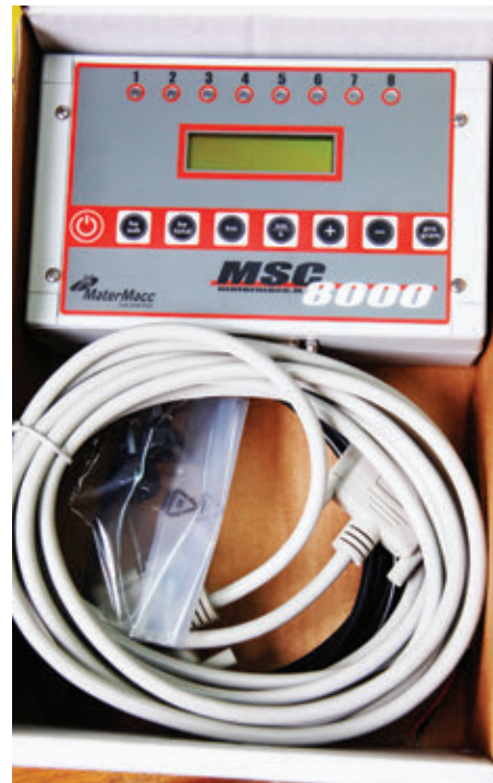
A 8130-as vetőgép monitorján LED lámpa segítségével ellenőrizhető a sorok vetése
