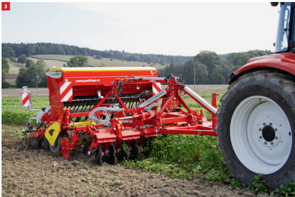
1 A mélységállítást végző henger lengéscsillapításra is szolgál, így a Terradisc nagyon nyugodt járású
