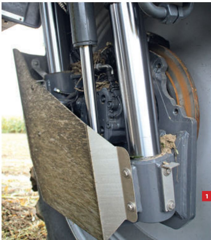
1 A kerékagymotorok vezetőlemezek mögött, védetten helyezkednek el, a szériagyártásig még javítanak a jelenlegi megoldáson
