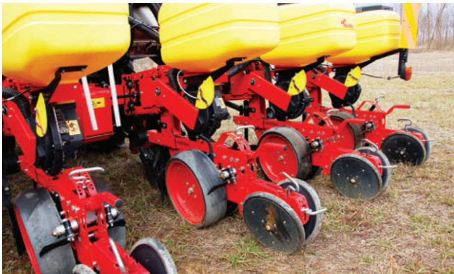
A paralelogramma felfüggesztésű vetőkocsik talajellenállása egy mozdulattal, könnyedén beállítható
