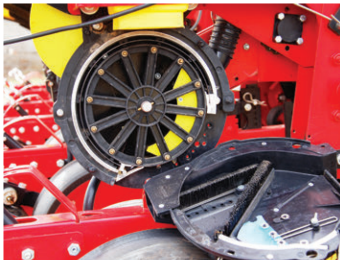
A szabadalmaztatott MAGICSEM vetőház átszerelése egyik kultúráról a másikra gyorsan elvégezhető, a kefesor pedig folyamatosan tisztán tartja a vetőtárcsát
