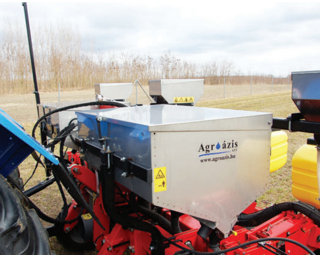
Az MS 8130-as vetőgép kétszer 215 liter kapacitású műtrágyatartálya opcionálisan 800 literre növelhető. A szabadalommal védett Vario Volumex műtrágya adagoló fokozatmentesen állítható
