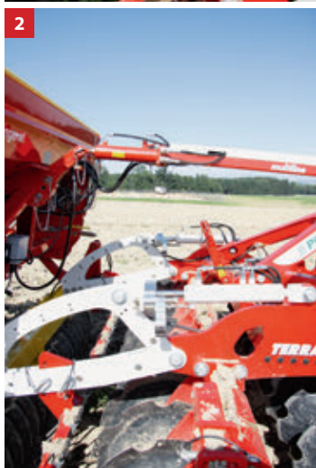
1 A mélységállítást végző henger lengéscsillapításra is szolgál, így a Terradisc nagyon nyugodt járású
