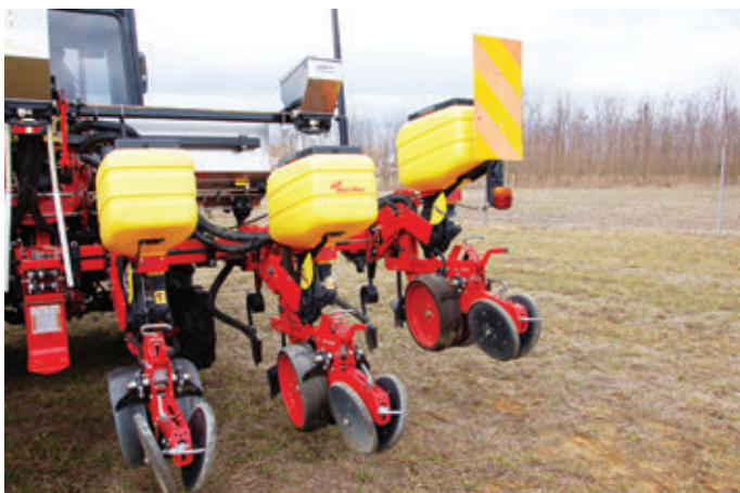
Dupla sortávolságú vetéskor minden második sor kiiktatásával nincs a vetéshajtásnak felesleges ellenállása, és a nem használt vetőkocsik sem kopnak
