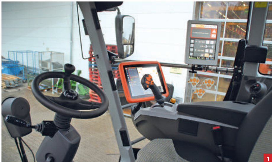
2 Az AmaDrive érintőképernyős monitor teljes áttekintést ad a legfontosabb adatokkal
