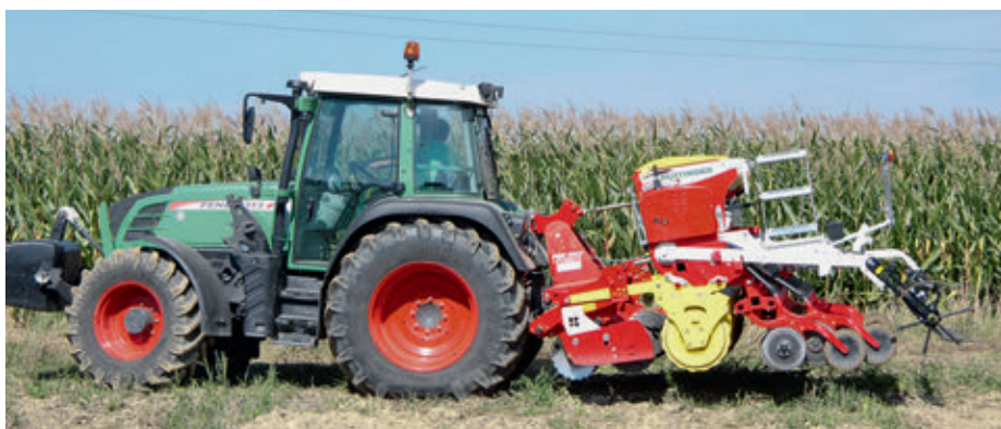
A rövid kombinátor alig hosszabb egy forgóboronánál. A 850 kg ballaszt súllyal ellátott Fendt 313 Vario traktor emelőereje bőven elegendőnek bizonyult
