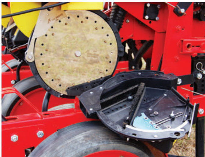
A szabadalmaztatott MAGICSEM vetőház átszerelése egyik kultúráról a másikra gyorsan elvégezhető, a kefesor pedig folyamatosan tisztán tartja a vetőtárcsát
