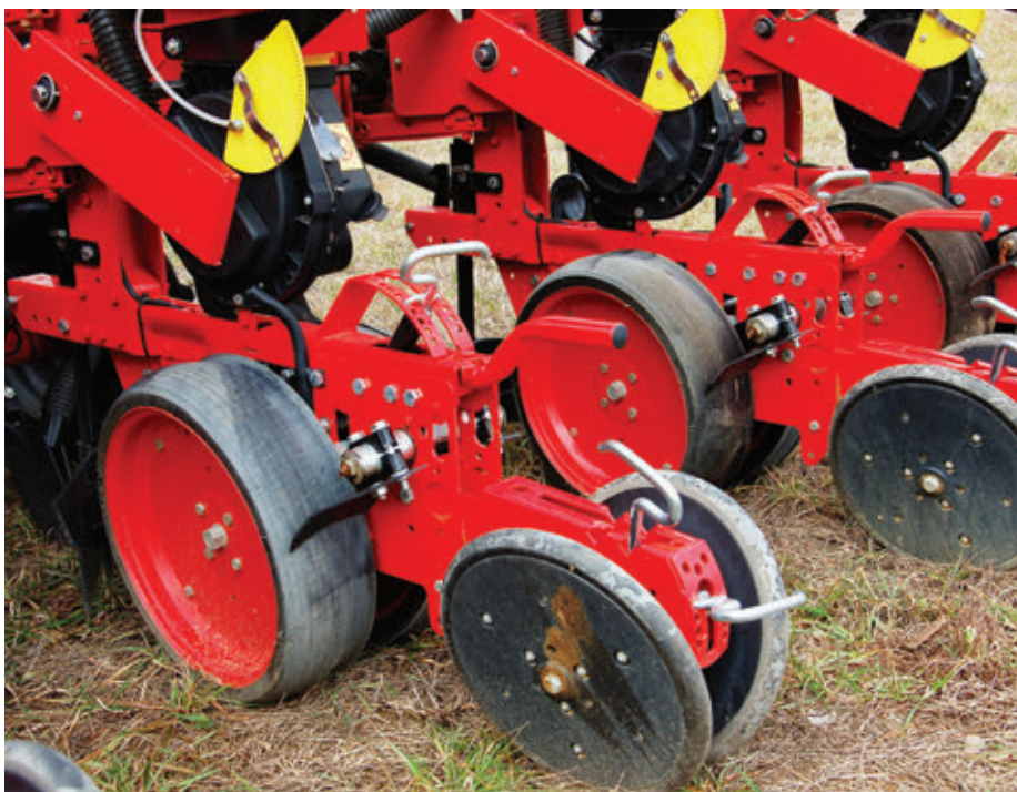
A vetőkocsi oldalsó kerekei a talajtól függően függőleges mozgást végeznek, ezáltal a vetésmélység állandó
