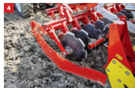
4 Az oldalsó terelőlemezek megakadályozzák a bakhátképződést. A külső tárcsákat közüti szállításhoz felhajtják
