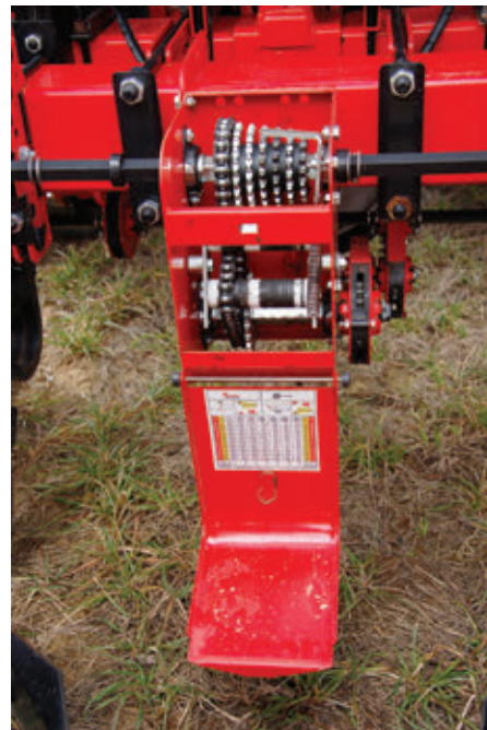
A műtrágya vagy mikrogranulátum kijuttatásának dózisa a beállító karral elvégezhető. Extrém nagy kijuttatandó mennyiség – a táblázat alapján – a lánckerék áttételének változtatásával állítható be
