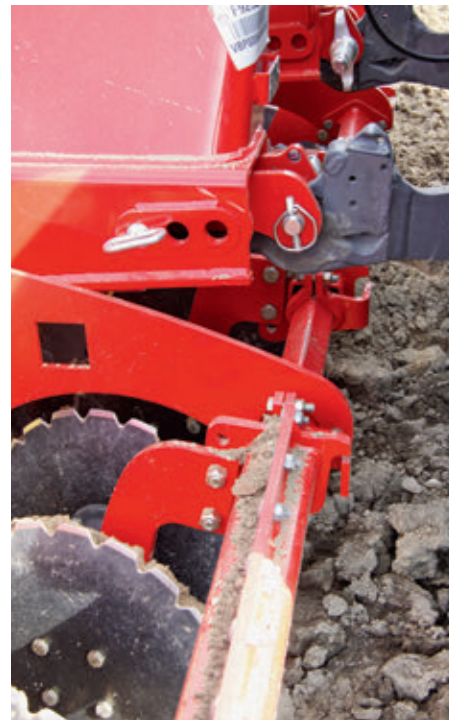
A nyomvonalakon haladó tárcsaelemek egy furatlemez segítségével leengedhetők, így a nyomvonalakba is elegendő föld jut
