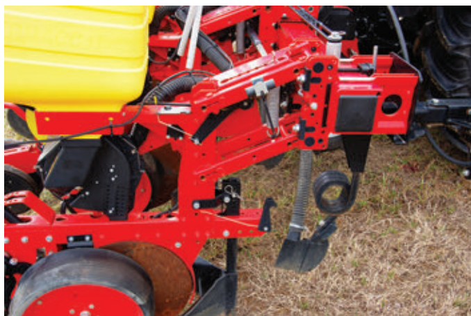
Dupla sortávolságú vetéskor minden második sor kiiktatásával nincs a vetéshajtásnak felesleges ellenállása, és a nem használt vetőkocsik sem kopnak
