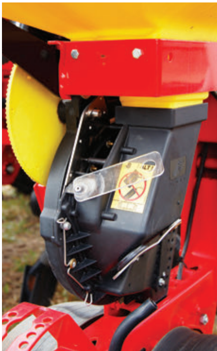
A kémlelőnyílás és a magleeresztő is egyszerűbbé teszi a munkát
