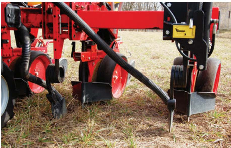
A késes csoroszllya, rugós kialakítású tartójának köszönhetően, jól alkalmazkodik a különféle talajviszonyokhoz és a szármadarványhoz
