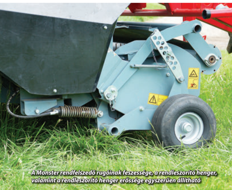
A rendfelszedő előtt található leszorító henger egyengeti, szétteríti a rendet
