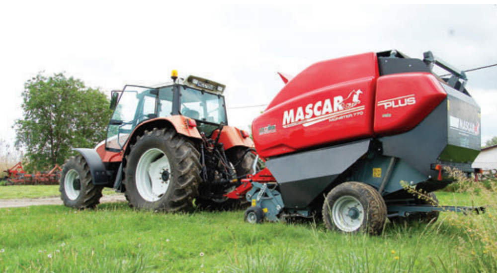
A nagyteljesítményű Mascar Monster Cut 770 Plus változókamrás balázó
