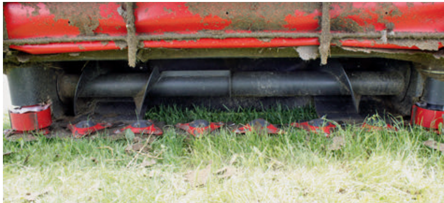
A csiga a gép közepe felé továbbítja a levágott takarmányt
