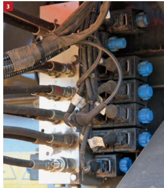
3 A hajtásokhoz tartozó elektronika és hidraulika egy helyen található, ami megkönnyíti a karbantartást
