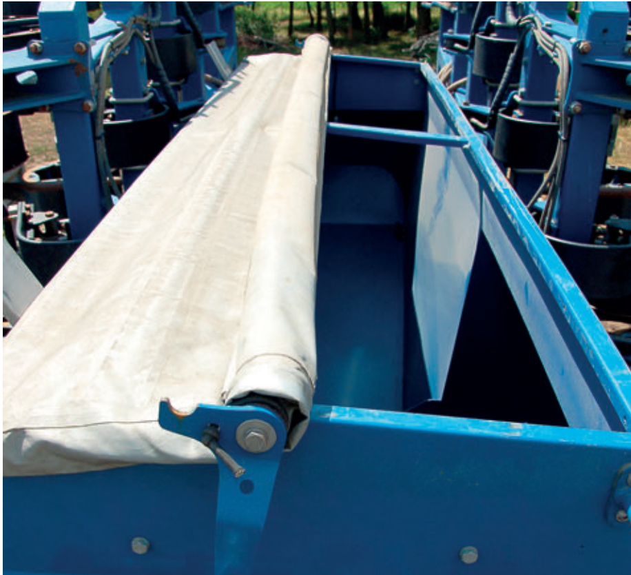
Az Ultima CS hosszanti elrendezésű magtartályának jól záró ponyvája könnyen csukható és nyitható
