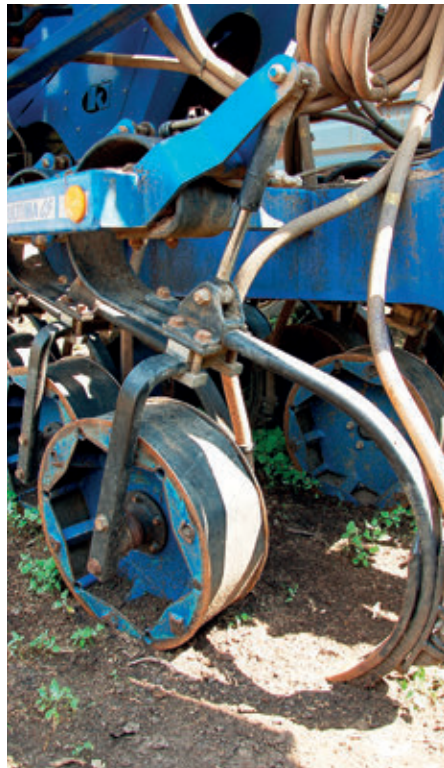
A késes vetőcsoroszlya vetésmélysége hidraulikusan állítható
