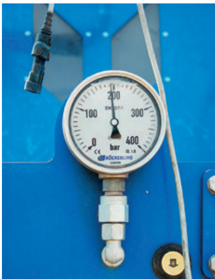
A vetésmélység beállítását segítő nyomásmérő értéke a traktorfülkéből is jól látható
