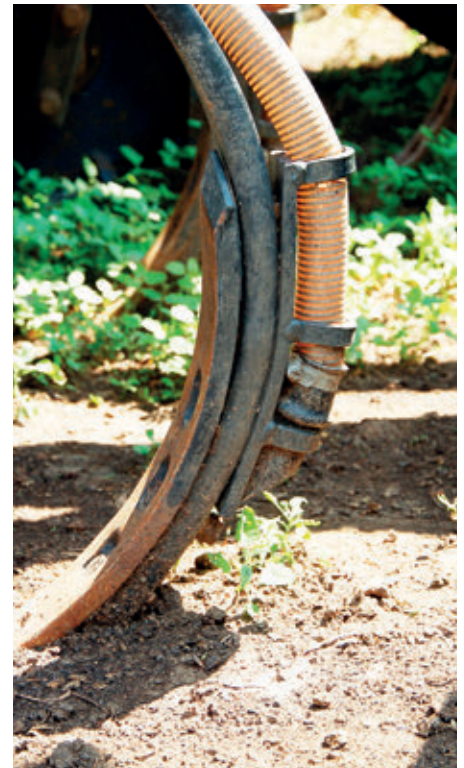
Pontos vetőmag lehelyezés késes vetőcsoroszlyákkal
