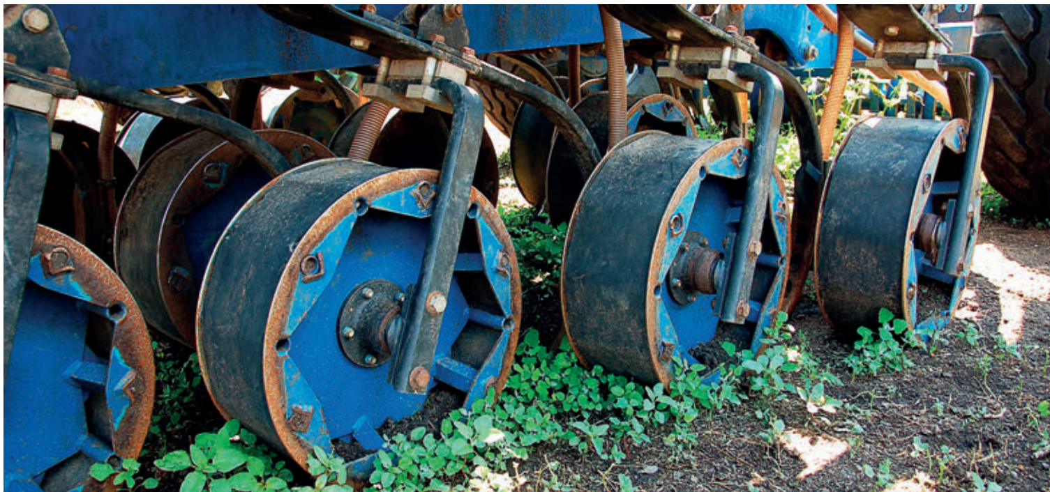
A végtelenített gumihevederrel szerelt támasztőhengerek még igen nedves és tapadós talajon is tiszták maradnak
