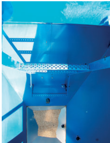
A magtartályba lejutást létra könnyíti meg
