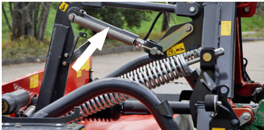
Egyszeres működésű hidraulikus henger (nyíl) emeli meg a vágószerkezetet gyorsan a fordulóban. Ha a kaszagerendely felfekszik a gyepszőnyegre, akkor a hidraulikus henger szabadon mozoghat anélkül, hogy a vezetékeken keresztül olajnyomás lépne fel. A nagy tehermentesítő rugókat csak szerszámmal lehet beállítani
