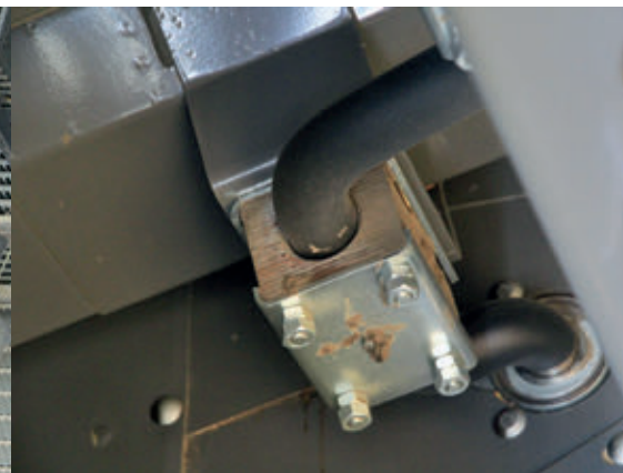
A facsapágyon 800 ha learatása után nem látszott nagy kopás
