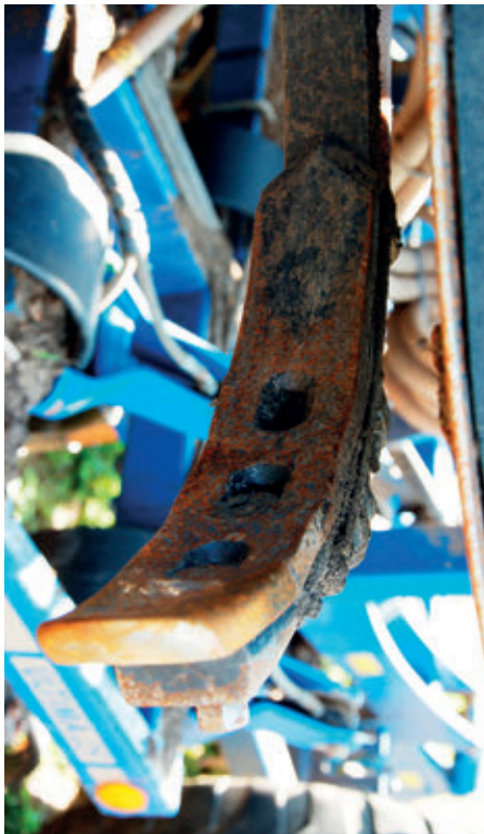
Az Ultima CS kapái megfordíthatóak, így ritkábban igénylik a cserét
