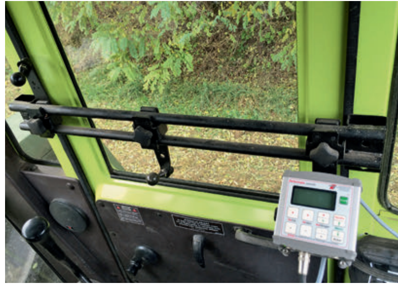
A jobb oldali fülkeajtóra szerelte fel Maik a terminálok tartóit – ezt sajnos nem teljesen lehetett fűrés nélkül megúszni
