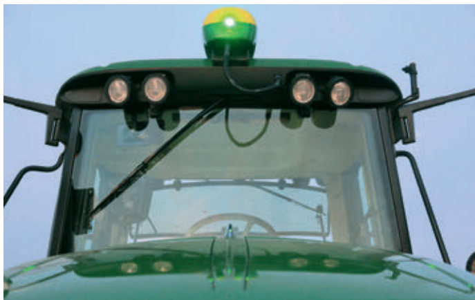
6195M: A vezetőfülke szűkebb és rövidebb felépítésű, gyárilag csak halogén munkafényszórók kaphatók
