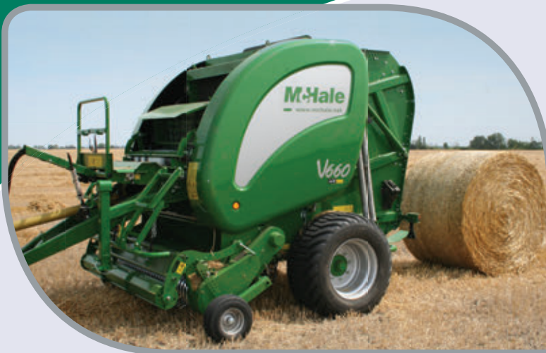
15 késes változókamrás körbálázó professzionális vezérléssel
