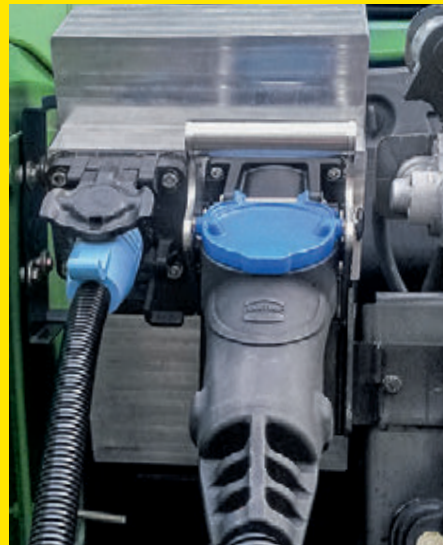
A Fendt e100 két AEF-konform csatlakozóhellyel rendelkezik, ami alkalmas az elektromos függesztett munkagépek meghajtására
