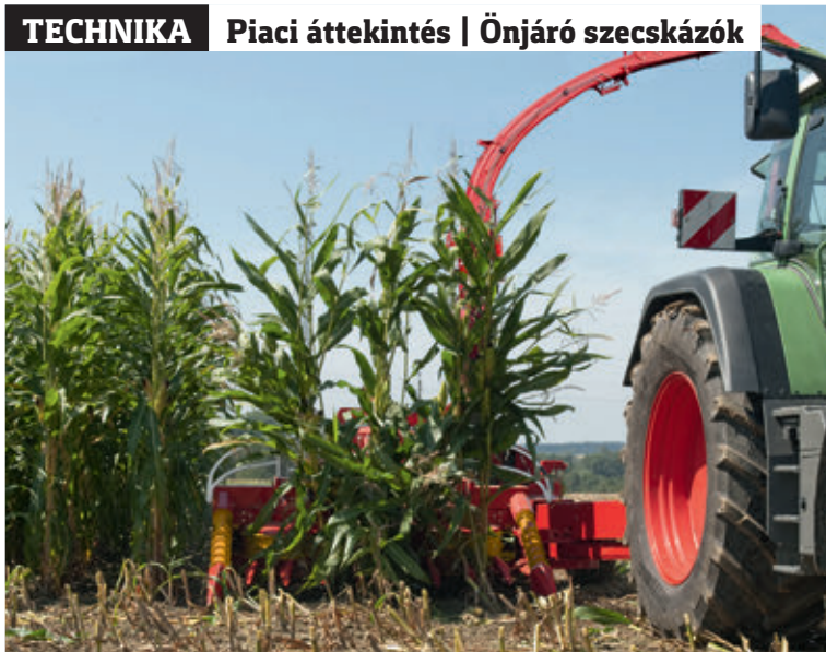
VONTATVA: vontatott tárcsás szecskázó halad a traktor nyomvonalával mellett. Pl. a Pöttinger programjában található ilyen szecskázót
