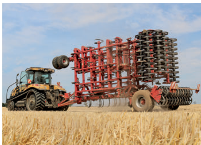
GYAKORLATI TESZT: Horsch Cruiser 12 XL – a piacon jelenleg kapható legnagyobb rugós kapákkal felszerelt szántóföldi kultivátor
