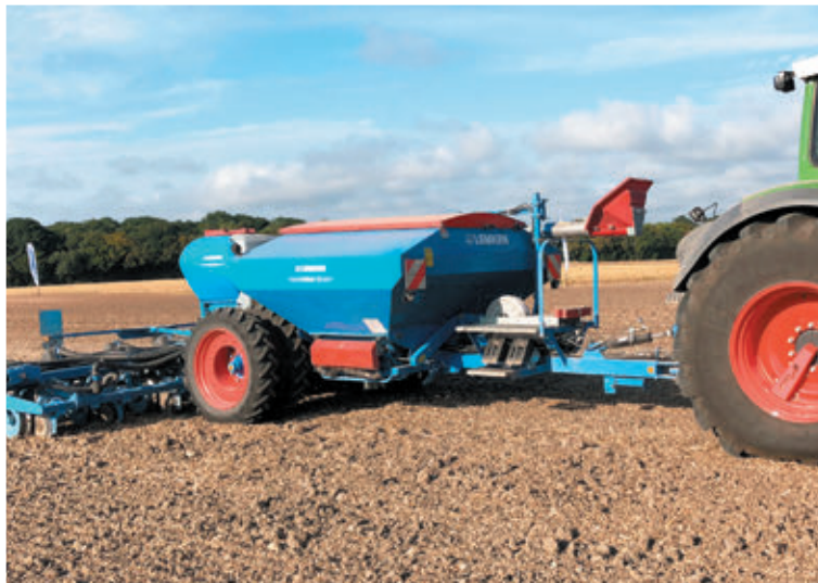
A tartály űrtartalma 5800 liter, amely akár 60 hektár napi területteljesítményt is lehetővé tesz
