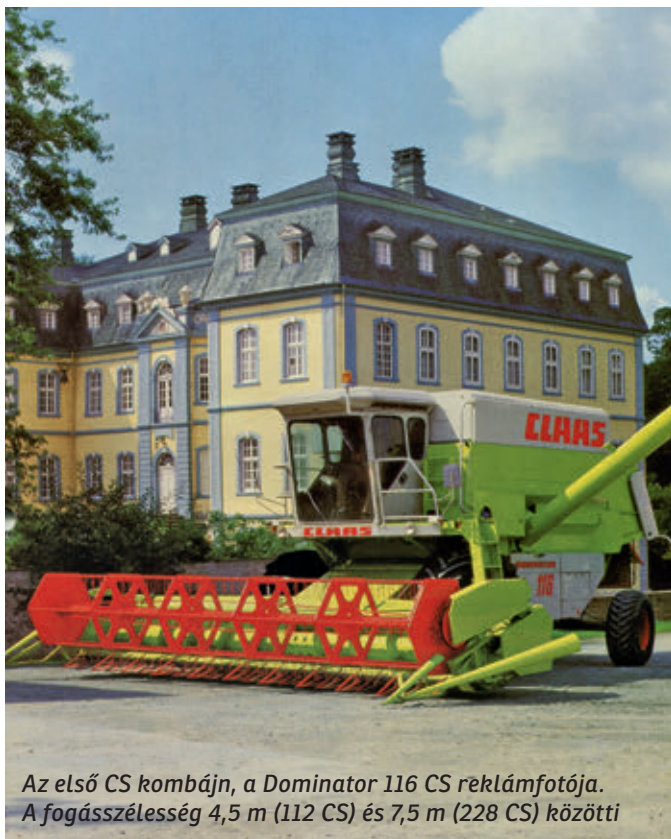
A nyolc szalmaleválasztó henger előtt egy 1,32 m, illetve 1,58 m széles és 450 mm átmérőjű cséplődob dolgozott. A hengerek fordulatszáma 430, 540, 650 és 810 u/min között variálható
