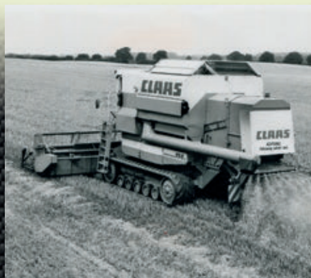
1990-ben érkezett a 116-os, valamivel később a 228 Mobiltrac változata, gumihevederes járószerkezettel
