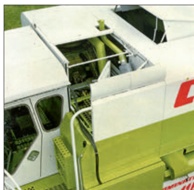
A motorok a vezetőfülke és a magtartály között helyezkedtek el. Az üzemanyag-fogyasztást a felhasználók gyakran sokallják, de értékét mindenkor a teljesítmény függvényében kell vizsgálni
