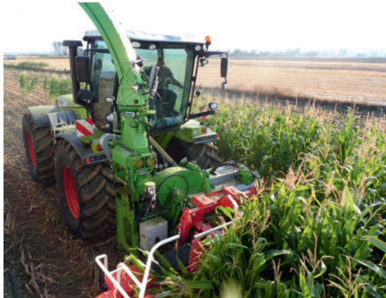
TOLVA: a hátrameneti berendezéssel rendelkező széles szecskázók hátsó függesztéssel akár 2 ha/h területteljesítményt is el tudnak érni
