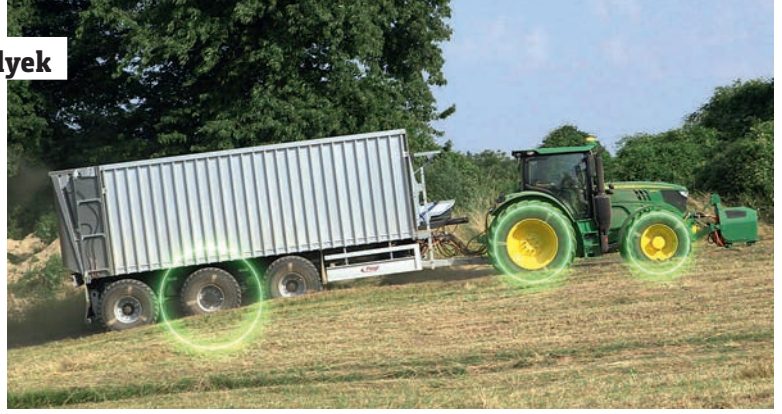
A Fiegl egy beépített áramgenerátor energiáját használja, ami egy állítható nyomatékú elektromotort táplál
