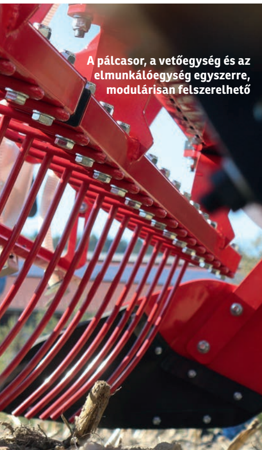
Az automatikus elmunkálóegység dőlésszöge mechanikusan, egy orsó segítségével állítható
