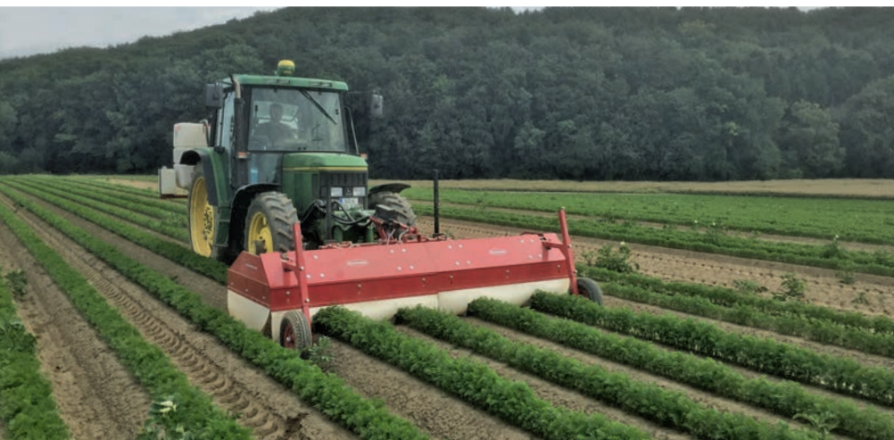
A saját építésű sávos sorpermetező munka közben a sárgarépa-kultúrában
