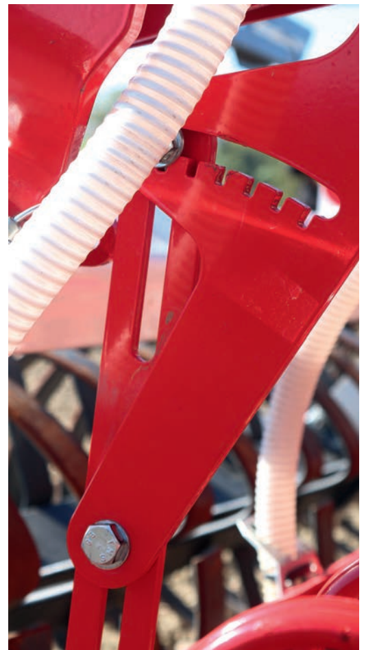
Ugyanígy rugalmasan állítható az opcionálisan választható vetőelemek magassága és dőlésszöge
