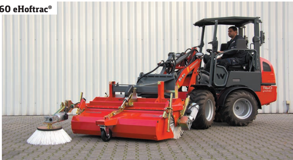
e20 koncepciótanulmány: a hidraulikát közvetlenül a seprőgépen cserélik fel elektromos hajtással
