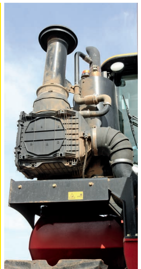
A kipufogógáz-tisztítás AGR/EGR-, valamint DOC-rendszerrel és SCR-katalizátorral működik
