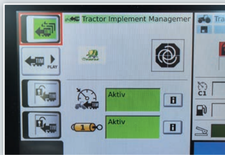
A traktor oldaláról aktiválni kell a megfelelő hidraulikacsatlakozót
