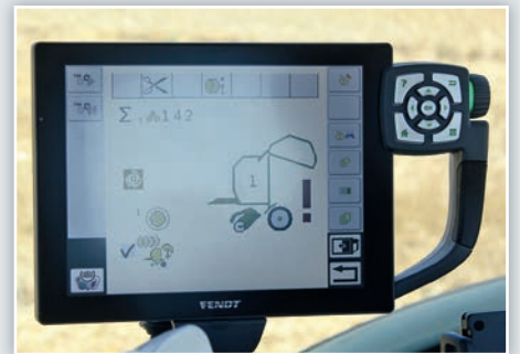
A bálakamra nyitott hátsó fedele látható a terminálon
