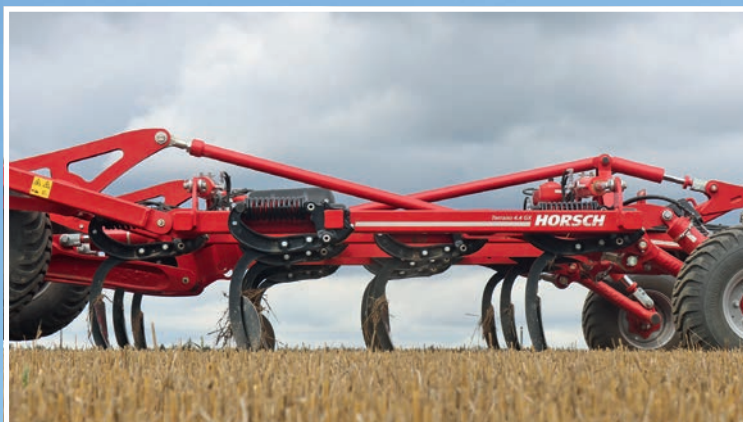
A négy gerendelyre osztott kialakítás miatt azonban a menetirányban egymást követő kapák távolsága lényegesen nagyobb
