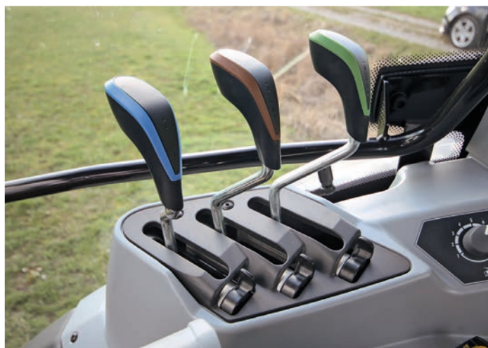
A három hátsó hidraulikacsatlakozó mechanikusan vezérelhető
