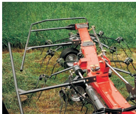
Néhány gyártó elfordítható keretszögmeneket kínál a széleken történő rendterítéshez
