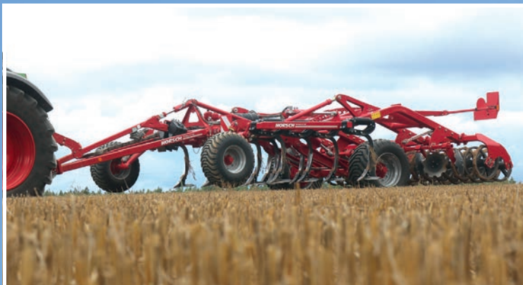
A Terrano 4.4 GX ezzel szemben 9,40 m hosszú, és a dupla gumikerekes tömörítőhengerrel együtt 5300 kg tömegű. A járószerkezet hátrébb helyezkedik el
