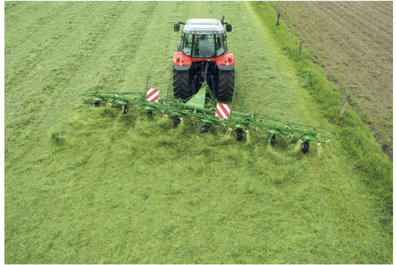
Ha a széleken végzett rendterítéshez a teljes gép elfordul, akkor belülre több anyag kerül. Előny: a rendszer mindkét oldalon működik
