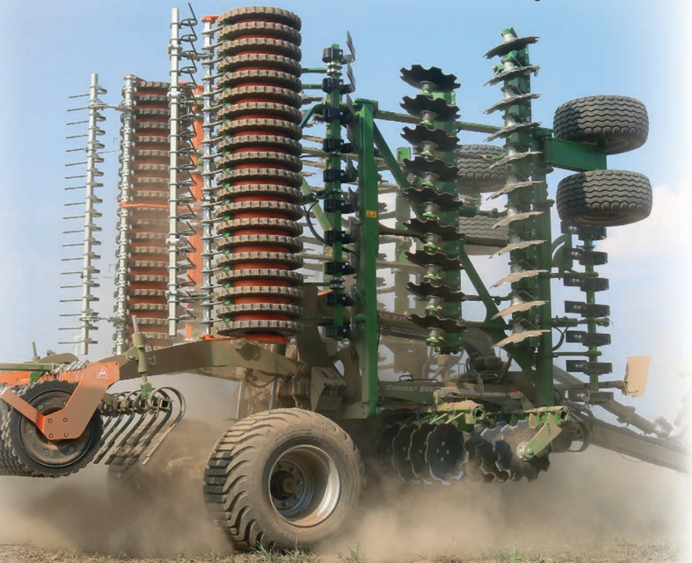
Összecukott helyzetben a Catros 3 m széles és közel 4 m magas
