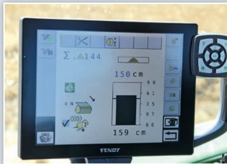
A bála elérte a megadott átmérőt – megkezdődik a háló adagolása
