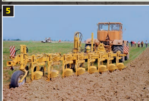
7 1983: 12 ekefejes B 540-es tarlóhántó eke két B 605-ös tömörítőhengerral teszt közben
