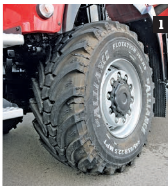
1 Elöl 445/65 R22.5, folyamatos vontatóbordákkal
