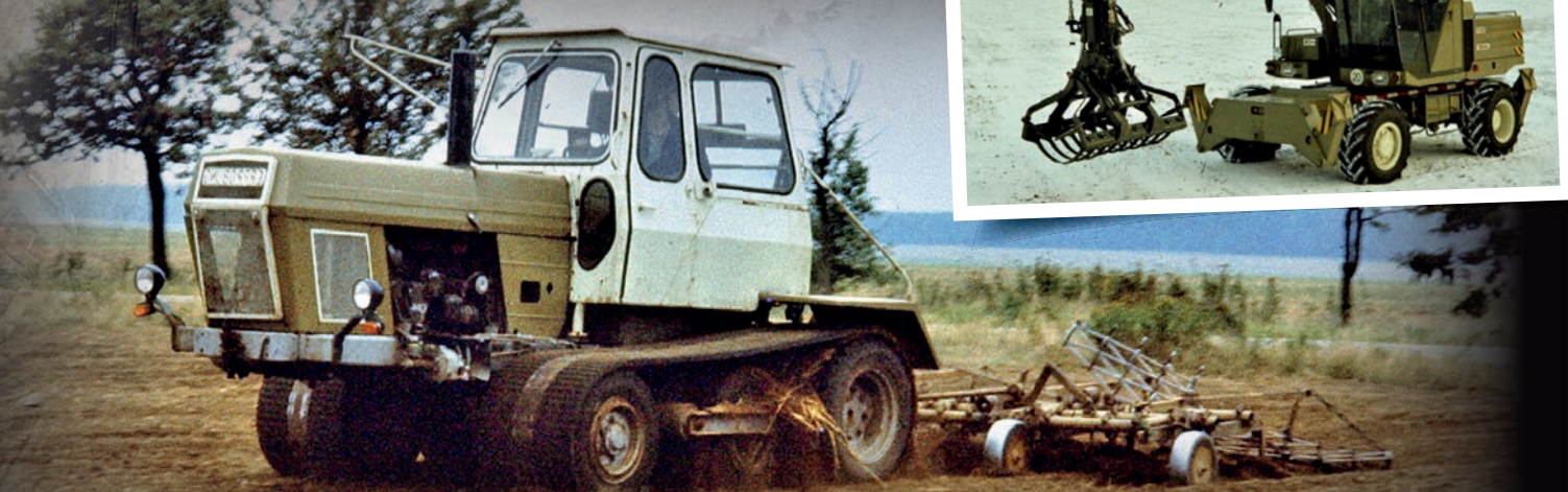
1976: Fortschritt ZT 300 GB traktor B 231 magágykészítő kultivátorral, közös fejlesztés a KFL Zerbst vállalattal. A gumihevederek bizonyultak a gyenge pontnak
