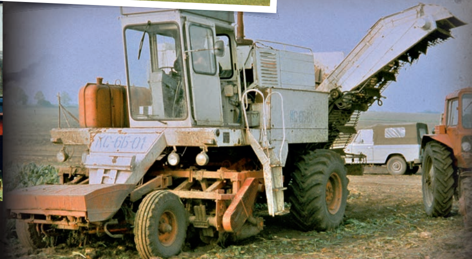
1980: a Ternopol KS 6 B cukorrépa-betakarítógép 6 soros felszedővel a tesztelés során
