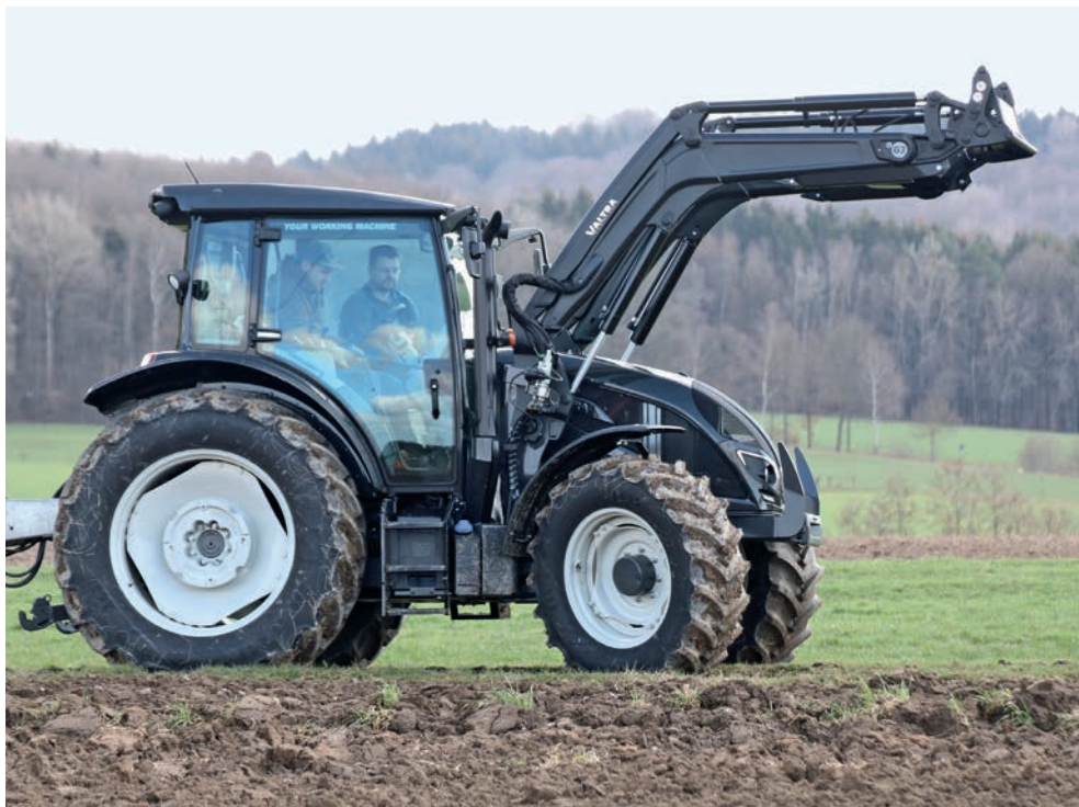
A kompakt méreteknél és a maximum 55 fokos aláfordulási szögnek köszönhetően a fordulási sugár alig több mint 4 m – ez nagyon jó egy kompakt traktor esetében
