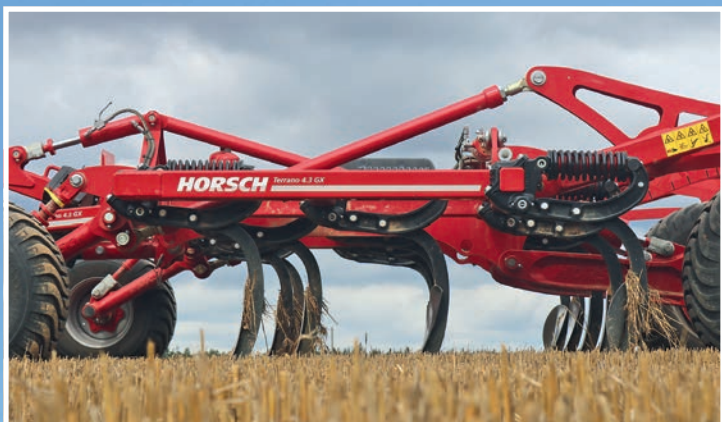
A 79,5 cm-es gerendelytávolság a Terrano 4.3 GX esetében megegyezik a hosszabb Terrano 4.4 GX gerendelytávolságával
