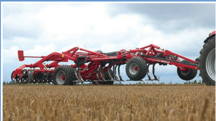
A Terrano 4.3 GX 8,61 m hosszú, és a dupla gumikerekes tömörítőhengerrel együtt 5050 kg tömegű
