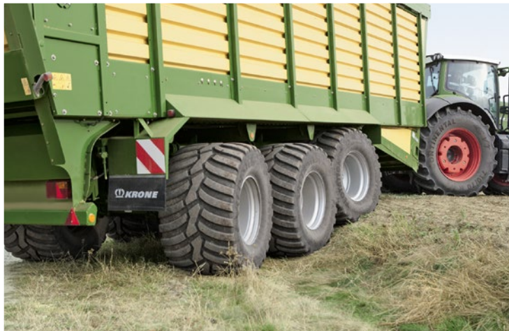
A magas szegélyek nem jelentenek problémát a szintkiegyenlítésrel rendelkező hidraulikus futóműnek – ennek megfelelően történik a szabályozás
