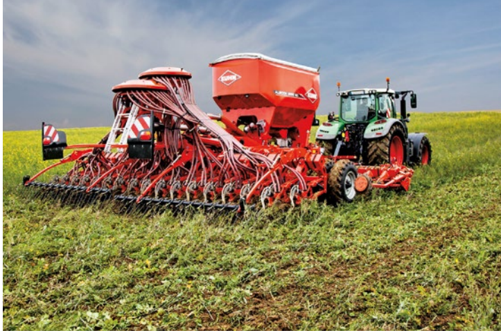
A Kuhn Aurock késes hengerekkel, vágótárcsákkal és duplatárcsás csoroszlyákkal dolgozik – ezáltal mulcsvetésre is alkalmas
