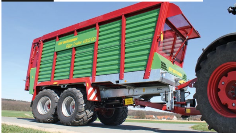
A kormányzott tengelyek megakadályozzák a hátsó gumiabroncspár „radirozását” – de a manőverezéshez blokkolni kell őket
