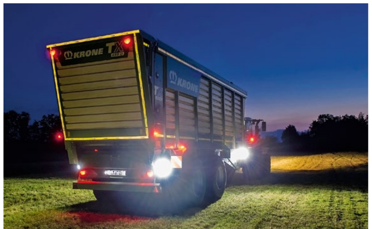
Az éjszakai jó láthatóság érdekében a silószállító kocsik fényszórókkal vannak felszerelve – LED-technológiával is
