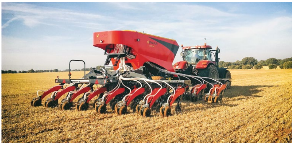
A Spanyolországból származó Virkar Ocean olyan forgócsuklóval rendelkezik, amelynek segítségével a hátsó csoroszlyásin kanyarodáskor követni tudja az elől lévő
