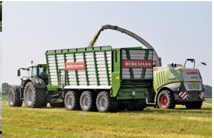
Nagy térfogatú silószállító kocsikra a nagy teljesítményű betakarítógépek mellett van szükség – nem csak a fűszilázs esetében
