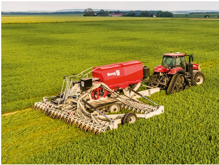
A Novag T-Force Plus modellje rendkívül nehéz felépítésű. 8,0 m munkaszélesség mellett 20 t üzemtömeg szerepel a katalógusban
