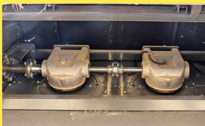
A hibrid gépekben a másodlagos leválasztáshoz két rotor dolgozik, amelyek kissé laposabban helyezkednek el a régi sorozathoz képest
