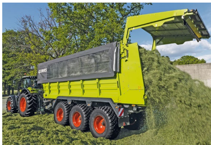
Az adagolóhengerek jobban eloszthatják a terményt a kirakodás során, így megkönnyítik a munkát a tömörítőjármű számára
