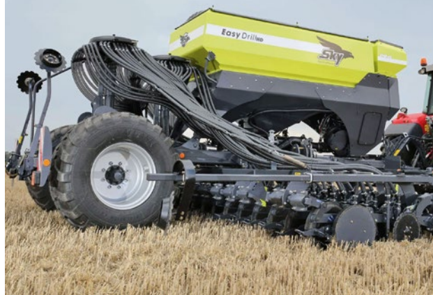
A kétsoros egytárcsás csoroszlyákkal és az elöl haladó tömörítőkerekekkel felszerelt Sulky EasyDrill vetőgép
