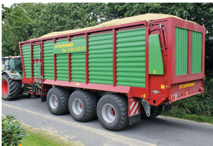
A Tridem kombinációk rakodási térfogata 44 m 3 -tól térfogatnövelő raktérfedéllel 60 m 3 -ig terjed, mint ennél a Giga vontatonál
