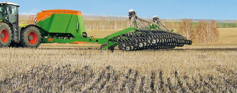
A késes vetőcsoroszlyák megtisztítják a magbarázdát a szalmától és a kövektől, de nem biztosítanak olyan pontos maglehelyezést, mint a tárcsás csoroszlyák
