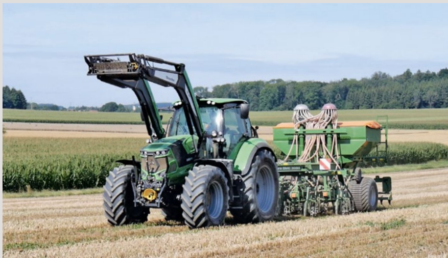
Klaus Keppler 1999 óta alkalmazza a direktvetéses talajművelési módot paralelogramma függesztésű vésőkéses csoroszlyákkal – kezdetben mulcsvetésként, 2012 óta pedig a direktvetés formájában
