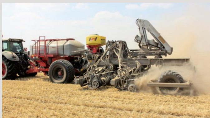
A saját tervezésű direktvetőgép CrossSlot vetőcsoroszlyákkal, az előtte haladó traktor gumiabroncsnyomás-szabályozó rendszerrel van felszerelve
