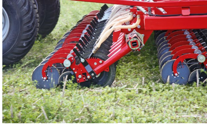
A Horsch Avatar egytárcsás csoroszlyája állítható szögű tömörítőtárcsákkal – választható acélból vagy műanyagból
