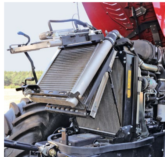
A hűtőpanelek tisztításhoz felhajthatók. A hozzáférhetőség jó
