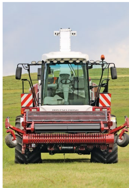
SZÁLLÍTÁS: 650-es kerekkel az RSM F 2650 3,0 m széles, 900-as kerekkel a szállítási szélessége 3,50 m
