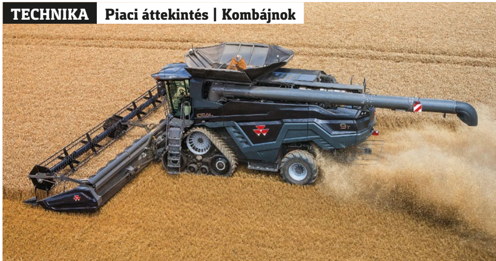
A Fendt és Massey Ferguson Ideal kombájnjai rendelkeznek a piacon a leghosszabb rotorokkal, emellett nagy gabonatartrály-térfogatokat és nagy tartályürítési teljesítményeket kínálnak
