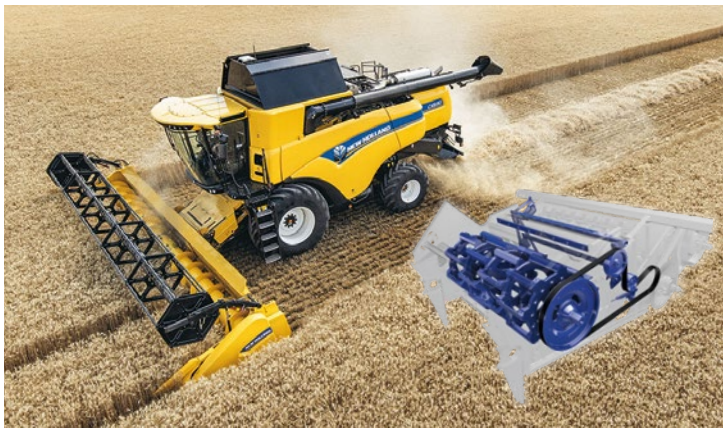
A New Holland a CX szalmarázóládás kombájnjaihoz újabban egy szegmensekből álló cséplődobot kínál
