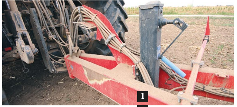
A háromsoros nehéz pálcás borona finom szemcsés földdel takarta a növényi maradványokat, és a keréknyomokban is megmunkálja a talajt
