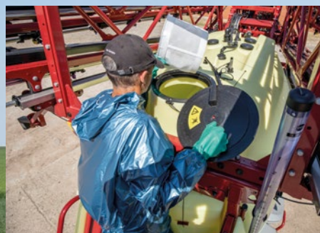
AutoAgitation – automata keverés, a tartály telítettségétől függően
