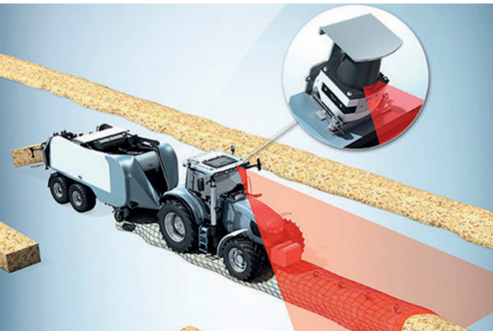
A WGS rendszerhez a 2D-Lidar szükséges: a lézerszkennő felismeri és kiszámítja a rendet, ami azt jelenti, hogy a gépek pontosan hozzá vannak igazítva
