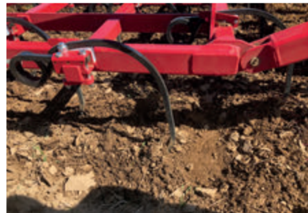
A 150 kg-ra előfeszített kapa teljes átfedéssel mindent kivág
