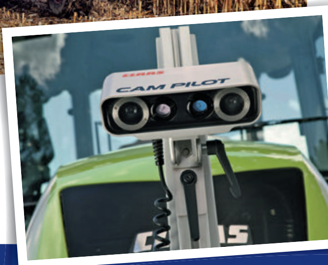
A Claas Cam Pilot kormányzást támogató rendszer sorba vetett kultúráknál vagy bálázáskor
