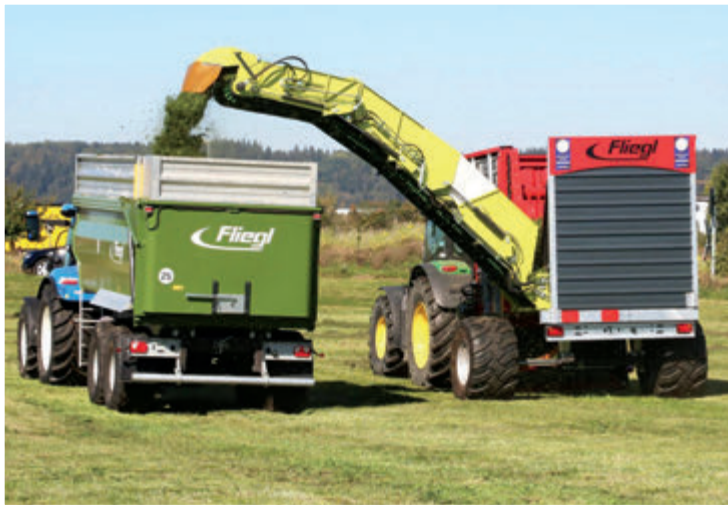
A szállítójárművek silózával való rakodásánál előforduló veszteségeket a szállítóhevederes átrakással minimalizálhatjuk
