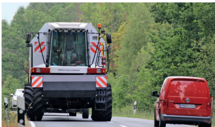
A legkevesebb 3,40 m külső szélesség nagyon sok egy négyszalmarázós kombajn számára – ez még jól kiépített utakon is megnehezíti a közúti szállítást
