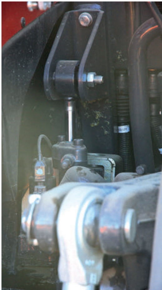
A félig aktív vezetőfülke-rugózás három különböző keménységi fokozatba állítható
