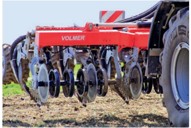
A lazítófogak és a hígtrágya-kijuttató cső előtt vágótárcsák és csillag alakú tisztogatótárcsák működnek
