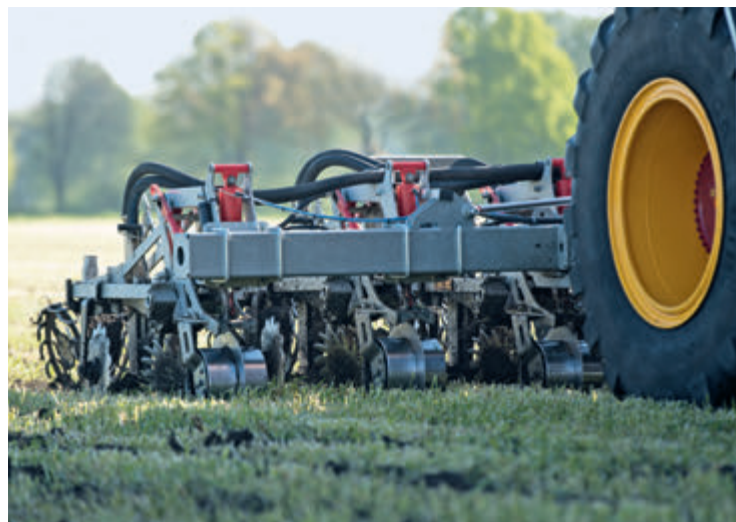
Az egyes sorok szorítóelemei lehetővé teszik az áthelyezést, így különféle sorközök hozhatók létre
