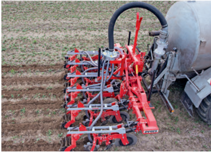
Az egyes sorokat paralelogrammák segítségével függesztik a kerettartóra
