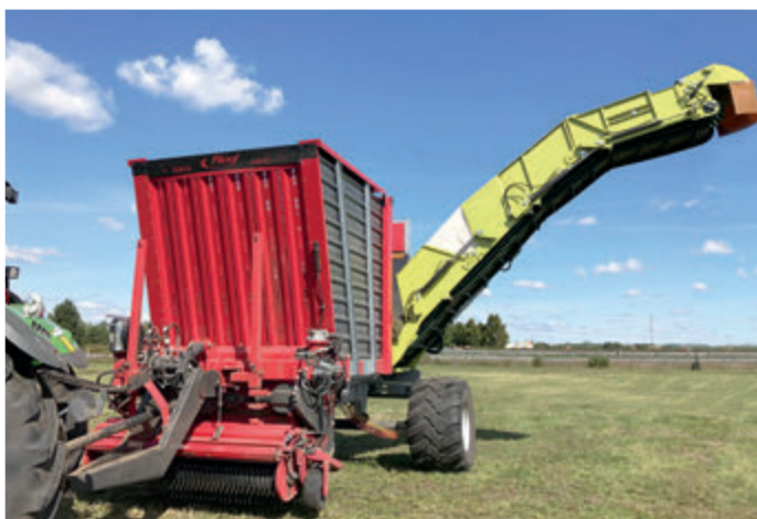
A gyűjtőtartály befogadókapasitása 10 m 3 , a rakfelületén láncos-kaparóléces szállítórendszer továbbítja hátrafelé a terményt
