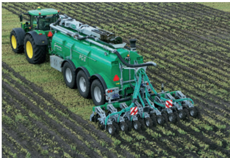
A 6 m széles sávos talajművelők legfeljebb 8 szerszámmal vannak felszerelve a kukorica tavaszi vetéséhez
