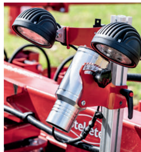
A soros kultúrák és a gabonafélék mechanikus gyomszabályozásánál a képkalkító érzékelők átvehetik a csúszókeret irányítását
