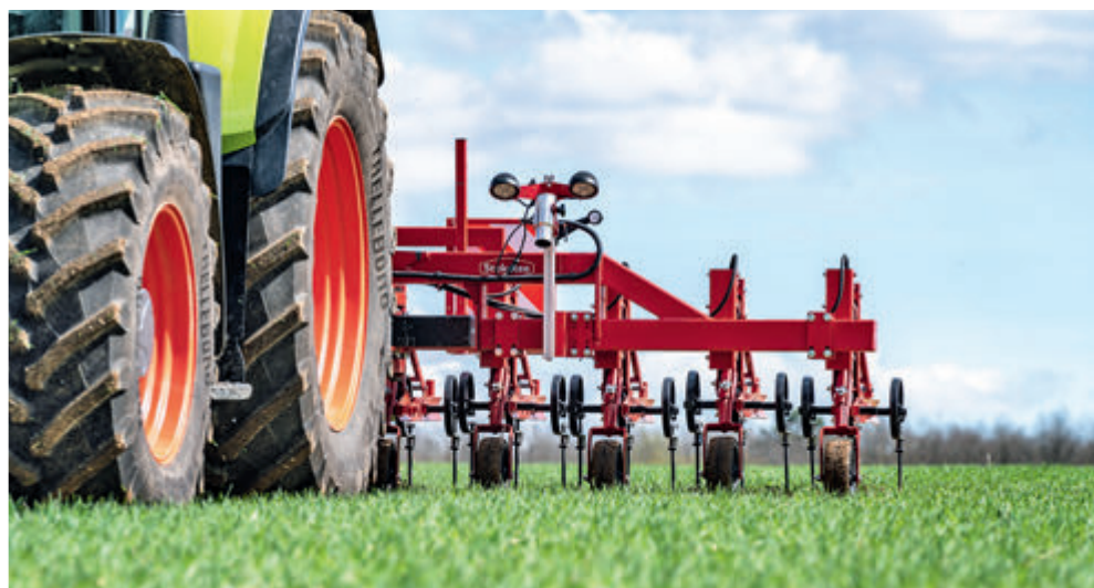
A soros kultúrák és a gabonafélék mechanikus gyomszabályozásánál a képkalkító érzékelők átvehetik a csúszókeret irányítását
