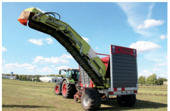
Munkahelyzetben, a megváltozott súlypont megtámasztása érdekében, a teleszkópos keréktengely kitolható az oldalra hordó szalag irányába
