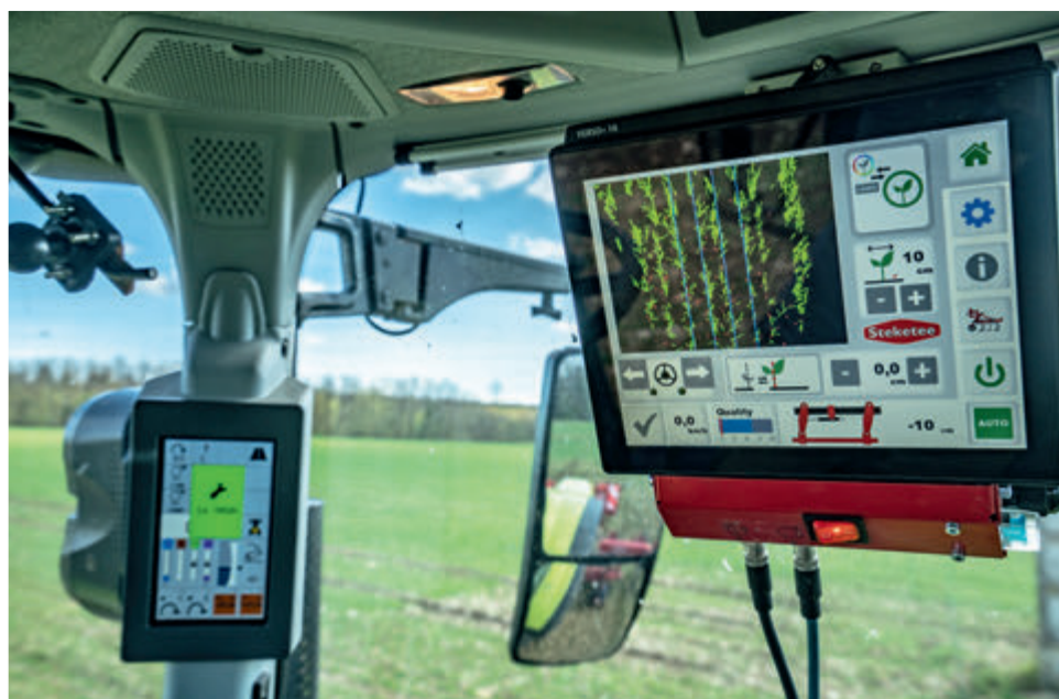
A terminálon a vezető folyamatos grafikus képet kap a szenzor pontosságáról
