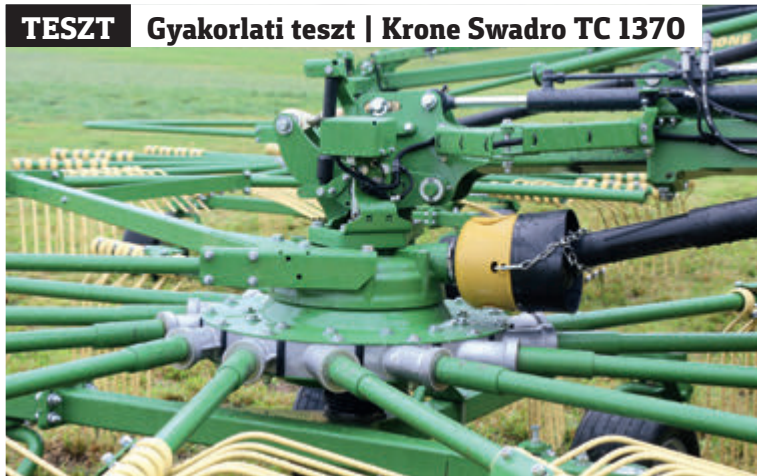
A Krone mérnökei átvették a rotorok húzott kardánfüggesztését a meglévő programból
