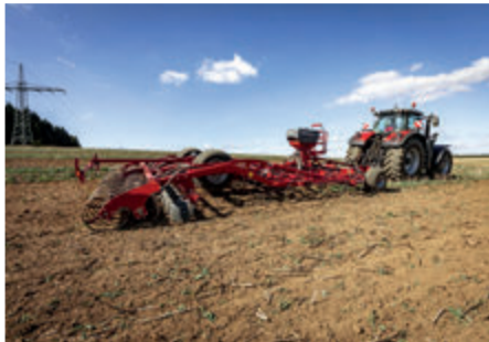
Dupla RingFlex hengerrel és MiniDrill aprómagvetővel szerelve
