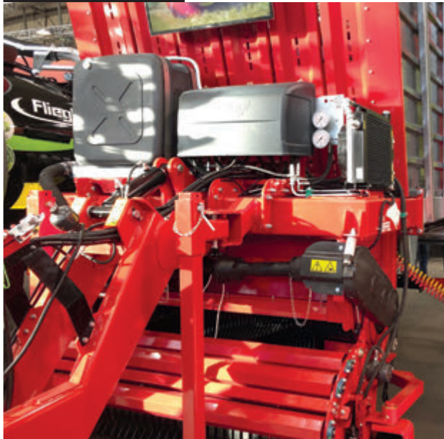
Saját hidraulikus rendszerrel is rendelkezik, amely az oldalra kihordó átrakószalagot és adagológörgőket meghajtó hidromotorokat látja el olajárammal
