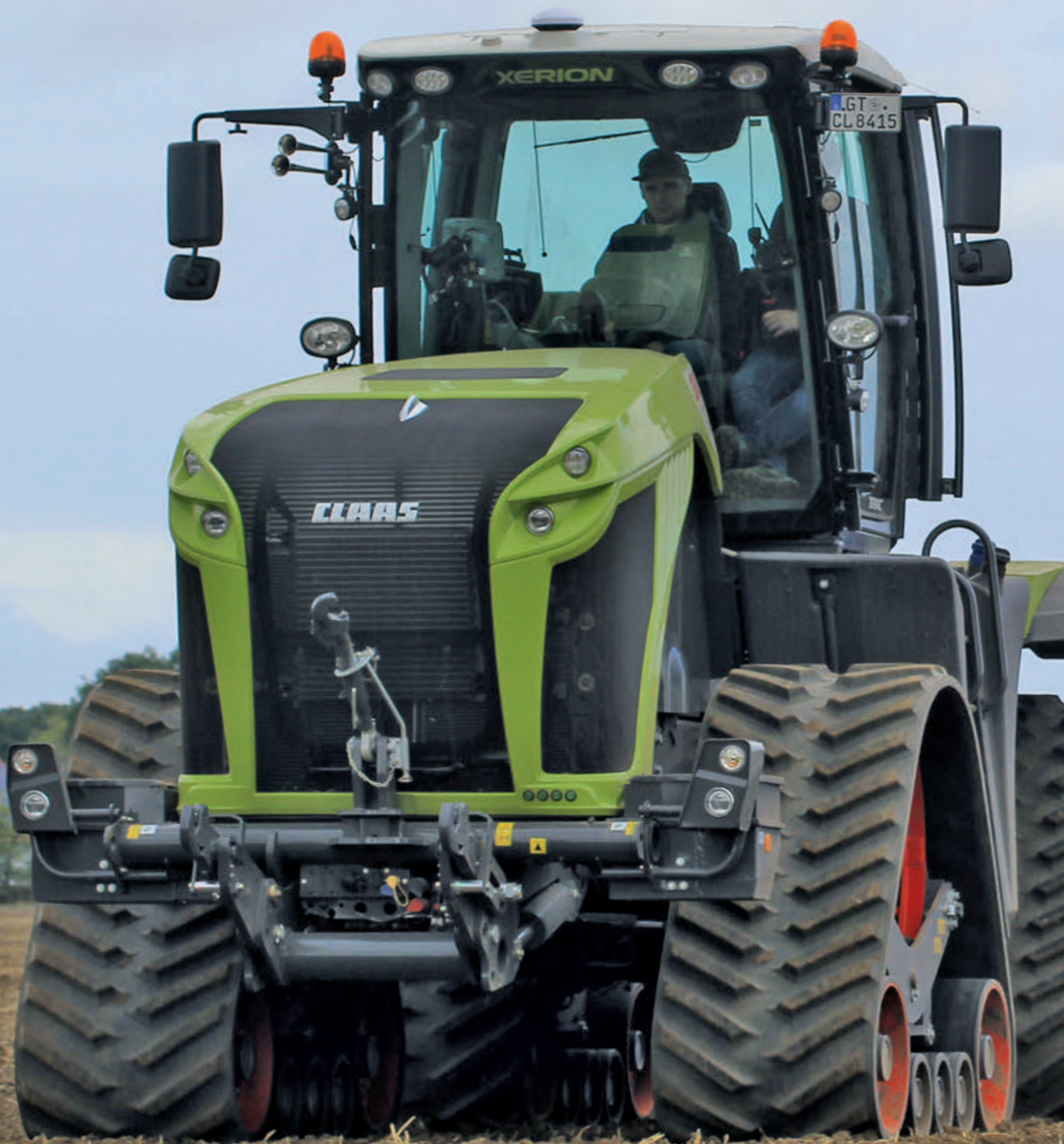
GUMIHEVEDER: A Claas a Xerion vontatót négy háromszög alakú gumihevederes járószerkezettel látta el, és Trac TS néven találhatjuk meg a listában
