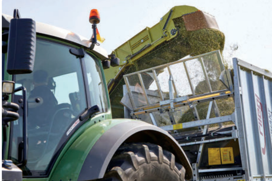
A Fliegl Tracker segítségével a Büffel képes minden megfelelő jeladóval ellátott szállítójárművet pontosan azonosítani, felismerni, és ennek megfelelően a helyes átrakópozíciót kiválasztani
