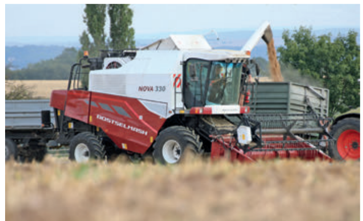
A magtartály 50 l/sec sebességgel kb. 1,5 perc alatt ürül ki – ez megfelelő szintű ebben a kategóriában. A 4,0 m ürítési magasság jó
