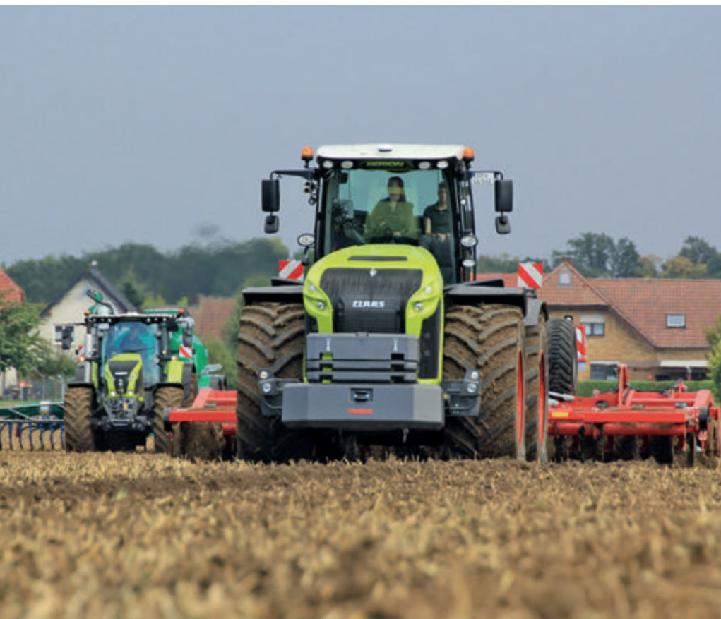
A 462 LE maximális teljesítményű Xerion 4200 új a Xerion termékcsaládban. A régi Xerion 4000 modellt váltja fel, amely kicsit gyenge volt, főleg nyergesvonatoként, Saddle Trac változatban
