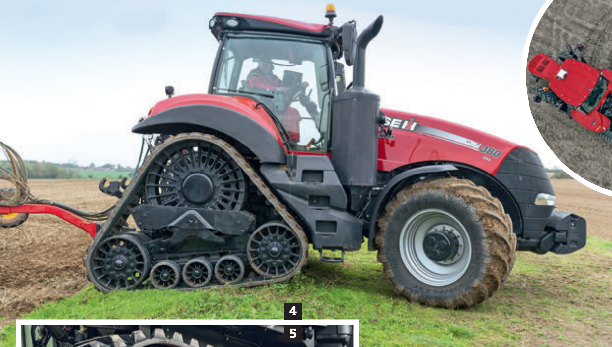
A kanyar belső ívén futó heveder aktív fékezése csökkenti a fordulási sugarat
