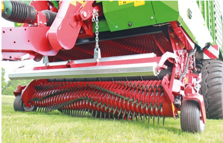
A MagnonCFS esetében a Strautmann 2020-tól új utakon jár a műanyag ujjakkal ellátott rendfelszedő adapterrel
