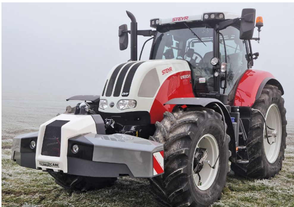
A traktor és a pótkocsi gumiabroncsa 30 másodpercen belül felpumpálható az első tároló segítségével. A rendszer a Terra Care cégtől származik
