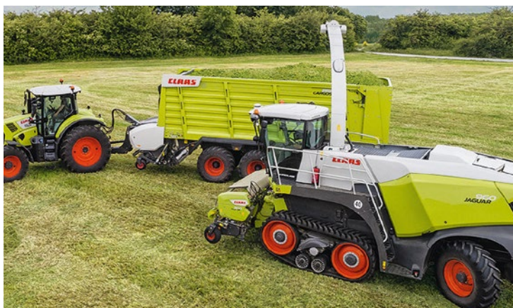
Versenytársak helyett partnerek: a levehető rendfelszedő egységnek és az adagolóhengereknek köszönhetően a Cargos a szecskázási láncban is keresett
