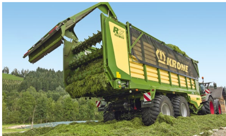
Egy harmadik adagolóhenger használata különösen a nagy kaparószalag-sebességgel rendelkező márkák esetében javasolt, és gyakran opcionálisan kapható
