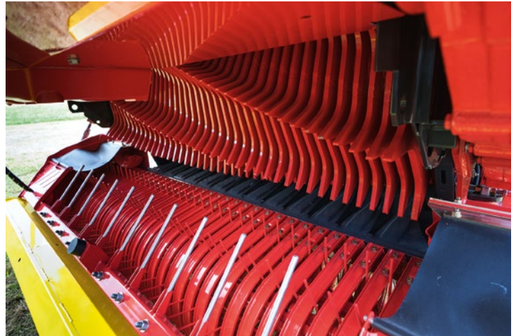
A Pöttinger a vezérelt, lengő adaptereket használja, ahogy ez például itt a Jumbo Combiline 7220 esetében látható
