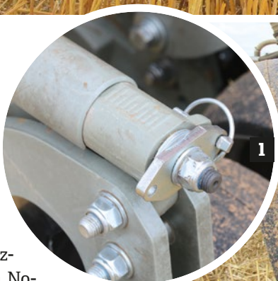
Az egyes csoroszlyasorokat nagy és erős paralelogramma rendszerrel erősítik a kerethez
