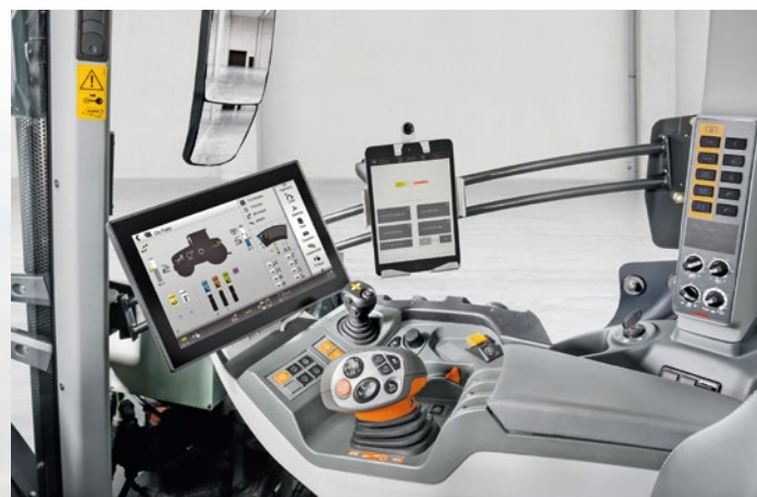
A nyomásvezérlés például megvalósítható App-vezérléssel. Különböző alkalmazásokhoz is megadhatók profilok
