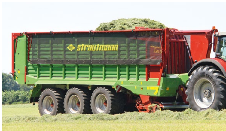
A mozgatható homlokfalak, pl. a MagnonCFS esetében egyrészt nagyobb tömörítést, másrészt nagyobb rakodási térfogatot biztosítanak
