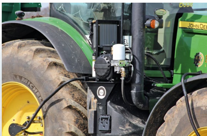
A traktorra fixen beépített kompresszorok a járművön a guminyomás gyors megváltoztatását teszik lehetővé. A fronthidraulika szabadon marad
