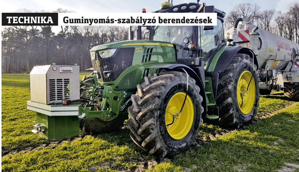
A fronthidraulikára rögzítve a drága kompresszor szükség esetén más traktorokra is felszerelhető és használható
