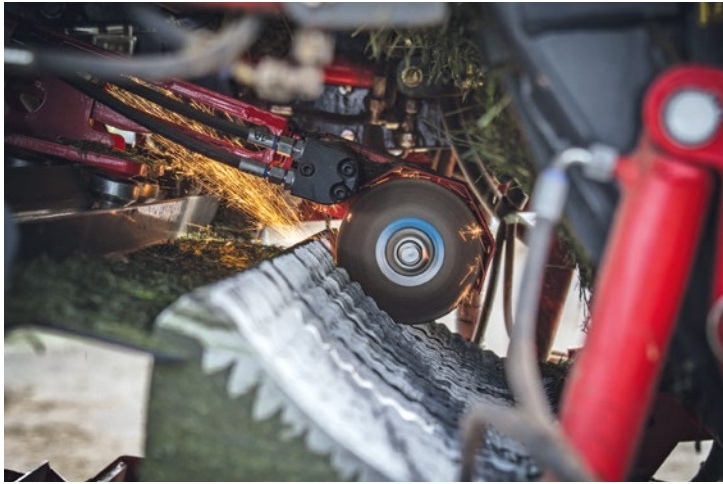
Automata rendszerek végzik a déli és esti késélezést. Számos gyártó kínálja ezeket a megoldásokat
