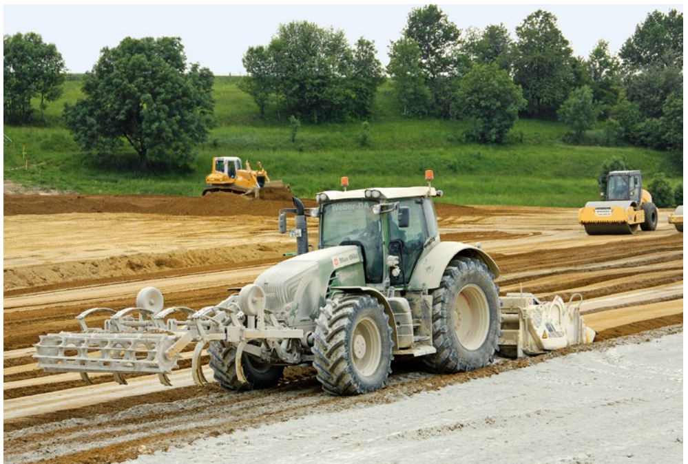
Az előre szerelt kultivátor hátrafelé húzza ki a köveket a talajból. A talajmarógép összetöri őket
