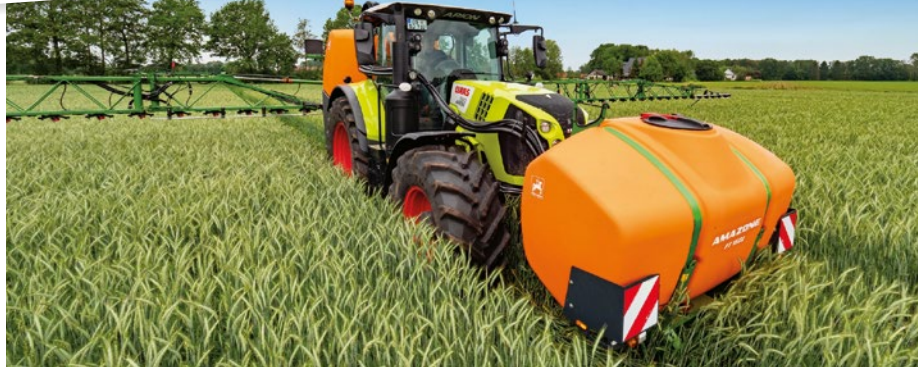
Az Amazone FT 1502 fronttartállyal az UF 2002 térfogata 3500 literre növelhető
