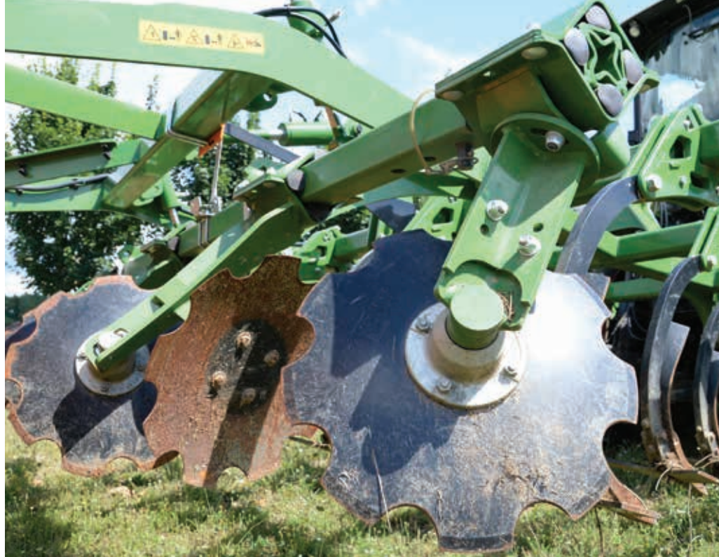
A 600 mm átmérőjű tárcsát gondozásmentes csapágyazással látta el az AMAZONE
