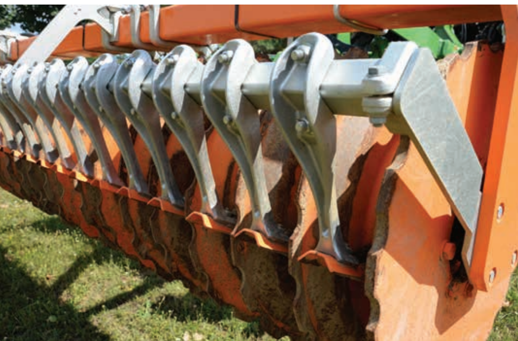
A sárkaparóknak köszönhetően a DW-henger akkor sem tömődik el, ha pocsolyába húzzuk a nehéz-kultivátort
