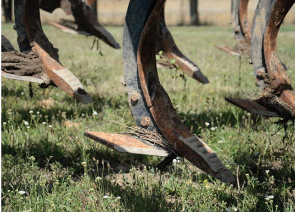
A nagy kopásállóságú és hosszú élettartamú HD kapák hossza a teljes használati idő alatt állandó, így nincs szükség a munkamélység utána állítására
