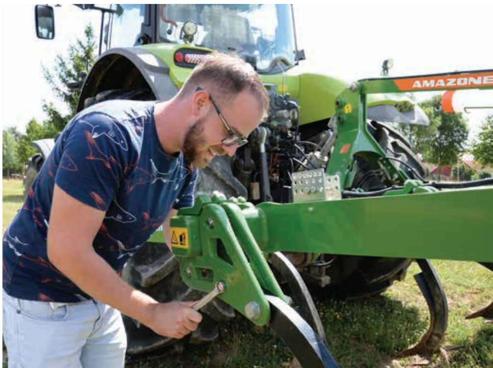
A nyírócsavar rövid idő alatt cserélhető
