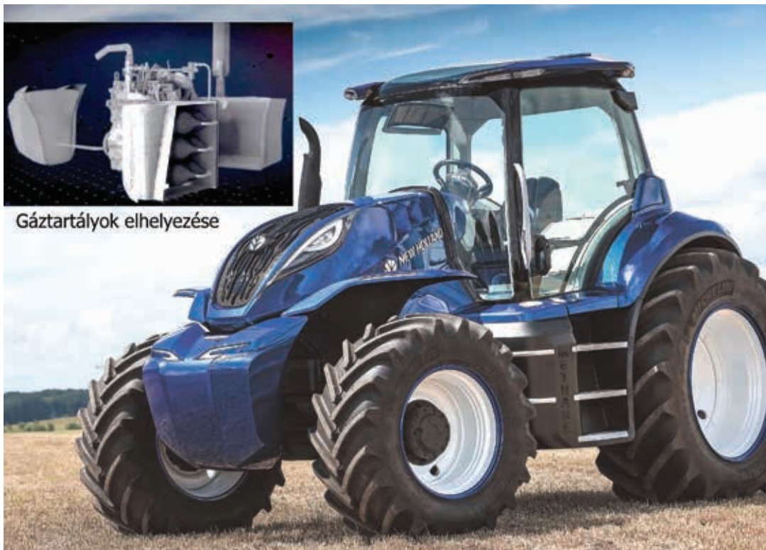
5 New Holland Methane Power univerzális földgázüzemű traktor (forrás: https://tractoroftheyear.org )
